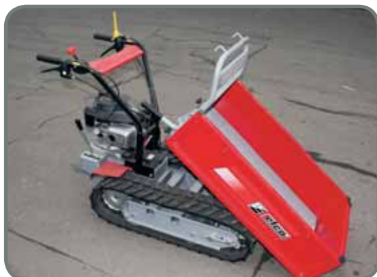
Транспортер с поднятым кузовом. Крайне полезная особенность при перевозке сыпучих грузов
