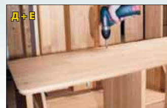
Д + Е Основание, к нему стойки крепятся саморезами
