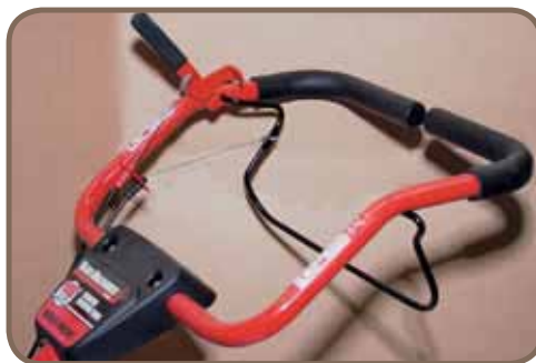
Управление машиной вынесено на эргономичный руль
