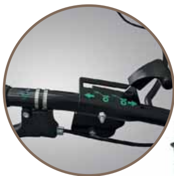
Помимо одной передней передачи, у культиватора предусмотрен реверсивный ход
