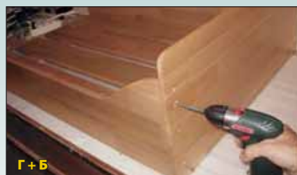
Г + Б Столешница, стойки к ней крепятся саморезами снизу
