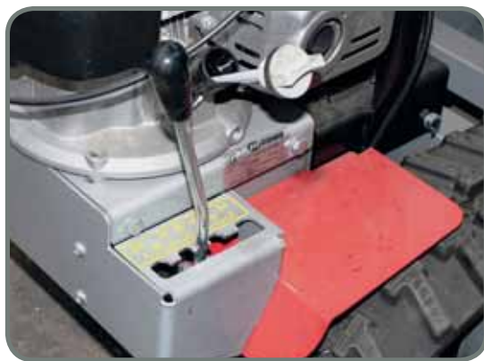
Рукоятка выбора передач (две передние, нейтральная, две задние) и маслозаливная горловина с щупом
