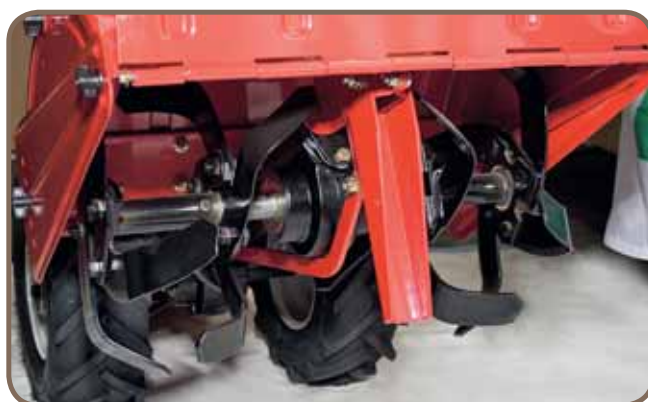
Машину комплектуют четырьмя секциями стальных фрез, позволяющими обрабатывать полосу почвы шириной до 45 см
