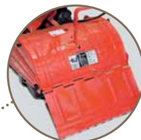
Кожух позволяет избежать разбрасывания культивируемой почвы. При помощи ограничителя глубины выбирают необходимые параметры обработки
