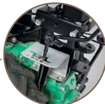
Коробка передач позволяет выбрать из трех передних скоростей и двух задних. Наличие реверсивного хода повышает маневренность машины и облегчает работу в труднодоступных местах
