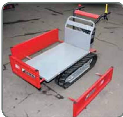
Для перевозки габаритных грузов борта можно раздвинуть или вообще снять
