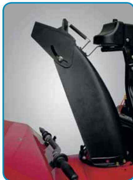
При помощи джойстика изменяют направление (поворотом дефлектора) и дальность (наклоном козырька) выброса снега
