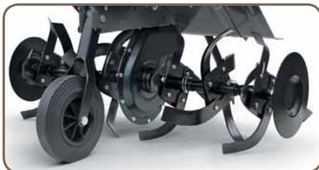
Культиватор укомплектован шестью секциями фрез. Разборная конструкция редуктора позволяет проводить его обслуживание, например менять смазку, а также при необходимости заменять отдельные узлы, что в ряде случаев приводит к снижению стоимости ремонта (по сравнению с заменой редуктора целиком)
