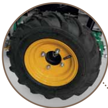
В стандартной комплектации на машине установлены пневматические колеса, предназначенные для сельскохозяйственных работ
