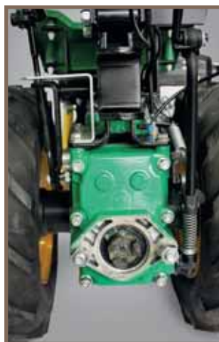
Усиленный вал отбора мощности позволяет использовать с мотоблоком различное навесное оборудование
