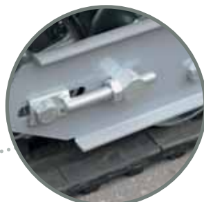
Натяжной механизм гусениц. Одинаковые регулировочные болты установлены с обеих сторон каждого катка
