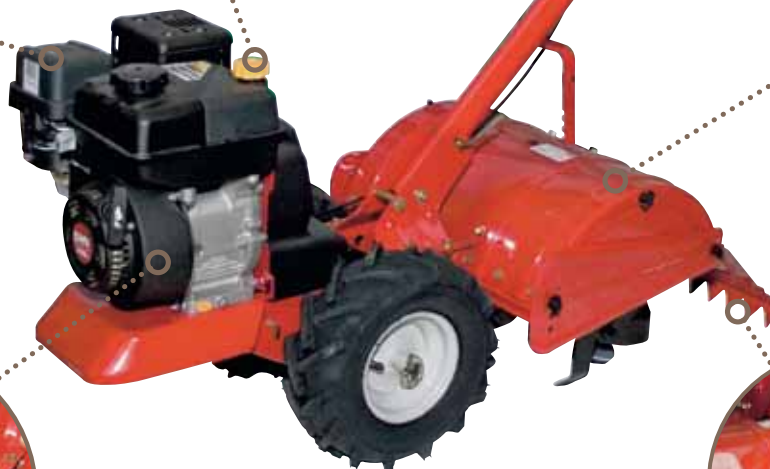
Культиватор оборудован фирменным двигателем MTD ThorX OHV, рассчитанным на долгую и эффективную работу
