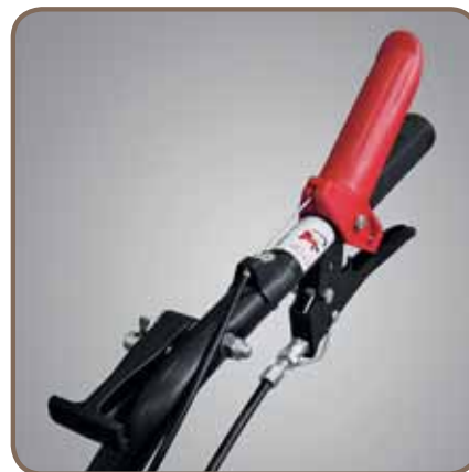
Управление ходом мотоблока традиционно вынесено на рукоятку
