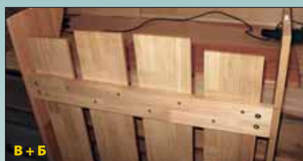
В + Б Вешалка в сборе, крепится эксцентриковыми стяжками к стойкам
