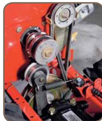
Система ременной передачи доступна для обслуживания
