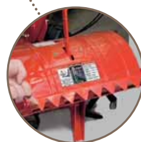
Зубчатый задний щиток разравнивает вспаханную землю
