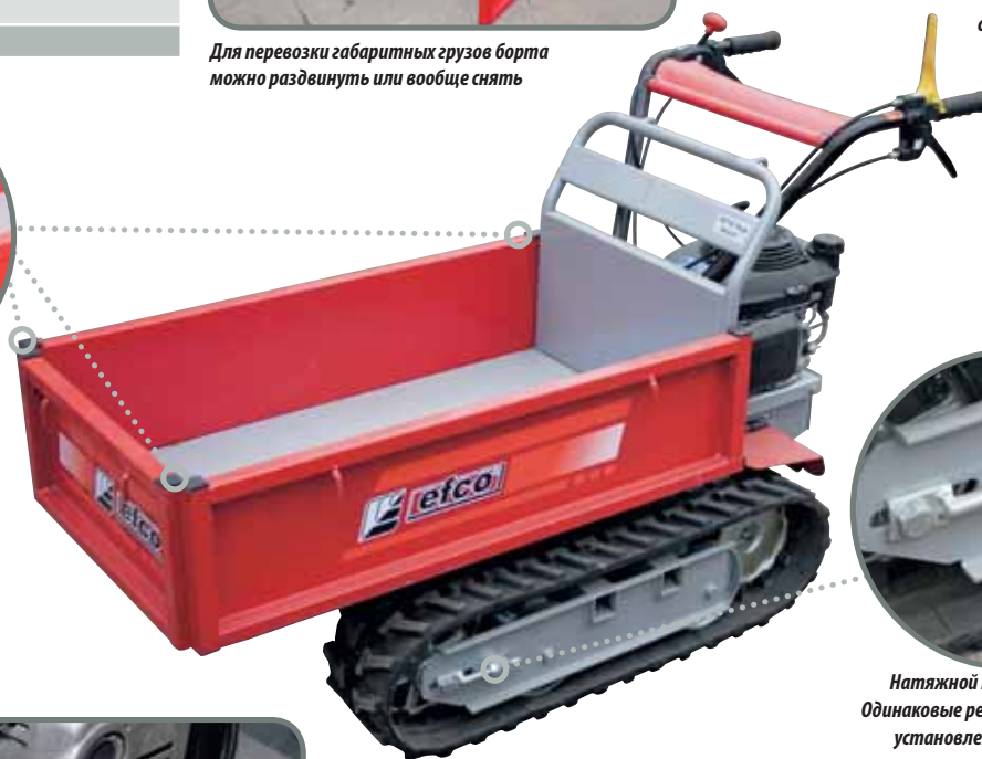
Отверстия для установки дополнительных дуг закрыты заглушками
