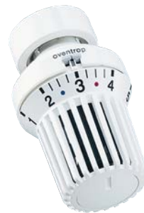
Термоголовка Oventrop Uni HN с жидкостным чувствительным элементом, с диапазоном настройки 7–28 °С, защитой от замерзания и нулевой отметкой
