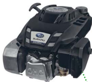
Двигатель Robin-Subaru EA 190V, первый на рынке «газонокосилочный» мотор с чугунной гильзой цилиндра, верхним расположением распределителя и цепным приводом, мощностью 4,1 кВт (5,6 л.с.) при 3600 об/мин
