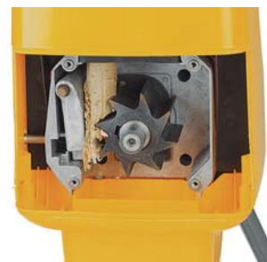
Режущий механизм может быть устроен по-разному: диск с ножами (слева) и шестерня (справа)...
