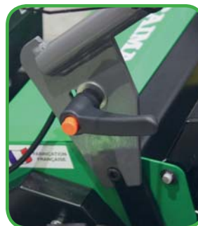
Рукоятку управления у этой модели можно установить в одно из двух положений по высоте. Ручки со встроенными фиксаторами обеспечивают возможность быстрой регулировки. Если потребуется, рукоятку можно сложить целиком
