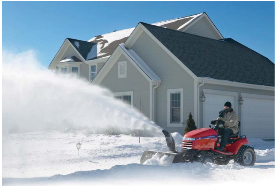
Наличие на некоторых садовых тракторах вала отбора мощности тоже позволяет применять активную «навеску». Такую, как шнекороторный снегоотбрасыватель, благодаря чему машина становится фактически всепогодной
