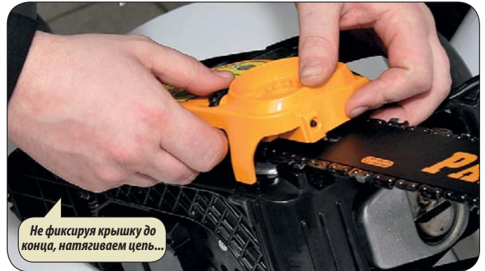
В идеале цепь должна быть натянута так, чтобы, если приподнимаешь пилу, взявшись за цепь, зазор между хвостовиками зубьев и внешним краем шины был минимальным. Здесь он (зазор) чуть великоват, но для работы в принципе вполне подходит
