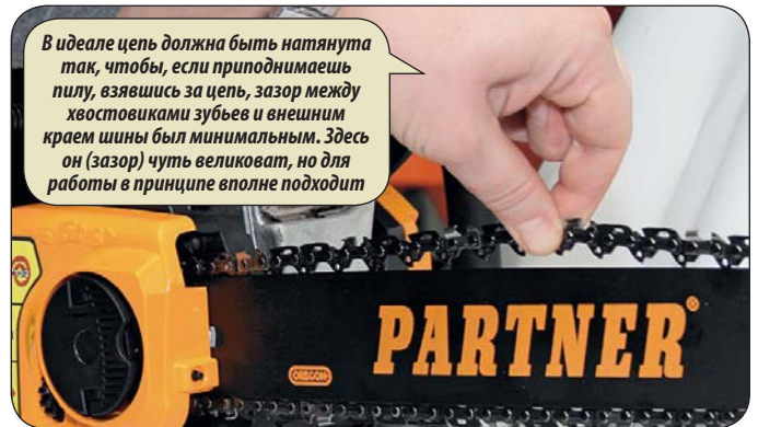
Не фиксируя крышку до конца, натягиваем цепь...
