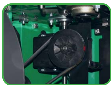
Привод косилки на задние колёса осуществляется с помощью ременной передачи
