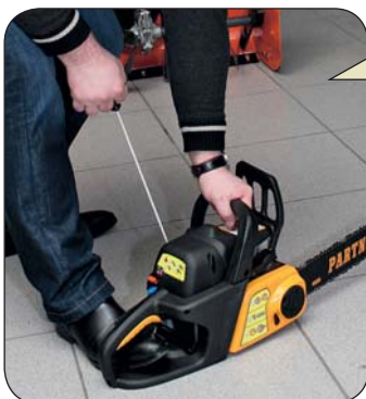
Установив цепь на место, следует заправить баки топливной смесью и маслом, после чего можно приступать к запуску двигателя
