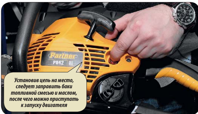
Есть несколько способов завести двигатель. Настоящие профессионалы умеют делать это «с рук». А вот новичкам можно рекомендовать только один вариант — тот, что на фото. Итак: пила на земле, правой ногой наступаем на заднюю рукоятку, левой рукой придерживаем пилу за переднюю ручку, а правой держим шнур стартера, предварительно обязательно выбрав слабинку. Не забудьте включить зажигание... хотя на многих пилах оно включено постоянно
