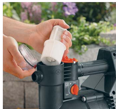
Механический фильтр грубой очистки на входе — устройство необходимое. Некоторые автоматические насосные станции укомплектованы таким изначально. Но его легко купить отдельно и установить самостоятельно
