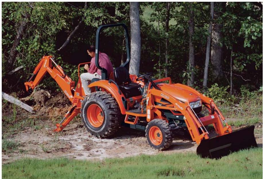
Самые многофункциональные из мини-тракторов оборудованы собственной бортовой гидросистемой, которая ещё больше расширяет спектр их возможностей по сравнению с ВОМ. Такие машины могут служить экскаваторами, погрузчиками разных видов и т.д.
