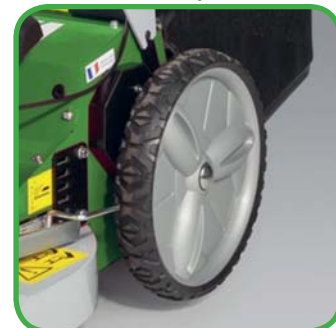
Большие задние колёса облегчают перемещение по пересечённой местности. Рядом с задним правым колесом находится рукоятка регулятора высоты кошения и её фиксатор — стальная пластина с шестью отверстиями
