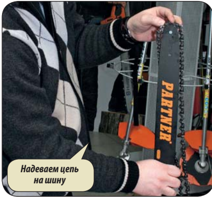
Ставим шину с цепью на место. Шину сажаем на шпильки, цепь — на ведущую звёздочку. Поставив шину и цепь на место, слегка протягиваем цепь вдоль шины, чтобы хвостовики зубьев глубже сели на ведущую звёздочку
