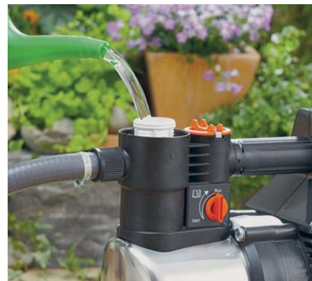
Чтобы центробежный насос заработал, его необходимо предварительно заполнить водой
