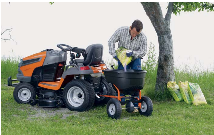
Прицепной разбрасыватель семян. Может использоваться также для обработки дорожек песком или противогололёдными реагентами
