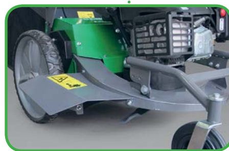
Для обкашивания высокой травы используется кардинальное решение — кожух деки снимается и устанавливается дефлектор бокового выброса
