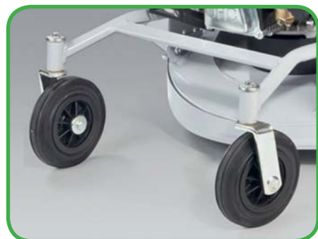
Свободно поворачивающиеся передние «рояльные» колёса легко выдерживают заданное направление при прямолинейном движении и способствуют лёгкому маневрированию. Косилки и садовые райдеры с такими колёсами имеют нулевой радиус разворота. Такая схема позволяет газонокосилке не заваливаться во время работы на склоне
