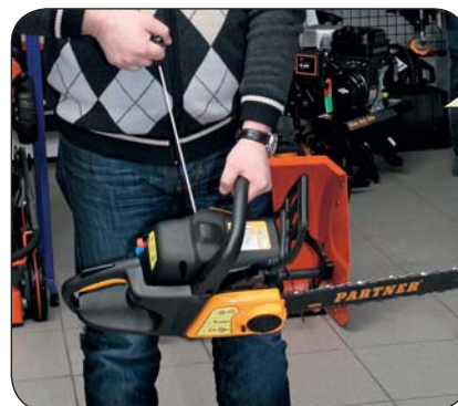
Если двигатель холодный (а при первом запуске он всегда считается холодным, даже в 35-градусную жару) — закрываем воздушную заслонку
