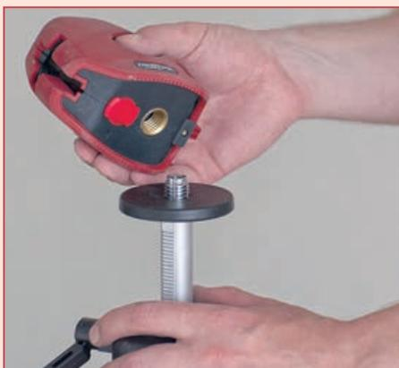
Резьбовое гнездо  $\frac{5}{8}$ " позволяет устанавливать нивелир на геодезическом штативе...
