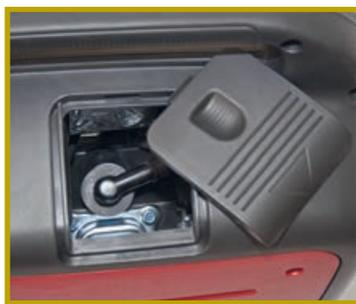
Сервисная крышка, закрывающая доступ к свече зажигания, — единственная, которую можно открыть без помощи инструмента. К остальной «начинке» свободный доступ не требуется
