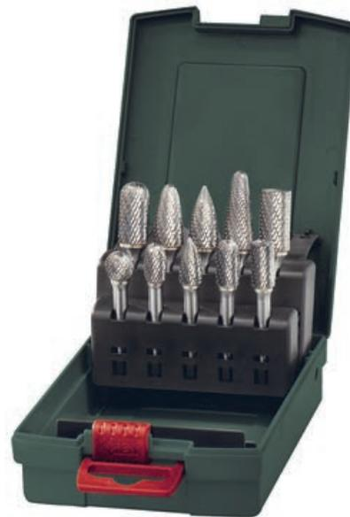
Новые твёрдосплавные высококачественные фрезы подходят для обработки практически всех металлов — от латуни и меди до нержавеющей стали. Режущая часть легирована 6% кобальта и соединена со штифтом из закалённой стали с помощью индукционной пайки.
