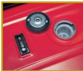
Топливный бак с поплавковым указателем уровня и предварительным фильтром — вставным сетчатым «стаканчиком»
