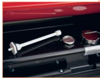
Снятый топливозаборник с фильтром. Бак снабжён указателем уровня топлива (градуйровка в часах оставшейся работы). Крышка топливного бака — со страховочной цепочкой
