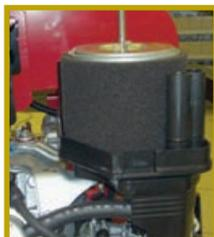
Воздушный фильтр двигателя — с предварительным поролюновым фильтрующим элементом. Глушитель снабжён сеткой-искрогасителем
