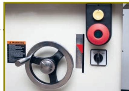
Высота шпинделя регулируется с помощью маховика. Шкала высоты размечена в миллиметрах и дюймах. Справа расположены переключатель направления вращения фрезы, нажимные кнопки выключения/включения (красное кольцо и зелёная кнопка в его центре) и жёлтый съёмный магнитный ключ защиты от несанкционированного запуска
