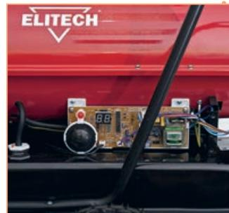
Боковая крышка снята. Видна плата управления с плавким предохранителем 5 А и топливозаборник со шлангом
