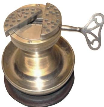
Станина тисков снизу имеет вид полушария, которым она опирается на кольцеобразную кожаную подушку. «Шейка» обеспечивает рукам мастера комфортную высоту. Особенность этих тисков в том, что ходовой винт имеет две резьбы (правую и левую). Он закреплён в станине обеими концами так, что при вращении не смещается по оси, при этом нижние части губок передвигаются каждая по своей резьбе так, что
