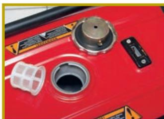
Топливный бак снабжён указателем уровня топлива и съёмным сетчатым фильтром
