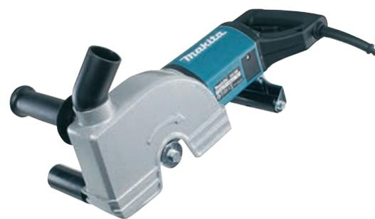
Металлический защитный кожух прикрывает от возникающей бетонной пыли. Для подключения пылесоса от кожуха отходит патрубок. В нижней части кожуха подсоединён направляющий ролик, обеспечивающий устойчивость во время эксплуатации. Основная рукоятка выполнена D-образной, т.е. закрытого типа.
