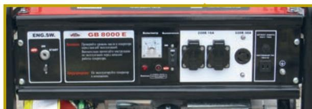
Контрольная панель: замок зажигания с предохранителем цепи, вольтметр, автомат защиты, две обычные и силовая розетки 220 В, розетка 12 В, контрольные лампы включения, низкого уровня масла и клемма заземления
