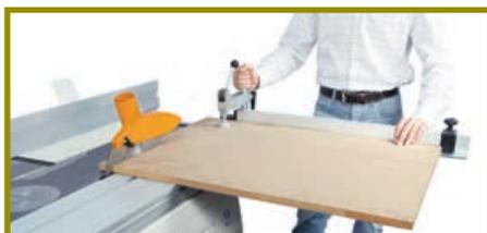
*На станке может проводиться пиление как сравнительно небольших заготовок (слева), так и габаритных листовых материалов (справа) с использованием откидного стола и направляющей. Вылет и угол наклона пильного диска регулируются с помощью маховиков, возможно и пиление заготовок под углом*
