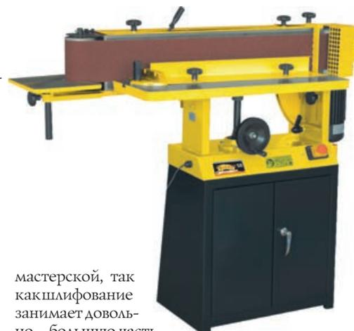
мастерской, так как шлифование занимает довольно большую часть рабочего времени. Применение в данном устройстве длинной ленты и асинхронного двигателя существенно облегчает труд, по сравнению с работой вручную или с использованием электроинструмента.
