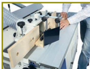
*Продольное профильное фрезерование. Защитное ограждение фрезы одновременно играет роль направляющей*
