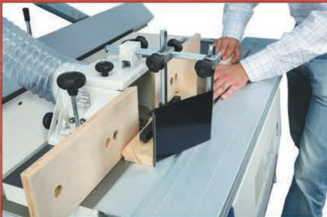
Фрезерный узел с двумя скоростями (5000-7500 об/мин) для достижения максимально возможной гибкости в использовании инструмента. Станки оснащены кожухом фрезерного шпинделя, который регулируется с микрометрической точностью и удобен для профилирования.
