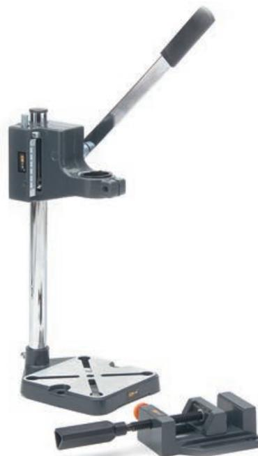
Вертикальная стойка для электродрелей — приспособление простое, но полезное. Благодаря диаметру зажимного отверстия 43 мм она подходит к большинству электродрелей. Стойка пригодится, когда необходимо просверлить серию одинаковых отверстий в той или иной заготовке. Дрель в этом случае не придётся держать в руках — она будет закреплена в стойке, а работать можно только рычагом. Выгода очевидная — сразу увеличивается производительность. При этом и оператор устанет значительно меньше.
