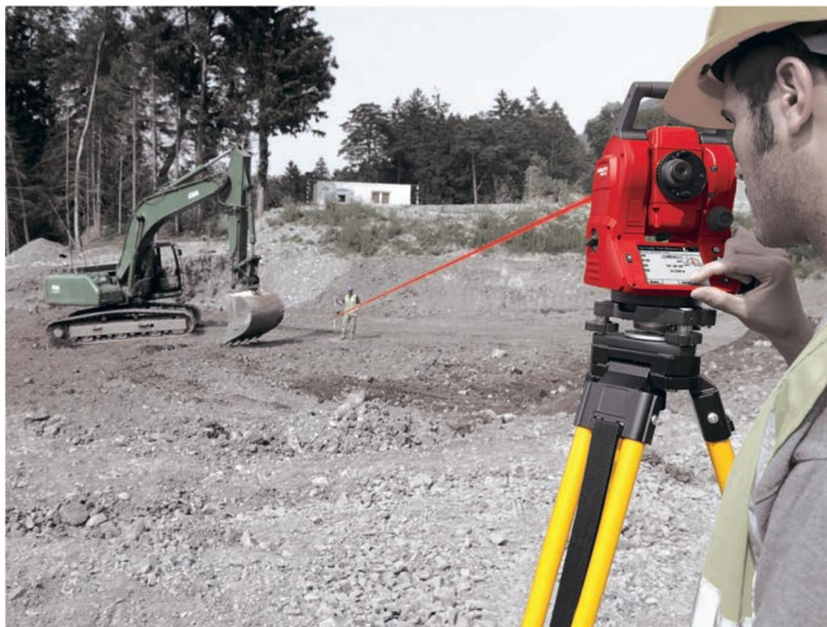
Hilti POS 15 и POS 18 — современные электронные тахеометры, разработанные специально для использования на всех стадиях строительства, начиная с разбивочных работ и до исполнительной съёмки. Эти две модели различаются только точностью угловых измерений, в остальном приборы идентичны. Их особенностью является высококонтрастный цветной сенсорный дисплей, позволяющий в одно касание вызывать множество заранее запрограм-
