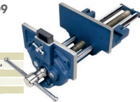
Эти тиски в принципе похожи на классические, но оборудованы быстроразъёмным механизмом в виде рычажка под ходовым винтом. При нажатии на него ходовая гайка губки размыкается и подвижная губка свободно передвигается.
