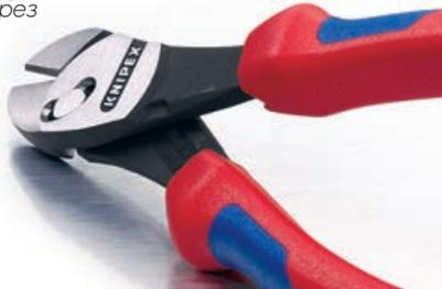
Бокорез снабжён запатентованным двойным шарниром. За счёт этой конструкции, как и за счёт точно фрезерованных поверхностей, инструмент достигает высокого уровня передачи усилия, а это в итоге приводит к заметной экономии сил пользователя во время эксплуатации. Особенно ощутима экономия сил (по данным производителя — вдвое) при больших объёмах работы — волочение проволоки или серийное производство.
