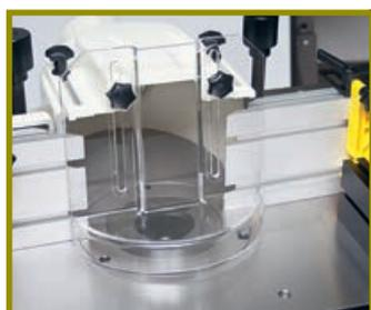
При работе с концевыми фрезами зона фрезерования закрывается прозрачным защитным кожухом
