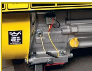
Датчик уровня масла устанавливается практически на всех двигателях и служит для защиты мотора: при низком уровне двигатель просто не запустится. Для проверки уровня пробка заливной горловины снабжена щупом
