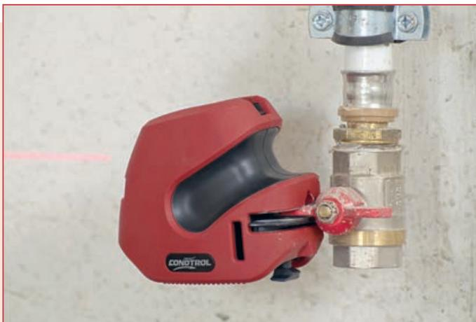
Нивелиры отличаются друг от друга способом установки: чем они разнообразнее, тем проще эксплуатировать прибор в различных ситуациях. На фото — пример монтажа на вентиль шарового крана с помощью встраиваемого зажима, это редкая особенность
