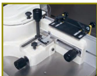
Вертикальный упор — составной, его половина, на которую опирается отфрезерованная часть заготовки, может быть выдвинута вперёд, к оператору
