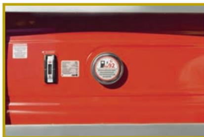
Топливный бак с поплавковым указателем уровня топлива. Небольшая выштамповка на баке служит для отвода случайно пролитого топлива
