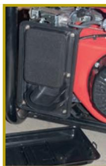
Поролонный фильтрующий элемент. Поступающий к нему воздух сначала проходит по лабиринтному каналу в нижней части корпуса, где задерживаются крупные частицы пыли
