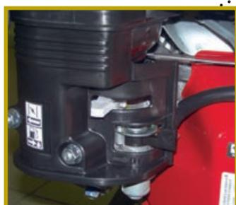
Все органы управления, относящиеся к запуску, скомпонованы с одной стороны двигателя: слева находится рычаг воздушной заслонки и топливный кран, а справа — блок с замком зажигания и кнопкой-предохранителем
