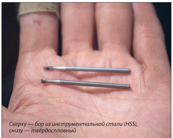
Сверху — бор из инструментальной стали (HSS), снизу — твёрдосплавный
