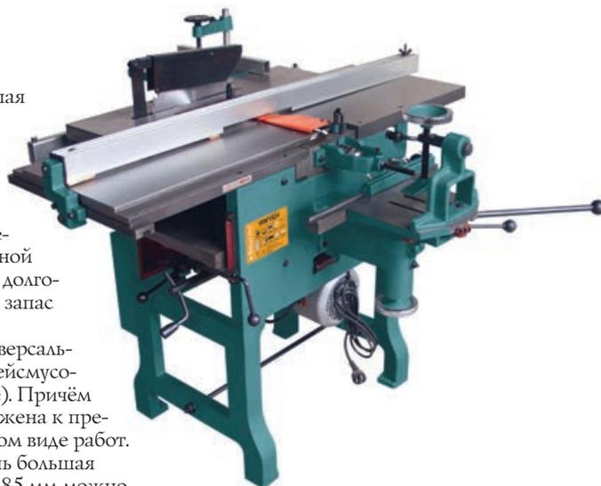
новаться, что вес длинной заготовки его опрокинет), и столярам (чугунная станина обеспечивает не только прочность, но и точность). Цена WM1924 сравнима с ценой набора из трёх станков, которые он в большой степени заменяет.
