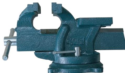
Слесарные тиски с наковальной и сменными стальными губками. Это классическая конструкция, которая достаточно хороша для всех применений. Она привычная и удобная.
