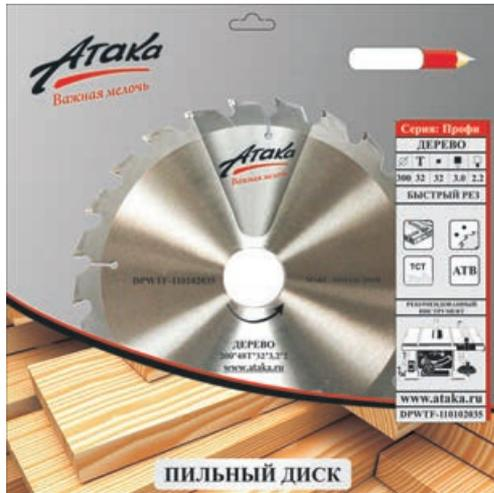
Новый твёрдосплавный диск марки «Атака» предназначен для работ с мягкой и твёрдой древесиной и их производными. Он подходит для распиловки прессованных плит, ламинированной древесины, фанеры и мебельных плит. Диск рассчитан на использование ручными циркулярными пилами. Внешний диаметр — 200 мм, посадочный — 30 мм, ширина пропила — 2 мм.
