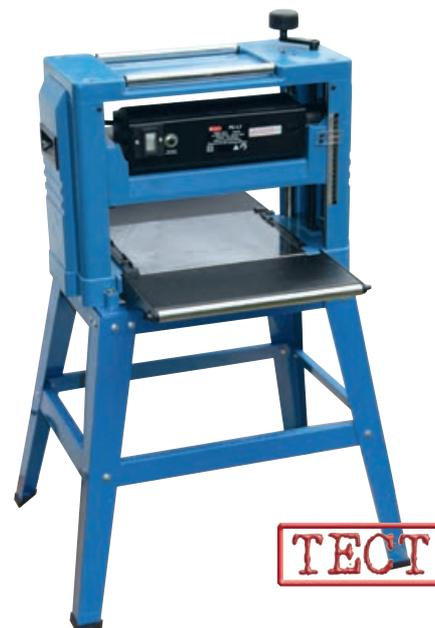
рейсмусовании тонких материалов и досок высоты подставки маловато — приходится наклоняться, чтобы завести заготовку или считать на указателе установленную высоту обработки. Впрочем, подобрать подходящий по высоте стол или верстак не проблема. Что касается работы — претензий нет. Качество обработки хорошее, звук негромкий, лишних шумов нет, механизм подачи работает плавно, без заеданий.
