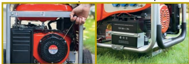
Генератор оборудован электрическим запуском от аккумуляторной батареи, а также традиционным ручным стартером «про запас»
