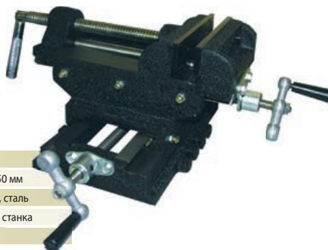
Подобные приспособления довольно сложны по своему устройству. Их станина состоит из трёх частей с направляющими «ласточкин хвост» и ходовыми винтами, с помощью которых сами тиски могут передвигаться по двум осям.
