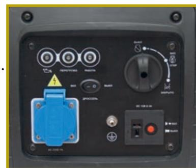
Лицевая панель с розетками 230 и 12 В, шпилькой заземления, индикаторами низкого уровня масла, перегрузки и включения, клавишей выбора режима работы и многофункциональным переключателем, управляющим включением/выключением двигателя, положением воздушной заслонки и топливным краном
