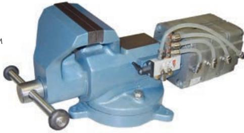
Пневмоцилиндр ускоряет зажим деталей и обеспечивает постоянную силу зажима в 1000 кг при давлении воздуха 6 атмосфер. Постоянное усилие крепления не только облегчает работу слесаря, но и предотвращает брак из-за недожатия детали (она может провернуться) или её деформации тисками.
