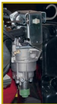
Отстойник для грязи и конденсата есть и на самом карбюраторе, внизу
