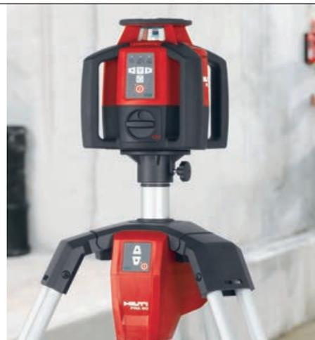
Ещё больше возможностей даёт применение первого в мире автоматического штатива PRA 90 для горизонтального выравнивания. Он оснащён телескопической трубой, позволяющей поднимать и опускать рабочую плоскость в диапазоне более полуметра (540 мм) до 400 раз на одном заряде батареи (да, теперь и в штативе есть своя батарея). Весь комплект работает от общего пульта и даёт возможность быстро построить требуемую плоскость там, где нужно.
