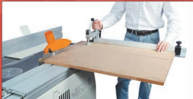
Алюминиевая подвижная каретка с длиной хода 1200 мм вдоль линии реза для обеспечения наилучшей точности реза. Каретка укомплектована упором и направляющей, которые могут использоваться как при пилении, так и при фрезеровании.
