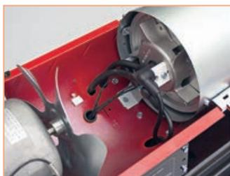
Основные узлы тепловой пушки — вентилятор и камера сгорания, к которой присоединяются форсунка, запальное устройство и элементы защиты
