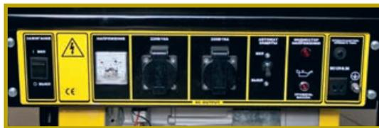
Несмотря на сравнительно скромные параметры в линейке, генератор имеет панель управления с двумя розетками, выходом 12 В, вольтметром и элементами системы защиты электрических цепей
