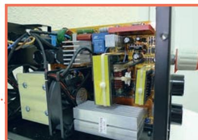
Плата сварочного аппарата расположена вертикально, для охлаждения силовых элементов транзисторы используют вентиляторы с двух сторон от радиатора. На силовом (большем) трансформаторе можно увидеть один из датчиков защиты от перегрева
