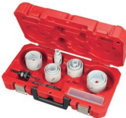
Основная область применения новой серии кольцевых коронок — сверление отверстий диаметром от 14 до 152 мм. Биметаллическая конструкция (с 8-процентным содержанием кобальта) и особая геометрия зубов делает коронки универсальными, так что работать ими можно и с древесиной, и с металлом. Прошедший специальную термообработку металл обладает увеличенной прочностью. Быстрое и эффективное вхождение в материал обеспечено агрессивным положительным углом атаки (1°). Увеличению скорости
