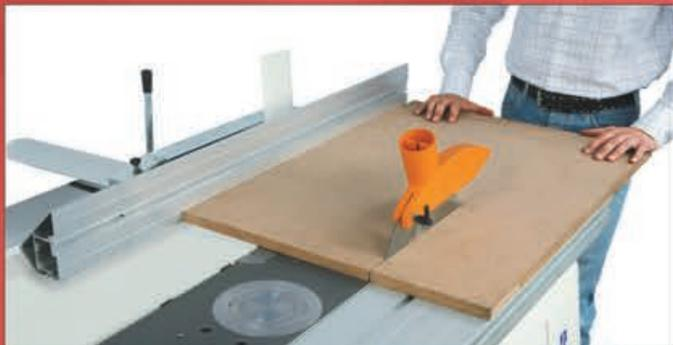
Наклоняемый пильный узел с пилой диаметром 250 мм и наибольшим вылетом полотна 80 мм относительно рабочего стола при 90°. Подъем и наклон пилы регулируется с помощью удобных рукояток.
