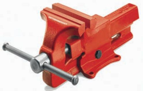
Стальные кованные тиски с дополнительными углообразными губками для труб. Они расположены под параллельными губками и тоже кованные, закалённые. Приспособление снабжено ходовым болтом с трапециевидной резьбой и регулируемой двусторонней призматической направляющей.
