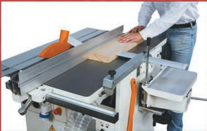
Строгальная группа состоит из одного вала с двумя перезатачиваемыми ножами (как опция, система "Tersa" с тремя быстрозъемными ножами).
