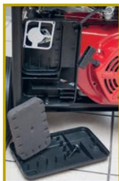
Доступ к поролоновому воздушному фильтру — без инструмента, крышка крепится на одном болте-«барашке». В нижней части корпуса — «лабиринт», в котором оседают крупные частицы пыли, поступающие вместе с воздухом
