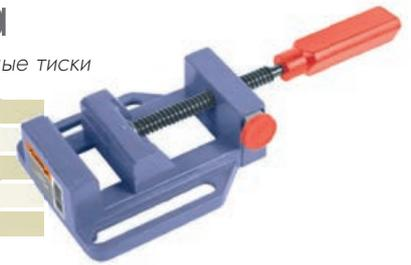
Данные станочные тиски от компании «Кратон» относятся к быстрозажимному типу. Они будут вполне уместны на столе сверлильного станка, если не предполагается больших усилий резания, но нужна частая и быстрая переналадка тисков на разные размеры, например при столярных работах.
