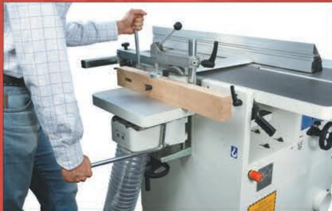
Сверление и формирование пазов осуществляется при помощи пазовального узла.
