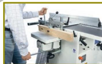
*На пазовальном узле можно выполнять разнообразные типы шиповых и пазовых соединений. На фото — изготовление сквозных гнёзд для плоских шипов*
