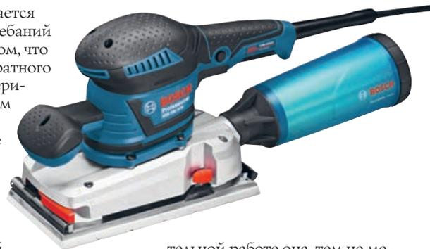
тельной работе она, тем не менее, весьма ощутима. Поэтому новые модели оснащены антивибрационной системой — корпус у них разделён, и это позволяет серьёзно гасить вибрацию. Конструкция включает встроенную систему пылеудаления с патрубком для подключения прозрачного пылесборника с микрофильтром. При необходимости можно подключить пылесос. Прорезиненные рукоятки делают эксплуатацию более комфортной. Одна из них установлена в передней части корпуса — для лучшего контроля над инструментом.
