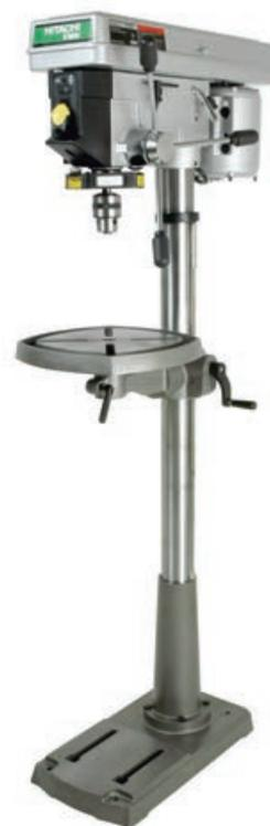
Сверлильный станок — самый востребованный инструмент в любой мастерской. Его точность практически недостижима при применении ручной дрели. Кроме того, при работе (особенно свёрлами большого диаметра) сказывается ремённая передача, которая при любых оборотах развивает максимальную мощность, в отличие от регуляторов дрелей (у них чем меньше скорость, тем ниже мощность).
