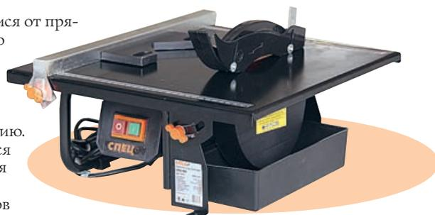
фективность работы. Верхний защитный кожух диска составной: его высоту можно установить в зависимости от толщины плитки так, чтобы диск при работе был максимально закрыт. Опора верхнего кожуха — стальная пластина — заодно играет роль расклинивающего устройства. Нижняя часть диска также прикрыта кожухом. Станок поставляется в пластиковом кейсе и картонной упаковочной коробке.
