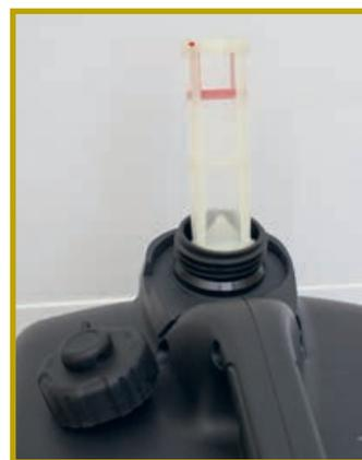
Завинчивающаяся крышка топливного бака — с поворотным клапаном, который при переноске и хранении следует закрывать. Пластмассовый топливный фильтр — с указателем максимального уровня топлива, заливная горловина — с отбортовкой, чтобы при случайном проливе топлива его излишки отводились вбок, а не на панель управления
