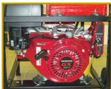
На генераторе установлен верхнеклапанный двигатель Honda GX390 с запуском от ключа и возможностью ручного пуска
