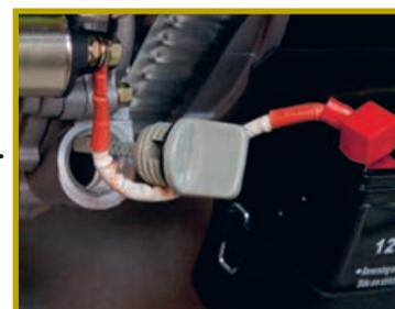
Для электрического запуска генератор укомплектован аккумуляторной батареей. Уровень масла проверяют, отворачивая пробку маслозаливного отверстия с шупом
