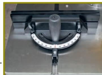
Для обработки заготовок под различными углами к столу в специальный паз устанавливается поворотный упор
