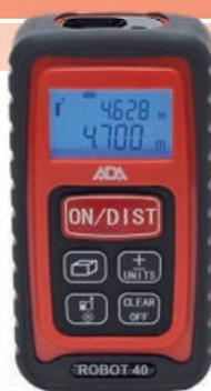
Одна из самых новых и популярных серий инструментов ADA — лазерные дальномеры ADA Robot, предназначенные для профессиональных измерительных работ. Создавая их, специалисты учли все возможные факторы, препятствующие нормальной работе приборов на стройплощадке, и создали инструмент, который не боится воды, загрязнений, пыли, с которым удобно работать в любых погодных условиях, в том числе при ярком солнечном свете без отражающих пластин.
