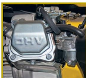
Крышка клапанов с выдавленными буквами OHV (верхнеклапанный). Нижняя часть карбюратора — с пробкой для периодического слива грязи и конденсата или слива топлива перед хранением
