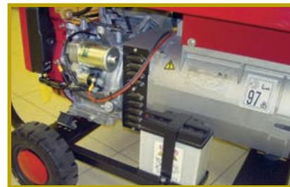
Электрический стартер, аккумуляторная батарея и альтернатор Мецс Alte модели S20F-160/A с компаундным регулятором напряжения
