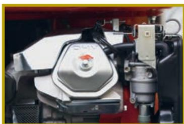
Двигатели с верхним расположением клапанов (OHV) — пожалуй, самые популярные на силовой и садовой технике. Они просты в эксплуатации, обслуживании и ремонте, не слишком требовательны к качеству топлива (конечно, в разумных пределах) да и стоят недорого
