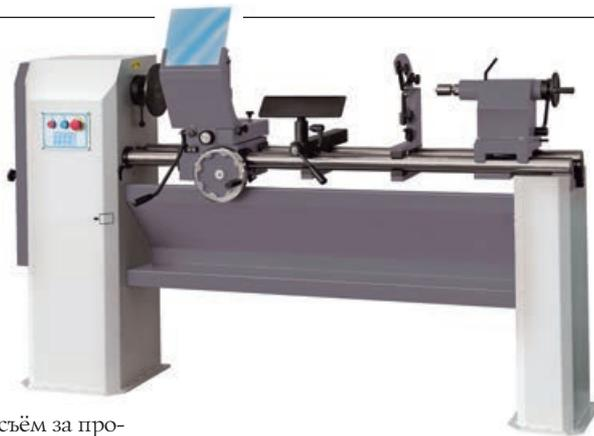
чить балясину по чертежу, а потом достаточно быстро перенастроить DSL-1200 в копировальный и «полуавтоматический» режим и изготовить любое количество одинаковых изделий, копируя первое.
