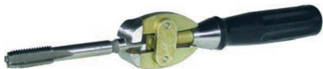
Перед вами ручные тиски, выпущенные ещё в СССР, марка неизвестна. Такие приспособления часто назывались «ювелирными», но в основном использовались как рукоятки для мелких метчиков или радиомонтажниками для пайки радиодеталей.
