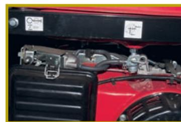
Вытяжной рычаг управления воздушной заслонкой и поворотный топливный кран с отстойником
