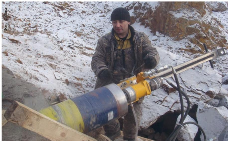
Бурильная установка Cedima с гидравлическим двигателем в работе
