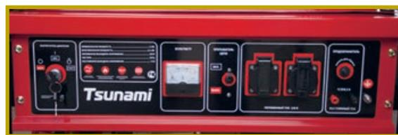
Панель управления: замок зажигания, под ним — индикатор низкого уровня масла, вольтметр, две силовые розетки с прерывателем цепи, выход 12 В с тепловым предохранителем и шпилька для подключения заземления — набор необходимый и достаточный
