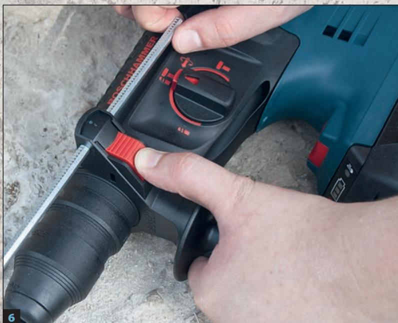
рьёзных и объёмных работ. Имеет три режима, включая чистый удар. Работу с деревом, металлом или пластиком облегчает БЗП, который входит в комплект поставки и при необходимости быстро устанавливается на место «плюсовского» зажима. При работе основная рукоятка показалась неудобной. Вибрация — выше среднего уровня.
