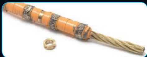
Режущие элементы алмазного каната подходят для сухой и мокрой резки железобетона, цельной и пустотелой стали. Метод нанесения алмазов — спекание в вакууме
