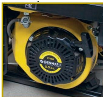
Большинство представленных на рынке недорогих рамных генераторов снабжены двигателями, конструктивно схожими с моторами Honda GX (отличий много, но они не слишком существенны), простыми и надёжными по конструкции и стоящими в разы ниже «оригинала»
