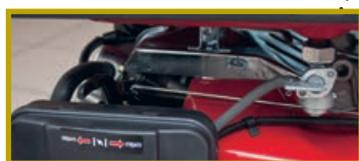
Топливный кран с отстойником и поворотный рычаг управления воздушной заслонкой. Запуск станции начинается с открывания крана и закрывания заслонки, после этого можно поворачивать ключ в замке зажигания
