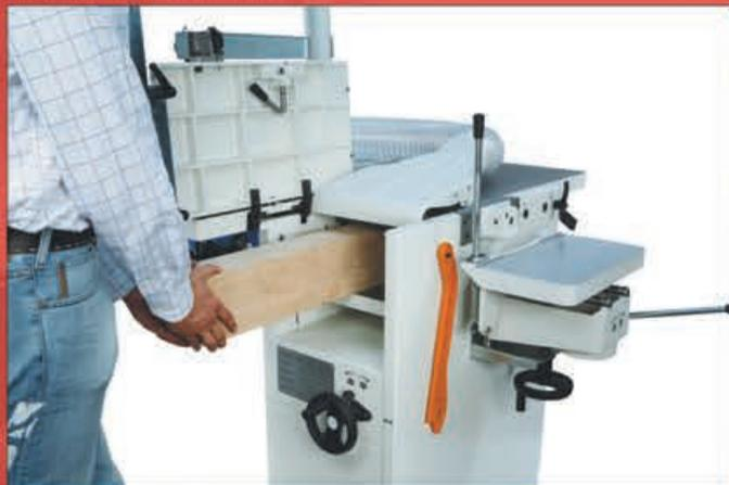
На рейсмусовом узле можно обработать заготовки толщиной 200 мм благодаря высокопроизводительной системе подачи. Система открытия фуговального стола к центру станка обеспечивает компактность станка, облегчает визуальный контроль во время работы, экономит время и упрощает обработку.
