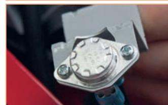
К нижней части камеры сгорания также присоединяются фотоэлемент и датчик температуры
