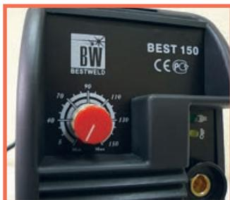
На лицевой панели расположены регулятор сварочного тока, индикаторы сети и перегрева и выходы для подключения сварочных кабелей
