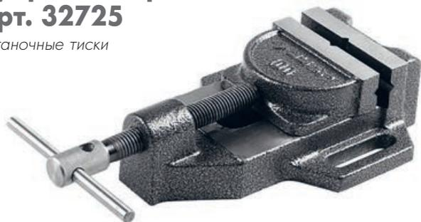
Облегчённые станочные тиски, хорошо подходящие для сверлильного станка. На их губках нет сменных стальных накладок, зато есть прорези для зажима круглых заготовок. Отсутствие сменных накладок нельзя считать недостатком, так как при необходимости рабочие всё равно подкладывают на губки прокладки из мягких металлов, пластика или дерева.
