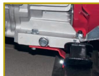
Генератор в сборе крепится к раме через резиновые подушки. Красный кронштейн между ними — транспортный, перед работой его нужно снять
