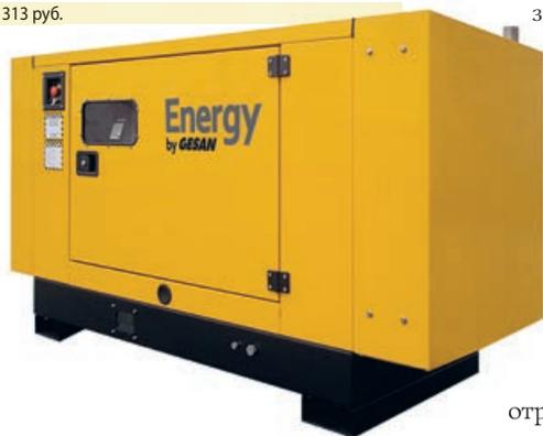
торы могут работать в любую погоду, желательно заранее предусмотреть хотя бы навес от дождя и прямых солнечных лучей. Перед включением нужно заземлить аппарат, для этого на нем предусмотрена шпилька с гайкой. Проще всего использовать заостренный Т- или Г-образный металлический штырь (лучше медный или латунный), забиваемый в землю, и медный провод для соединения штыря и шпильки. В комплект станций он не входит, но сделать его довольно просто из подручных материалов.
