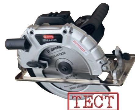
ствующего диска возможна работа с газобетоном, цементно-стружечными и гипсокартонными материалами. С учётом солидного веса и мощности лучше всего рабочие качества пилы проявляются при распиле толстых материалов вроде половых досок или бруса. Для частой или продолжительной работы с тонкой доской или фанерой целесообразнее устанавливать пилу в стационарное положение.
