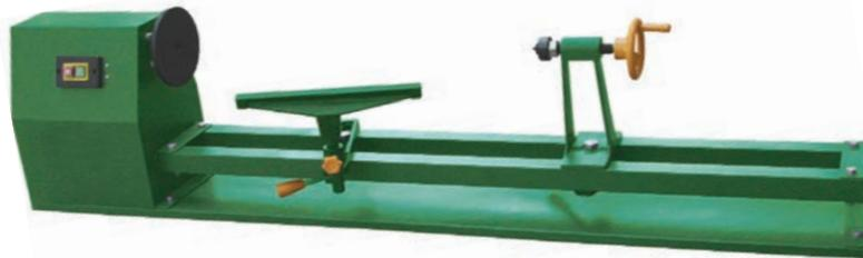
Компактный и вместе с тем пригодный для достаточно больших заготовок «токарник» по дереву. Он подойдёт любому столу — точёные части мебели или предметы интерьера нужны часто, а на этом станке вполне получится изготовить и тонкие балясины к лестнице, и деревянные подносы, и части люстр, и много чего ещё. Ременная передача с четырьмя скоростями обеспечивает достаточный крутящий момент, чтобы заготовка не останавливалась под резцом.
