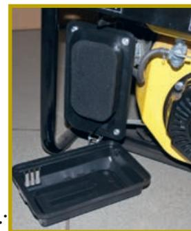
Воздух поступает в корпус воздушного фильтра через отверстия в левой верхней части его крышки. Перед поступлением к самому фильтру поток воздуха направляется вниз: так обеспечивается предварительная очистка от пыли
