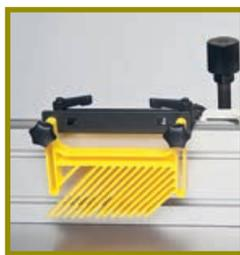
Чтобы при фрезеровании заготовка не «поднималась» относительно плоскости стола, для её прижима используются две «гребёнки» — прижимные планки. Они же защищают саму заготовку и окружающих от возможного обратного удара
