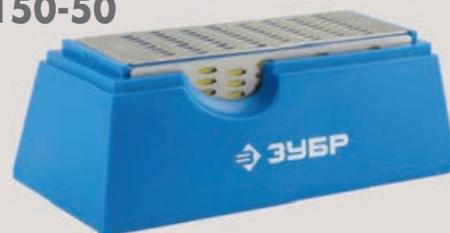
Алмазные бруски применяют для заточки режущих кромок любого инструмента, начиная от кухонных ножей и вплоть до твёрдосплавных ножей электрорубанков и рейсмусовых станков. Также бруском можно обрабатывать острые грани керамической плитки, стекла, полировать изделия из камня и гранита. Разная зернистость граней позволяет осуществлять как грубую предварительную шлифовку, так и окончательную доводку. В комплект входит специальная подставка, надёжно фиксирующая брусок при шлифовании.
