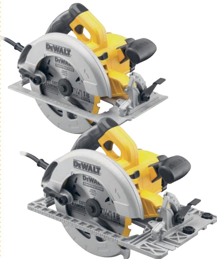
Прецизионные дисковые пилы снабжены шкалой для точной установки глубины резания — до 67 и 61 мм соответственно. При резе под углом 45° глубина пропила меньше — 45 и 49 мм. Кстати, разделять заготовки можно под углом до 57°. Выбранный угол надёжно фиксируется зажимом.
