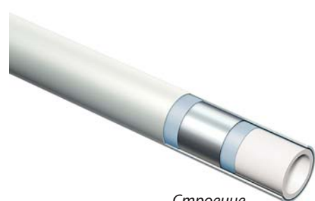
Строение металлополимерной трубы на примере Тесе: внутренний слой из сшитого полиэтилена, затем клеевой слой, алюминиевая фольга, снова клей и внешняя оболочка из полиэтилена
