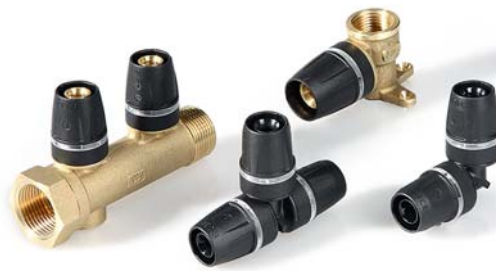
Пуш-фитинги Tece для металлополимерных труб PE-XC выполнены из PPSU, фитинги-переходники на резьбу — из латуни
