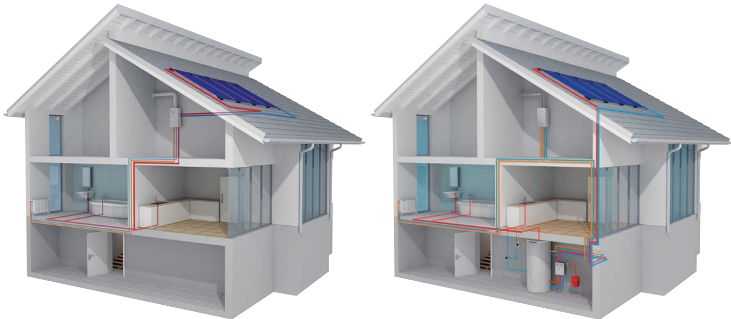
Оптимизация солнечной системы Bosch при приготовлении горячей воды (слева) и для отопления (справа)
