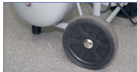
Обрезиненные колёса большого диаметра облегчают перемещение, муфта для шланга расположена параллельно корпусу ресивера: так меньше вероятность случайного повреждения
