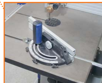
Стол снабжён направляющим пазом для углового упора
