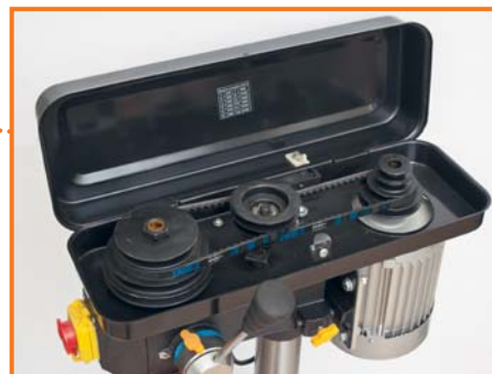
Чтобы обеспечить нужный скоростной режим, приводной ремень устанавливают в одно из 12 положений
