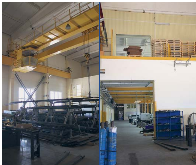
Кран-балка в зоне разгрузки и переход в «двухэтажный» цех. Полы ровные, покрыты специальными не пылящими составами
