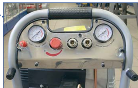
Элементы панели управления: манометры, показывающие давление в ресивере и на выходе из компрессора, предохранительный клапан, регулятор выходного давления и два выхода с муфтами для быстрого закрепления шлангов высокого давления
