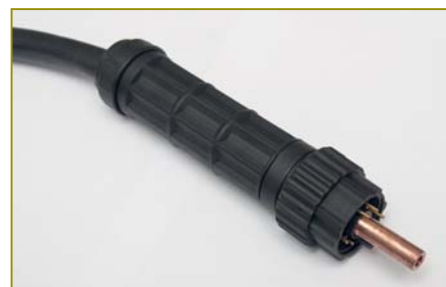
Наконечник кабеля для резки, вставляемый в аппарат. Медный штуцер в центре наконечника, соединяющий аппарат и рукав, — для подачи воздуха к горелке
