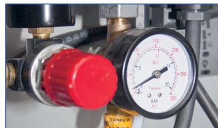
Регулятор давления с установленным на нём манометром для контроля выпускного давления, показывающий давление в ресивере «основной» манометр и предохранительный клапан под ним
