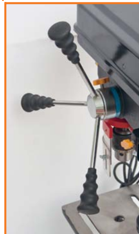
Для подъёма шпинделя служит классическая трёхспицевая рукоятка
