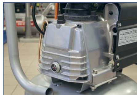
На боковой крышке компрессорной головки расположены пробка, прикрывающая отверстие для заливки масла, и окошко для контроля его уровня
