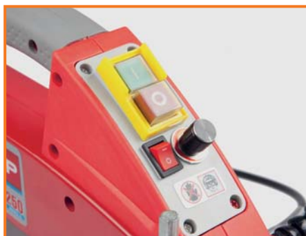
В передней части расположена панель управления лобиковым станком
