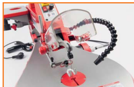
Место реза не только обдувается, чтобы опилки не оставались на линии разметки, но и подсвечивается
