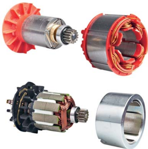
Сверху — бесщёточный двигатель Milwaukee PowerState, используемый в линейке M18 Fuel. Внизу — 4-полюсный бескорпусный коллекторный мотор, применяемый на моделях предыдущей версии M18
