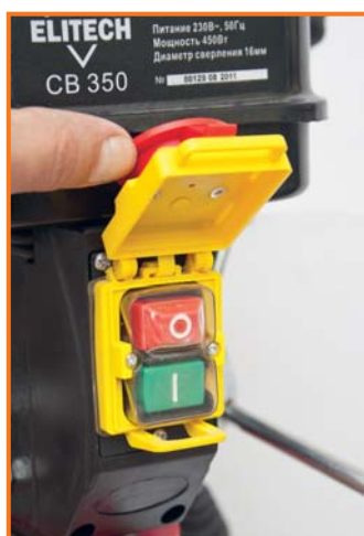
Кнопки включения и выключения убраны в жёлто-красный кожух
