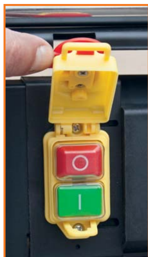
Кнопки управления для безопасности скрыты под откидной крышкой
