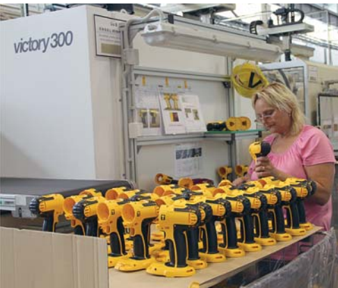
▲ Производство пластиковых комплектующих. Работают примерно 20 прессов, в основном от 80 до 800 тонн
