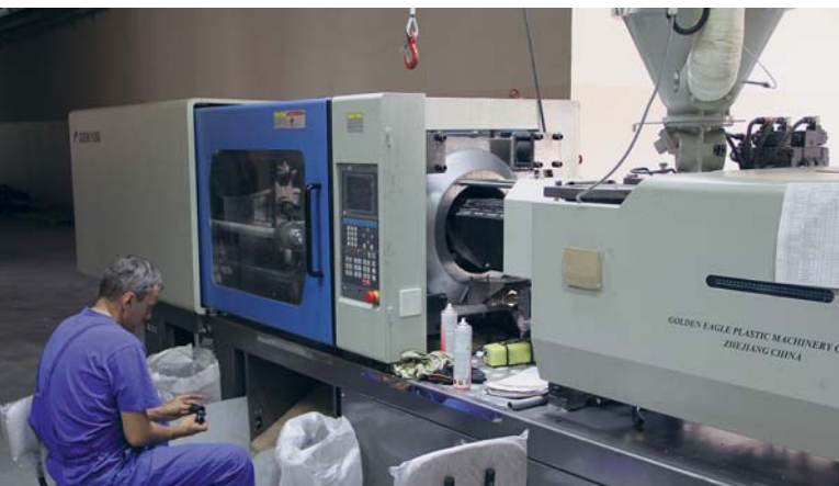
Здесь изготавливают пластиковые детали (накладки, ручки, элементы защиты и т. д.) методом литья пластика в специальных формах
