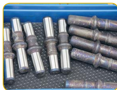
На фото справа — бойки после закалки, слева — после обработки
