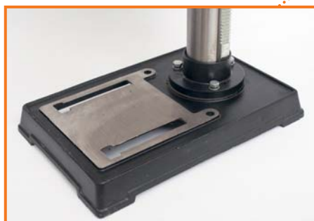
Чугунное основание делает станок устойчивым
