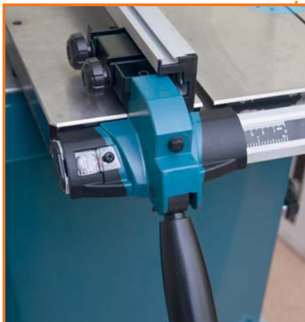
Выключатель помещён под защитную крышку, что исключает случайное включение
