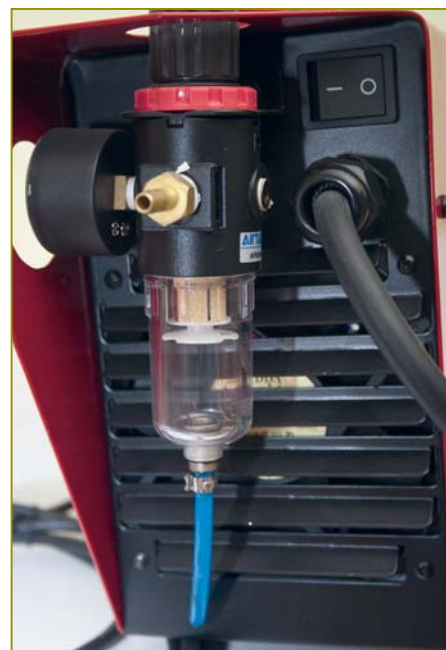
Сетевой выключатель и блок подготовки воздуха с фильтром-влажностоотделителем, манометром и регулятором давления
