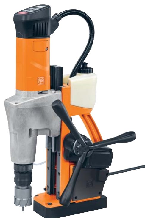
Машина предназначена для сверления отверстий в крупных металлических деталях, закрепляется с помощью магнита прямо на них. При вертикальном сверлении достаточно встроенного магнита, в других случаях следует использовать дополнительный страховочный ремень
