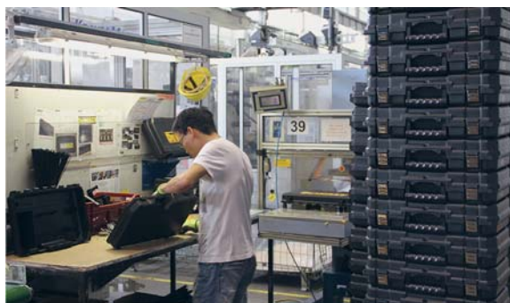
▶ Завод сам производит чемоданы для инструментов, причём прессы работают круглосуточно. Средняя скорость — чемодан в минуту
