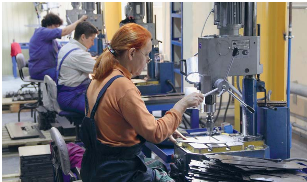
Плоские детали проще и дешевле сверлить на таких вот станках (с сохранением прежнего высокого уровня качества)
