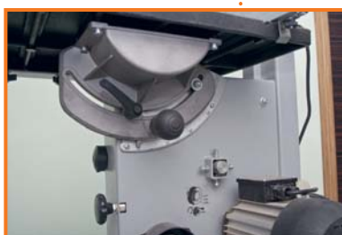
Положение рабочего стола фиксируют при помощи барашкового винта
