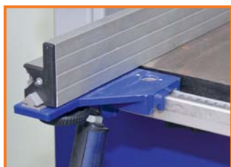
Параллельный упор оснащён лупой для более чёткой индикации его положения
