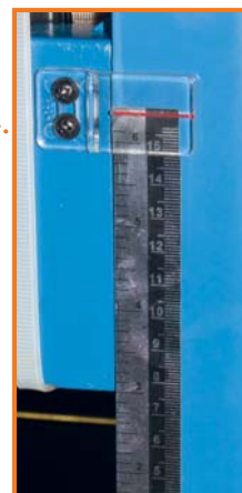
В правой части корпуса расположена линейка для точной настройки параметров строгания
