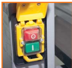
Под яркой крышкой скрыты кнопки выключения станка
