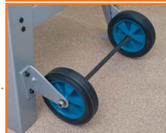
Конструкция станка включает пару достаточно широких колёс и основательную рукоятку, которые помогут при транспортировке станка
