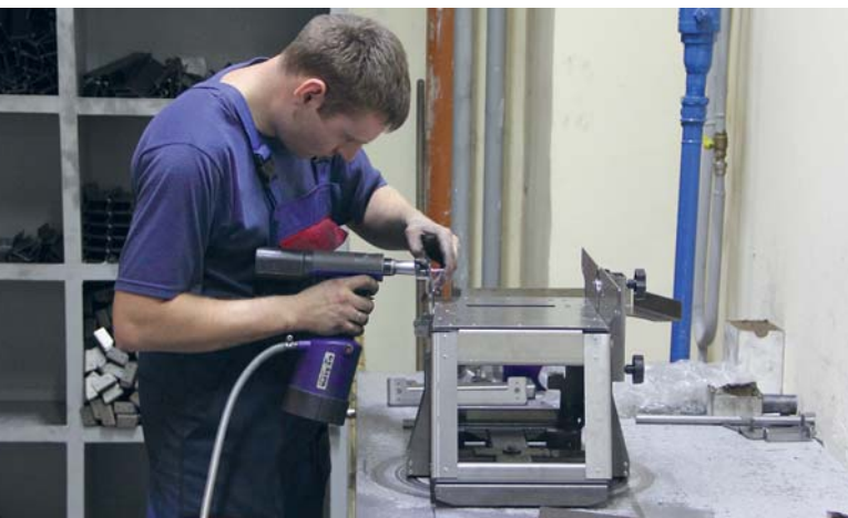
Участок сборки. Крупноузловые детали соединяют заклёпками с помощью пневмоинструмента
