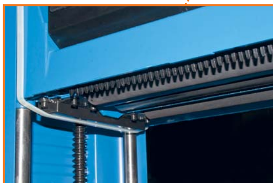
Один из элементов системы защиты рейсмусного станка от обратного удара — гребёнка из металлических пластин
