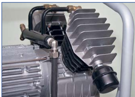
Пневматических головок две, каждая с фильтром на входе. Мощное оребрение повышает эффективность отвода тепла
