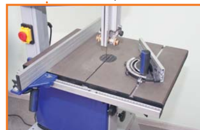
Распиловочный стол выполнен из надёжного чугуна
