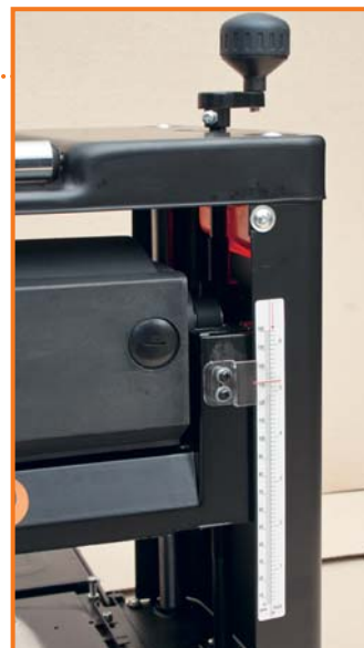
Уровень высоты регулируют при помощи рукоятки в верхней части станка
