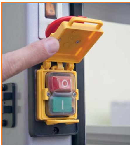
Выключатель помещён под защитную крышку, что исключает случайное включение
