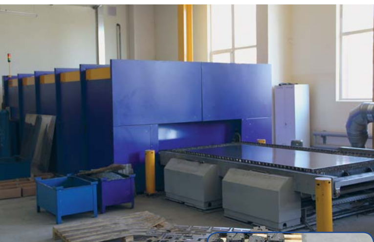
Станок лазерной резки (Словения). В ближайшее время на заводе ждут ещё один лазерный резак, уже российского производства (Дубна). У него два крупных преимущества: во-первых, он двухпортальный, то есть работа пойдёт быстрее. А во-вторых, он менее привередлив к качеству кислорода, который для лазерного резака необходим
