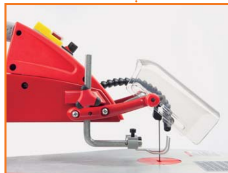
Пильная часть для безопасности пользователя прикрыта прозрачным пластиковым щитком
