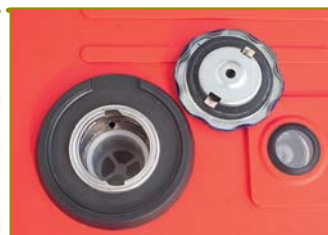
Крышка топливного бака и круглое окошко — указатель уровня топлива
