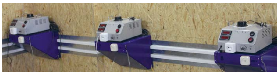
В лаборатории технического контроля. Все до единого станки проходят испытания на электробезопасность, проверяется также склонность к перегреву. В лаборатории оборудовано несколько стенов, каждый станок включают на 20 минут без нагрузки
