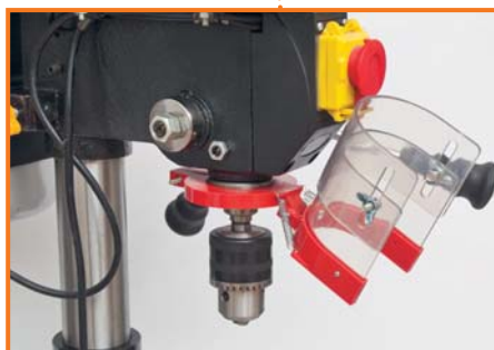
Двойной пластиковый защитный щиток сделан откидывающимся
