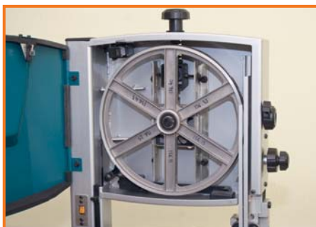
Для удобства смены лент дверца станка открывается без инструментов
