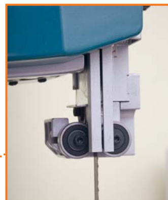
Высокую точность обеспечивают в том числе надёжные и долговечные опорные ролики
