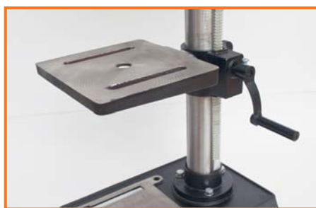
Высоту рабочего стола регулируют вращением рукоятки
