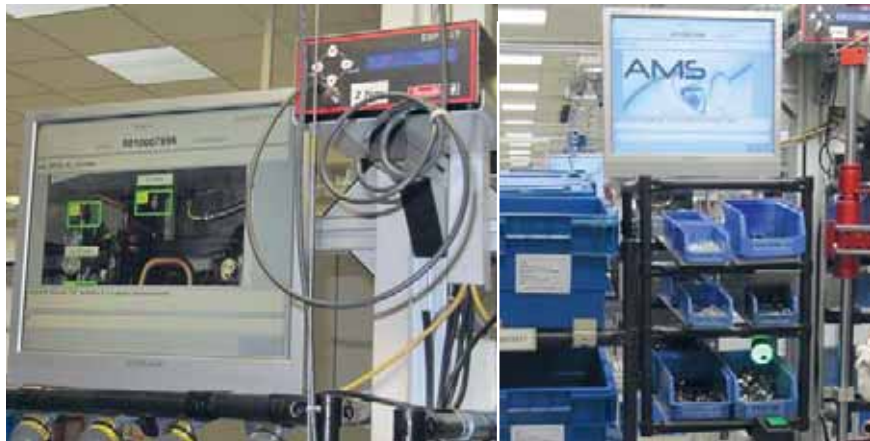
За процессом сборки следит система AMS, высвечивая подсказки на экране монитора. Нужные детали для сборки могут подсвечиваться светодиодами — для быстрого распознавания
