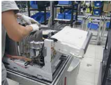
11. Установка горелочного устройства
