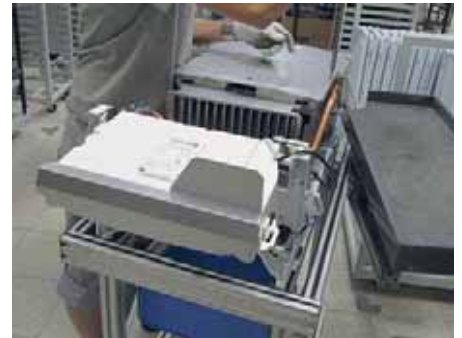
12. Монтаж переднего покрытия изолирующего камеру сгорания
