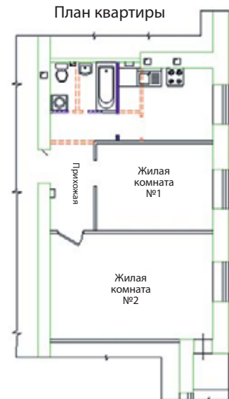
Пример неправильной перепланировки. Площадь кухни увеличилась за счёт перепланировки санузла и уменьшения его площади. При этом для квартиры на нижнем этаже ухудшения не произошло, но санузел верхнего этажа может залить кухню
