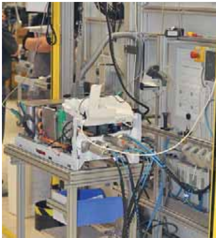
10. Тестирование гидравлической группы котла (на предмет утечек, качества сборки и т. д.) на испытательном стенде
