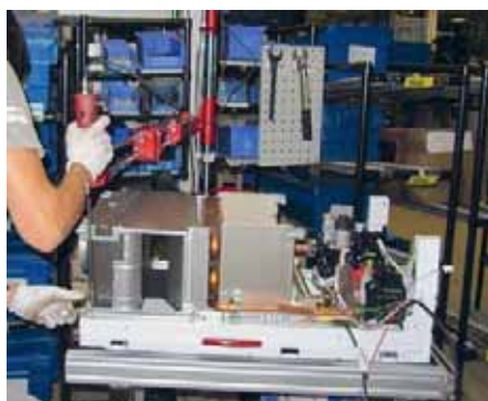
8. Затяжка креплений прерывателя тяги
