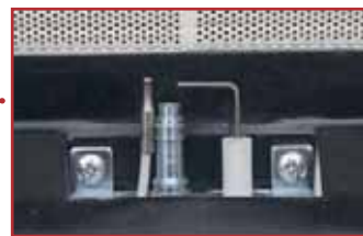
Запальная горелка с термопарой и электродом. В случае прекращения работы запальной горелки подача газа перекрывается и нагреватель отключается
