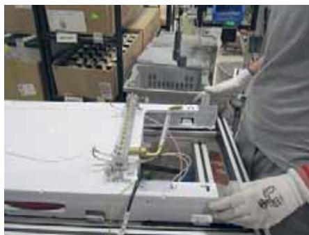
2. Установка на тележку основы котла с расширительным баком, рампой горелки и электродами розжига
