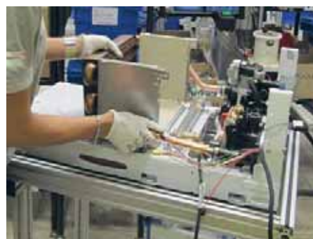
6. Установка первичного теплообменника
