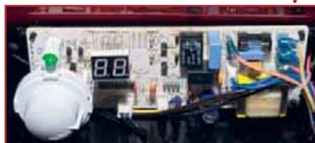
Электронная начинка дизельной тепловой пушки (южнокорейское производство)
