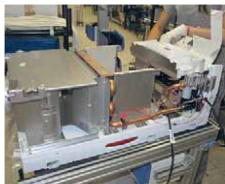
9. Установка электронного блока
