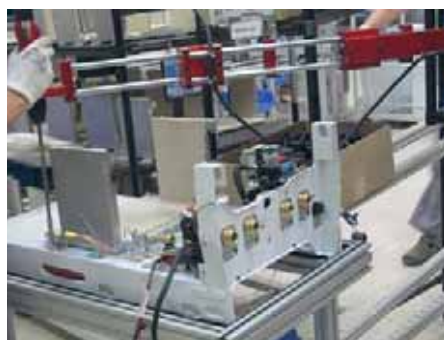
5. Монтаж изоляционных панелей камеры сгорания
