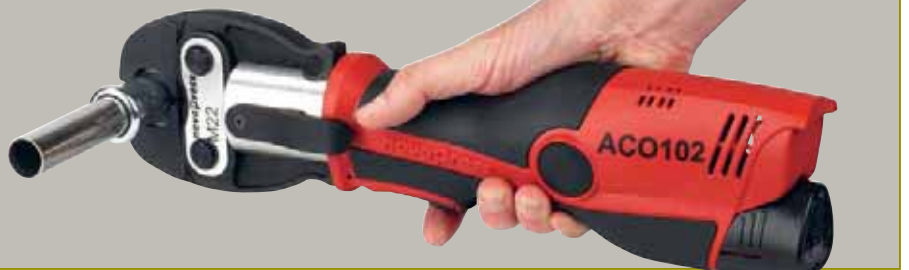
Компактный пресс-инструмент отличается от стандартных моделей меньшим весом и габаритами, отдельным видом сменных клещей и меньшей мощностью. Фото: Novopress
