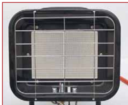
Открытая часть пористой керамической нагревательной пластины и запальная горелка прикрыты решёткой из нержавеющей стали
