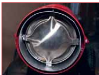
Камера сгорания из прочной нержавеющей стали
