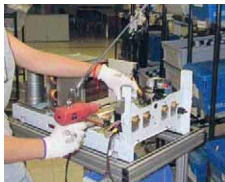
7. Установка прерывателя тяги и соединение гидравлического блока с теплообменником
