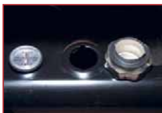
Датчик на баке показывает уровень топлива в нём
