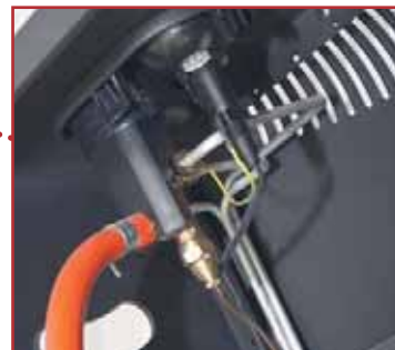
Газовый клапан и механизм пьезорозжига с несколькими проводками и газовой арматурой — вот практически и всё, что видно внутри корпуса (керамическая нагревательная пластина и узел розжига прикрыты отдельным кожухом)
