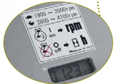
Данные об оборотах двигателя, а также отработанное время выводятся на дисплей
