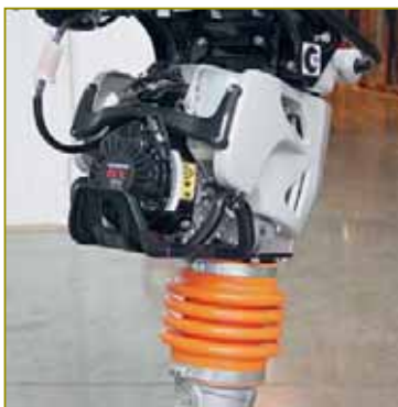
Система гашения вибрации значительно снижает уровень колебаний, передаваемых на руки оператора. В результате управление машиной становится лёгким и предсказуемым, а усталость рабочего в конце дня — минимальной
