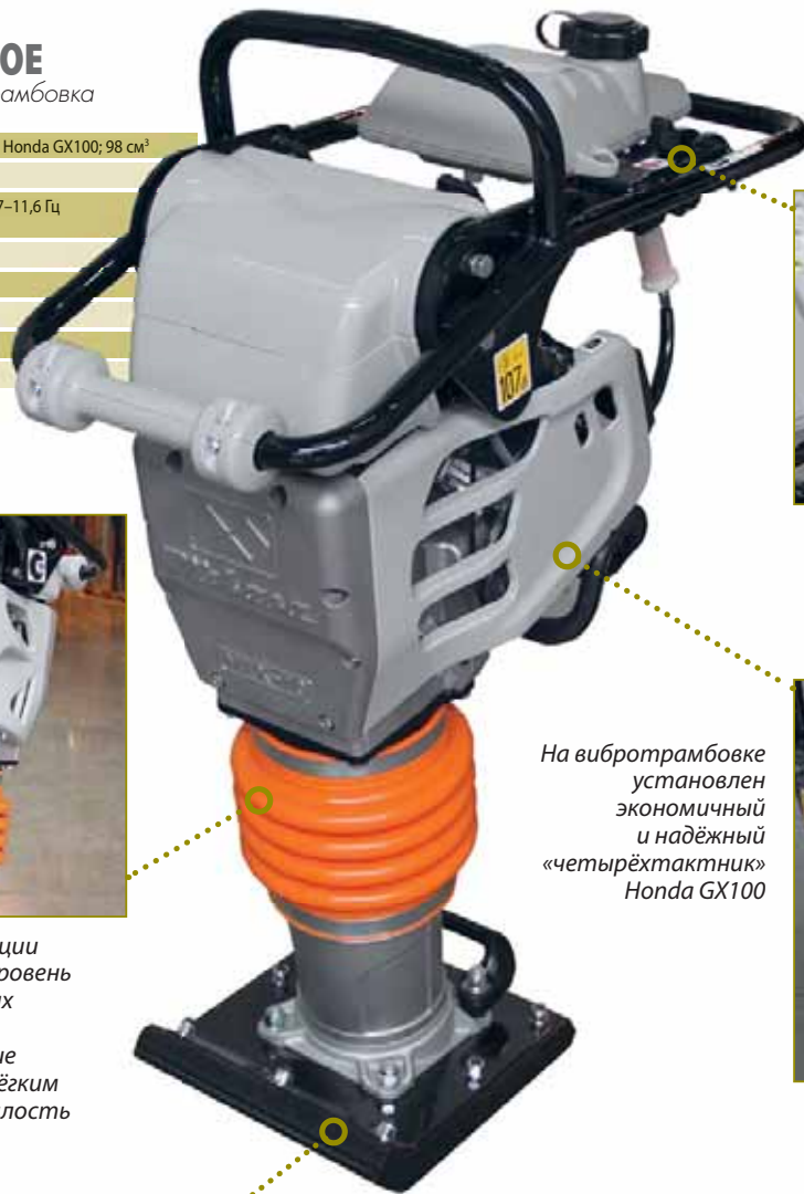
Вибротрамбовка оснащена широкой рабочей подошвой (285×340 мм). Ударная площадка с трёхслойной конструкцией рассчитана на длительную эксплуатацию в тяжёлых условиях
