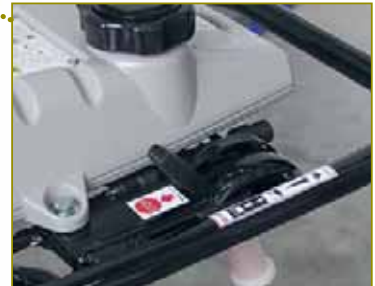
Рычаг газа объединён с механизмом отключения подачи топлива
