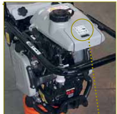
На вибротрамбовке установлен экономичный и надёжный «четырёхтактник» Honda GX100
