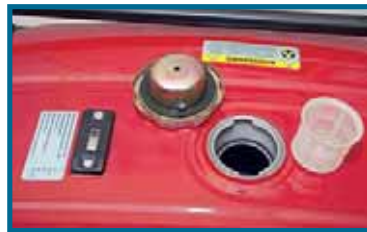
Топливный бак с поплавковым указателем уровня топлива и съёмным пластмассовым фильтром
