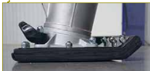
Вибротрамбовка оснащена широкой рабочей подошвой (285×340 мм). Ударная площадка с трёхслойной конструкцией рассчитана на длительную эксплуатацию в тяжёлых условиях
