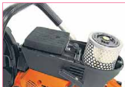
Воздушный фильтр состоит из трёх частей. Такая конструкция обеспечивает максимальную степень очистки воздуха, что благоприятно сказывается на ресурсе мотора
