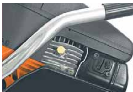
Декомпрессионный клапан значительно снижает усилие, необходимое для запуска двигателя
