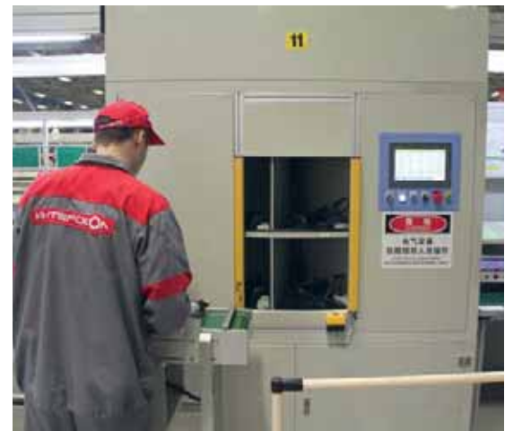
После сборки инструменты проходят проверку на специальном стенде
