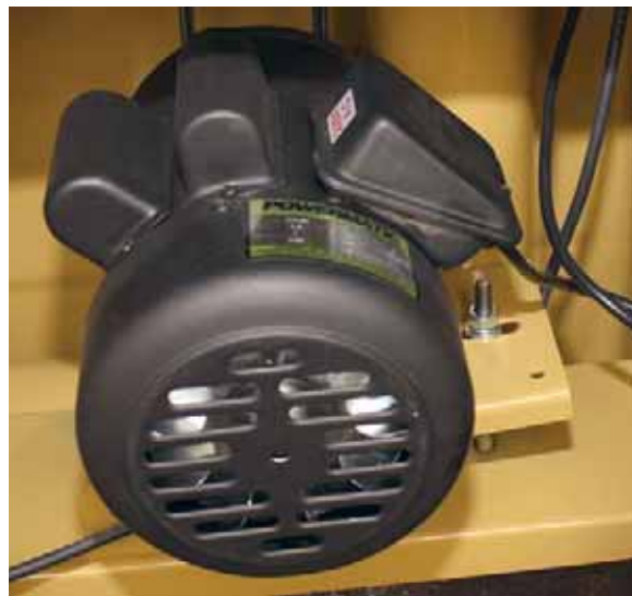
Внутри основания находится асинхронный электродвигатель. Выпускаются модификации станка с однофазным мотором (этот — однофазный)
