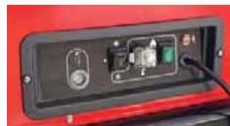
Панель управления. Справа налево: индикатор напряжения, переключатель режимов работы (с выносным термостатом или без), разъём для подключения выносного таймера или термостата, переключатель режимов работы (два режима мощности и обдув) и кнопка «перезагрузки» со световой индикацией режимов работы или ошибки
