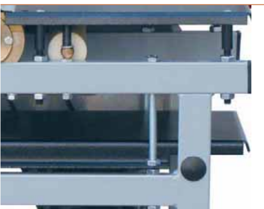
Пильный диск закрыт кожухами и сверху, и снизу пильного стола, кожух фуговального вала при настройке сдвигают и фиксируют винтами. Направляющую планку крепят к столам трубочинами. Рядом со трубочиной виден узел когтевой защиты (для модели «Муравей» СД-6)
