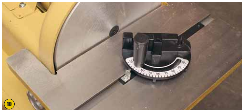
10 В комплект входит угловой упор, который можно установить в специальный паз на любой из столов. Угол поворота упора — ±60°
