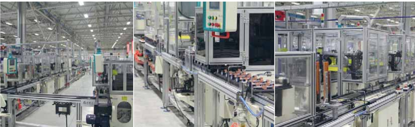
Автоматизированные линии по сборке активных частей электродвигателей. Переналадка оборудования с одной модели на другую происходит очень быстро
