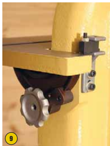
8 Столы станка можно опускать на угол до 45° (ленточный узел снова установлен вертикально). Стол тарельчатого узла можно и поднимать на угол до 45°, он фиксируется маховиками с двух сторон
