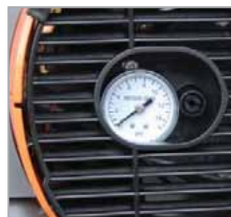
Давление нагнетания топлива контролируют по встроенному манометру, при необходимости регулируют, вращая винт рядом с манометром
