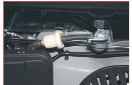
Бензобак оборудован краном с отстойником, для бензиновых генераторов в этом нет ничего необычного. А вот отдельный сменный топливный фильтр — устройство хотя и недорогое, и простое (можно купить в любом автомагазине), но на генераторы практически никогда не ставится
