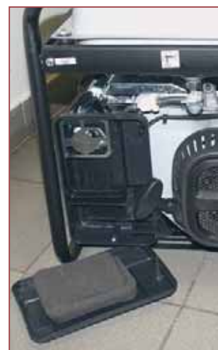
Поролонный воздушный фильтр со специальной пропиткой в пластмассовом корпусе с лёгко съёмной крышкой
