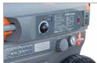
Встроенный термостат позволяет задать значение желаемой температуры в диапазоне от 5 до 45 °С. Окружающая температура отображается на встроенном цифровом индикаторе, на него же выводятся коды ошибок. Под панелью управления видны пластиковая крышка топливного бака и легко читаемый указатель уровня топлива
