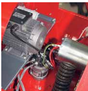
Под двигателем вентилятора расположен топливный насос высокого давления. Воздух в горелку поступает через решётку на боковине корпуса, по отдельному рукаву
