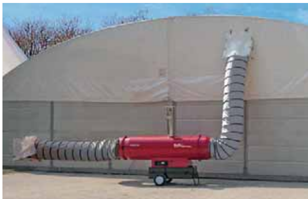
Вариант наружной установки пушки (с замкнутой системой циркуляционного нагрева воздуха). Необходимые адаптеры и рукава для таких решений приобретают дополнительно. Одну пушку реально использовать и для отопления сразу двух помещений
