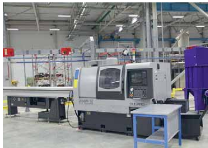
Трёхкоординатный автомат продольного точения, изготавливающий валы электродвигателей из металлических прутков
