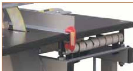
Пильный диск закрыт кожухами и сверху, и снизу пильного стола, кожух фуговального вала при настройке сдвигают и фиксируют винтами. Направляющую планку крепят к столам трубочинами. Рядом со трубочиной виден узел когтевой защиты (для модели «Муравей» СД-6)
