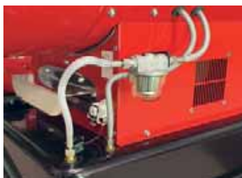
На подающей магистрали насоса установлен легкодоступный топливный фильтр, второй шланг — «обратка», для сброса излишков топлива обратно в бак. Между шлангами виден разъём для подключения специального устройства предварительного нагрева топлива
