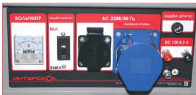
Силовые выходы, элементы защиты электрических цепей и шпилька для заземления находятся с правой стороны панели управления. С левой — только замок зажигания
