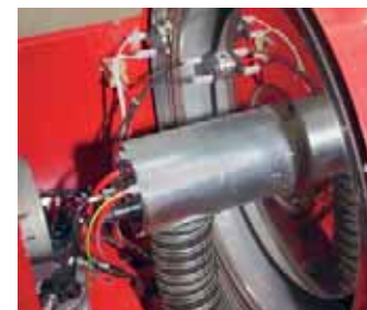
У пушек непрямого нагрева контур, в котором сгорает топливо, изолирован от потока нагретого вентилятором воздуха с помощью теплообменника. Здесь использован четырёхходовой теплообменник, для контроля температуры применены два датчика перегрева
