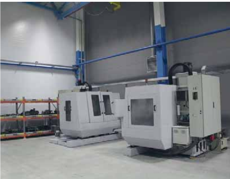
Машины, очищающие детали от облоя, который возвращается обратно на переплавку
