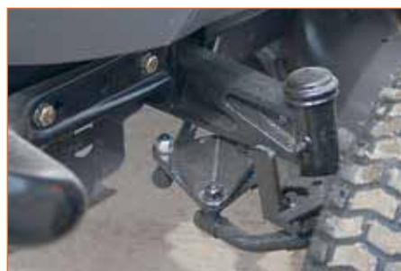
Минимальный радиус поворота трактора — 20,8 см, диаметр необработанного круга — 70 см. Чтобы добиться таких значений, используется запатентованная конструкция передней рулевой трапеции Husqvarna U-Cut
