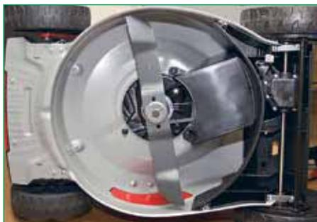
Ось передних колёс находится выше передней части стального корпуса, сзади зона вращения ножа ограничена пластиковым «вкладышем». Доступ к механизму привода колёс возможен как снизу, так и сверху, через люк
