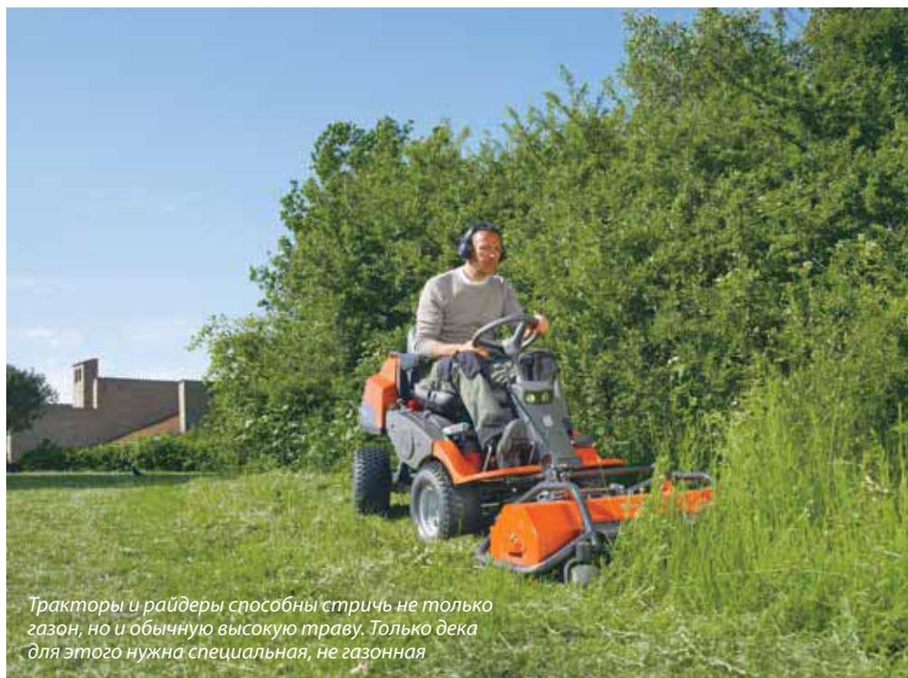
*Тракторы и райдеры способны стричь не только газон, но и обычную высокую траву. Только дека для этого нужна специальная, не газонная*
