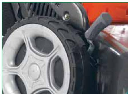
Регулировка высоты скашивания централизованная, рычагом у правого заднего колеса. Цифра 4 в названии модели и на наклейке означает, что косилка может работать во всех четырёх возможных режимах кошения
