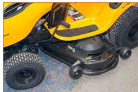
По краям и спереди по центру деки закреплены поддерживающие колёса. С левой стороны — щётка для мойки деки. Рядом с ним видна наклейка — схема установки ремня привода деки
