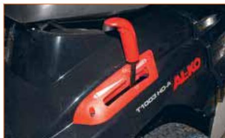
Рычаг слева на корпусе служит для выбора скорости и направления движения
