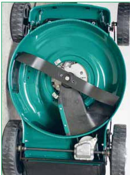
Штампованная стальная дека с двумя сваренными поперечными полукруглыми элементами. Для облегчения смены высоты обработки оси косилки подпружинены
