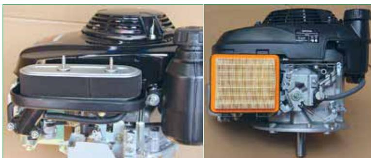
Крышки фильтров сняты. Фильтры на разных двигателях могут быть различными: поролоновыми, плоскими из гофрированной бумаги или объёмными из бумаги с предварительным поролоновым фильтром. Но снять и продуть их несложно. На фотографии также виден топливный кран, который открывают на время работы двигателя
