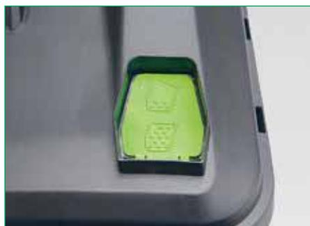
Для включения двигателя нужно прижать штангу к рукоятке, как и у большинства косилок, но сначала надо разблокировать привод — нажать кнопку на рукоятке
