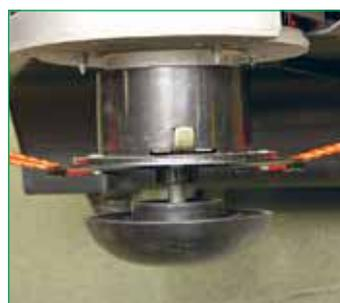
Головка косилки с закреплённой леской. Высота обработки регулируется перемещением опорной чашки, которая удерживается в нужном положении подпружиненной кнопкой-фиксатором
