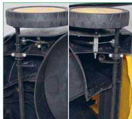
Стальные оси косилок с приваренными к ним рычагами, на которых закреплены оси самих колёс и элементы механизма регулировки высоты — пружины и тросы, поворачивающие оси
