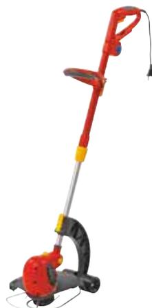
**ОСОБЕННОСТИ:** ограждение для защиты растений; автоматическая катушка; возможен поворот головки для подрезки кромок; регулировка угла поворота головки относительно ручки без инструмента; раздвижная телескопическая штанга; опорные колёса
