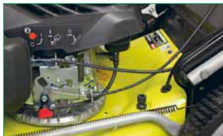
Параллельно продольной тяге находится уравнивающая пружина, дека снабжена штуцером для мойки. Пиктограммы на двигателе показывают порядок действий при запуске: открыть топливный кран, прижать штангу к рукоятке, для выключения — отпустить штангу
