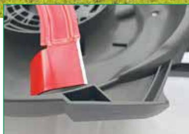
На косилке установлен нож — «вентилятор» сложной формы, пригодный для мульчирования. Подобные встречаются даже далеко не на всех бензиновых газонокосилках. Выступы на передней части деки позволяют направить к ножу стебли травы, растущей вплотную к препятствиям
