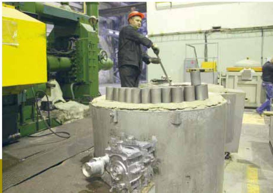
Литейный цех компании «Калужский двигатель». Здесь отливают алюминиевые блоки двигателей ДМ-1 М. Собственная съёмка редакции, 2013 год
