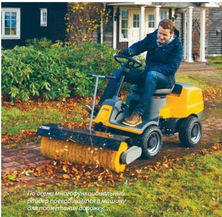
По осени многофункциональный райдер превращается в машину для подметания дорожек...
