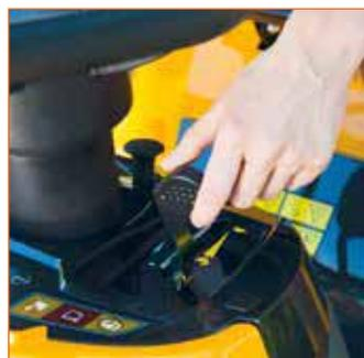
Воздушная и топливная заслонки двигателя управляются одним рычагом, размещённым на рулевой колонке. Также видны три из шести контрольных ламп и кнопка «Mode» — выбор режимов отображения ЖК-дисплея
