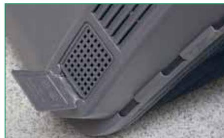
«Флажок»-сигнализатор при работающем ноже поднимается воздушным потоком. После заполнения травосборника «флажок» опускается — пора остановить косилку и очистить травосборник
