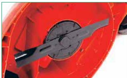
Кошение производится прямым ножом, поток воздуха создаётся его загнутыми участками — «лопастями». Чёрный диск с крыльчаткой прикрывает вал двигателя от попадания к нему обрезков травы, грязи и иного мусора
