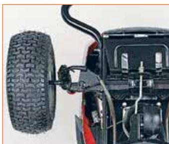
Конструкция системы рулевых тяг (Turn Tight) позволила добиться чрезвычайно малого радиуса поворота трактора — всего 15,2 см
