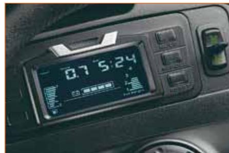
Приборная панель — ЖК-экран, на котором, кроме основных данных, отображается положение деки, высота кошения, счётчик моточасов, обычные часы и многое другое. Рядом находится рычажок для установления высоты кошения
