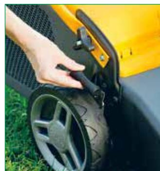
*Задние колёса установлены на общей оси, регулировка их положения производится одним рычагом. Рукоятка управления косилкой имеет шарнирное соединение с корпусом, отвернув и сняв «барашки», её можно сложить вперёд для экономии места при хранении*
