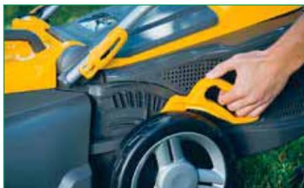
У левого заднего колеса находится рукоятка установки высоты скашивания. На модели применена централизованная регулировка высоты, продольная тяга убрана внутрь корпуса. На боковине пластикового травосборника видны цифры, указывающие выбранную ступень
