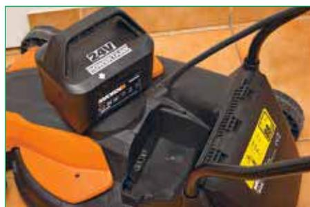
Аккумулятор полностью герметичен, устанавливается в нишу на корпусе косилки. Допускается хранение косилки и батареи в любом пространственном положении
