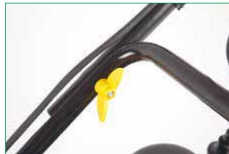
Один из двух шарниров рукоятки газонокосилки: «мебельный» болт с квадратным подголовником и гайка-«барашек», отворачиваемая без помощи инструмента
