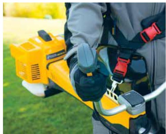
К мотокосе с «велорукоятками» обязательно в комплекте идёт плечевой ремень или ранцевая подвеска, у которой ремни на два плеча. Необходимый элемент — бедренный щиток, который гасит удары и вибрацию от работающего инструмента
