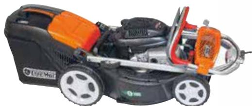
Рукоятку управления можно сложить в двух местах, просто ослабив верхний и повернув два нижних быстрозажимных фиксатора. На фото — модификация модели с двигателем Honda
