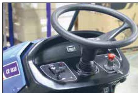
Панель управления с рычагом управления частотой вращения коленвала, кнопкой электромагнитной муфты включения привода навесного оборудования, замком зажигания, рычагом стояночного тормоза и встроенным тахометром
