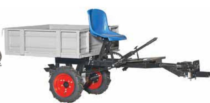
Адаптер АМПК-500 для мотоблока «Угра» в сборе с кузовом
