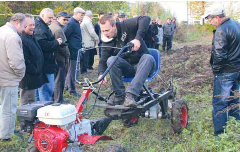
Испытания ездового адаптера с ведущими колёсами АМПК-500 производства «КАДВИ». Собственная съёмка редакции, 2013 год
