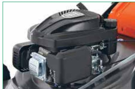
На этой газонокосилке установлен двигатель собственного производства, модели Eмаk K 800 OHV. В серии встречаются и разновидности, оснащённые моторами от сторонних компаний, но косилки с ними обойдутся немного дороже
