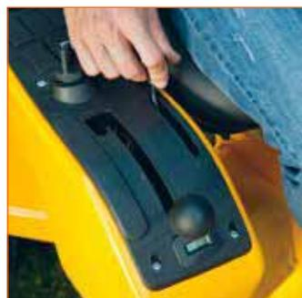
Большинство элементов системы управления сконпновано на выносной панели под правой рукой оператора. Спереди на панели — рычаги включения привода деки и управления оборотами двигателя, а также электронный счётчик моточасов
