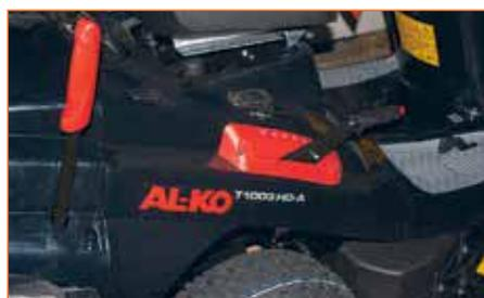
Под правой рукой — рычаг установки высоты кошения и клавиша включения электромагнитной муфты привода ножей. Сзади, справа, — вытяжной рычаг для опорожнения травосборника
