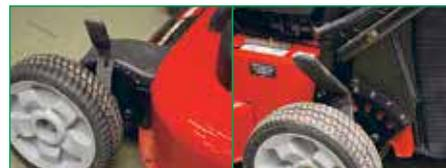
На косилке применена система регулировки высоты кошения по осям. Рычаги регулировки расположены у левых колёс, доступно семь положений. Примечательно, что задние колёса могут вращаться независимо друг от друга: трансмиссия оборудована встроенным дифференциалом
