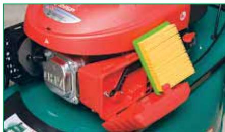
На косилке установлен двигатель под собственной торговой марки компании «Зубр». Воздушный фильтр — плоская прямоугольная «гармошка». С другой стороны корпуса расположен глушитель в металлическом корпусе, между мотором и глушителем установлена теплоизолирующая прокладка
