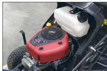
Под капотом находятся прозрачный топливный бак и двигатель Briggs&Stratton Intek (модель 31G7), одноцилиндровый, воздушного охлаждения, с чугунной гильзой цилиндра
