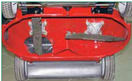
Дека стальная, крепится на алюминиевую раму. Узел передних колёс закреплён на деке отдельно от рамы. Отверстие для выброса травы назад закрыто мульчирующей заглушкой. Между задними колёсами видна шторка для защиты ног оператора от разлетающихся обрезков травы
