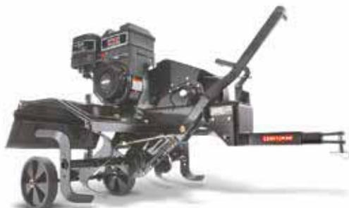
Садовые тракторы редко имеют валы или выходы гидросистемы для работы с задней «навеской». Но выход всегда можно найти: в данном случае прицепной культиватор оборудован собственным двигателем Briggs&Stratton
