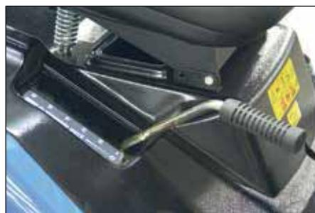
Высота скашивания регулируется рычагом, находящимся справа от оператора, аккумуляторная батарея располагается в нише под сиденьем
