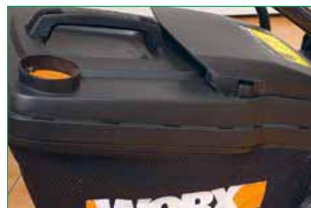
Комбинированный травосборник с рукояткой для переноски снабжён индикатором заполнения — круглым «флажком», задний дефлектор — с пазами для дополнительной фиксации травосборника
