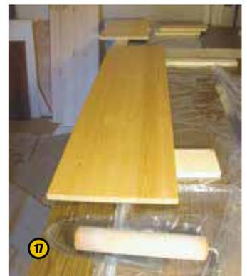
После лёгкой шлифовки наносим второй слой лака (16, 17).
