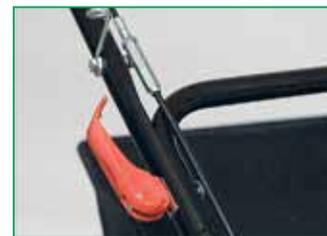
Верхняя часть рукоятки крепится на шарнирах с быстрозажимными фиксаторами и может складываться. Для регулировки тросов привода ножа и включения движения применяются муфты, в проволочной «петельке» закрепляется трос ручного стартера
