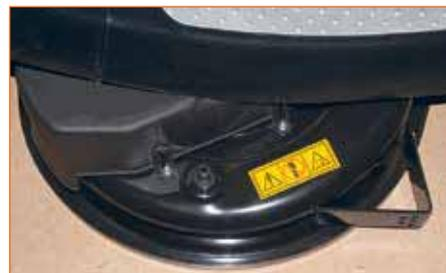
Двухножевая дека косилки имеет штуцер для подключения шланга с водой. На «уголки» в передних углах деки закрепляются поддерживающие колёса, предохраняющие её (и газон) от повреждений на неровных участках
