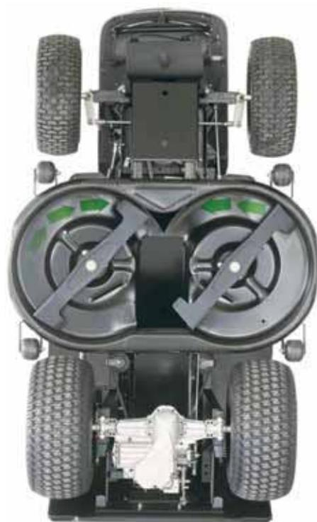
Трактор оборудован гидростатической трансмиссией и декой с двумя ножами и четырьмя поддерживающими колёсами. Ножи специальной S-образной формы рассчитаны на создание мощного воздушного потока
