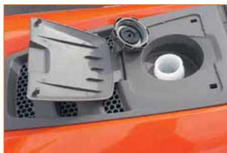
Топливный бак изготовлен из прозрачного пластика — для удобства контроля остатка топлива. Расположен под капотом. Чтобы залить бензин, капот поднимать не нужно: крышка бака находится под откидывающимся лючком на капоте
