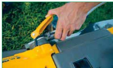
Все четыре шарнира на рукоятке управления — с кулачковыми зажимами. Для разблокировки достаточно просто повернуть рукоятку. Конструкция нижней пары зажимов (зубчатое зацепление) позволяет регулировать положение рукоятки по высоте и складывать её
