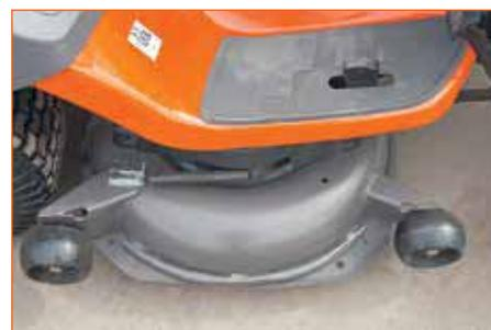
Двухножевая усиленная дека с подпружиненной заслонкой, перекрывающей выброс травы в травосборник для работы в режиме мульчирования. Управляют положением заслонки с места оператора, буквально в одно движение
