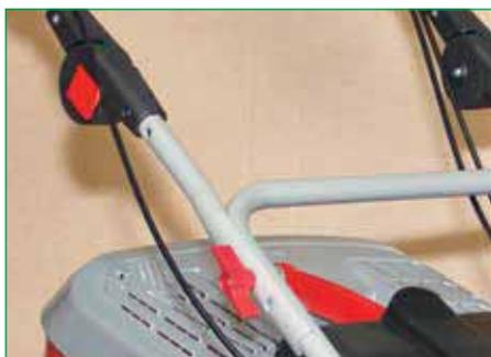
Рукоятку управления можно отрегулировать по высоте, установив болты шарниров в соответствующие отверстия. Верхний шарнир — особенность только моделей с вариатором: с его помощью регулируют наклон рукоятки
