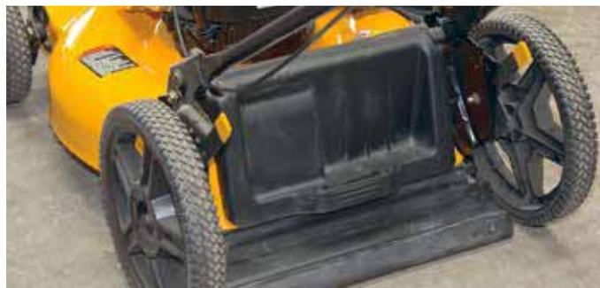
Каждое колесо косилки имеет собственный механизм регулировки высоты: так надёжнее при работе на неудобьях. Все детали механизмов стальные, ломаться и разбалтываться нечему. Ярко выраженный протектор — признак «внегазонного» применения
