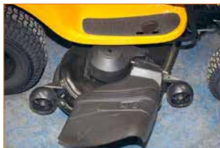
Основной режим работы этого трактора — боковой выброс: дефлектор для этого режима закреплён на деке. Оборудование для других режимов работы доступно опционально
