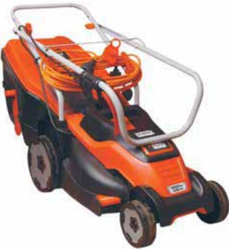
У небольших электрических косилок и мощность двигателя по сравнению с бензиновыми невелика. Из-за этого не удаётся обеспечить плотную укладку травы в травосборник. Как следствие, опорожнять его приходится чаще, чем хотелось бы. На этой модели в конструкцию травосборника включена перегородка: если трава заполнила весь объём, можно нажать на педаль, уплотнить собранные обрезки и продолжить работу.
