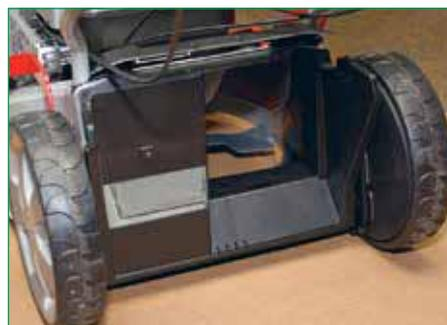
Форма канала выброса рассчитана так, что срезанная трава поступает в травосборник сверху и уплотняет нижние слои. На задней стенке виден люк для доступа к механизму привода сверху
