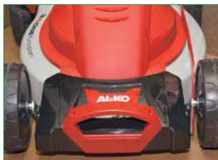
«Капот» косилки, прикрывающий переднюю ось, — пластмассовый. Он, как и ось, и рукоятка для переноски, смонтирован на стальном листе — передней части корпуса косилки
