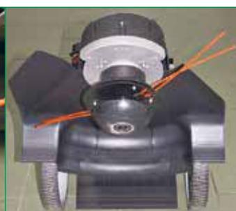
Отрезки лески складываются пополам и удерживаются в головке с помощью пружинных фиксаторов. Оператора от разлёта обрезков травы защищает пластиковый кожух
