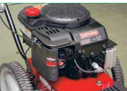
Двигатель Briggs & Stratton с пониженным выбросом вредных веществ оснащён праймером, воздушным фильтром автомобильного типа из гофрированной бумаги
