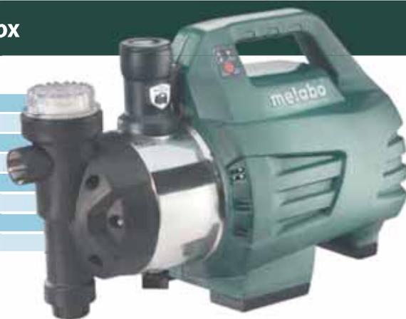
Такие насосы иногда называют напорными. Задача у них, как и у насосной станции, — поддерживать давление в системе в автоматическом режиме. Но при отсутствии гидроаккумулятора (при необходимости его можно приобрести и подключить отдельно) двигатель включается каждый раз, когда где-то открывают кран и в системе возникает расход воды. Управление осуществляется электроникой, конструкция предусматривает множество степеней защиты, аналогично насосным
