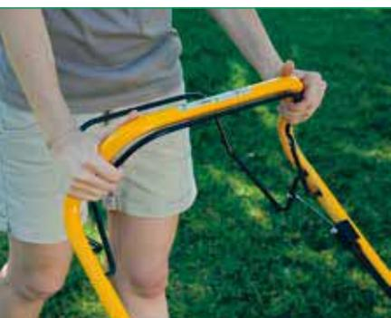
*Все косилки можно заводить только «издали», с места оператора, перед запуском необходимо прижать к рукоятке штангу и удерживать её всё время работы — при отпуске штанги двигатель останавливается. Вторая штанга служит для включения привода колёс*
