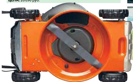
Дека косилки изготовлена из цельного стального листа методом штамповки. Такая конструкция обладает высокой жёсткостью и долговечностью, к тому же все элементы привода защищены от попадания грязи
