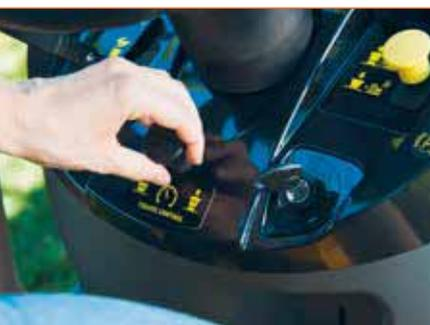
Кнопки круиз-контроля (чёрная) и электромагнитной муфты привода ножей (жёлтая). Эти функции включаются при поднятии кнопок. На фото также виден замок зажигания, клавиша включения фар, ниже, под замком, находится рычаг стояночного тормоза
