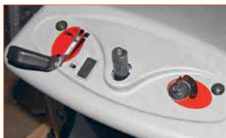
На подрулевой панели слева расположен рычаг установки оборотов двигателя, справа — замок зажигания (руль для наглядности снят)
