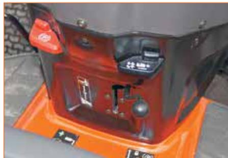
Под рулём расположены рычаги стояночного тормоза, стабилизатора скорости (круиз-контроль) и режима кошения. В верхнем положении рычага дека работает в режиме сбора скошенной травы в травосборник, при переводе рычага вниз заслонка на деке закрывается и производится мульчирование
