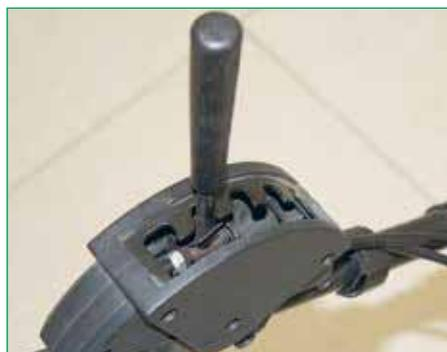
Оригинальная система регулировки высоты скашивания с тросовым управлением. Для изменения высоты рычаг на рукоятке немного поворачивают вбок и сдвигают вперёд или назад. В пазах «гребёнки» рычаг удерживается с помощью спиральной пружины
