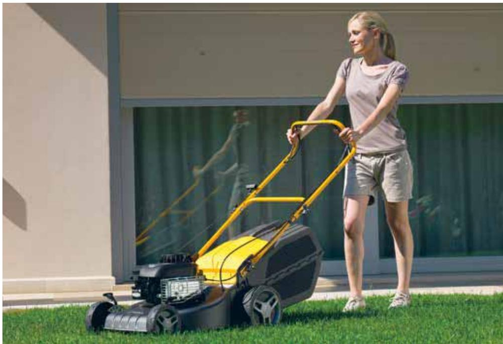
*Briggs&Stratton 450 Series — верхнеклапанный двигатель с нижним расположением топливного бака, праймером и поролоновым воздушным фильтром. Относится к числу «массовых» — недорогих, простых и надёжных*
