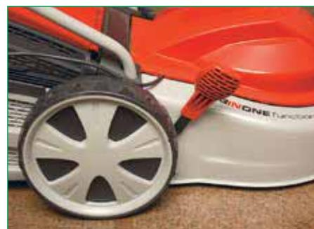
Рукоятка для централизованного изменения высоты скашивания. Дека тут стальная, косилка тяжелее небольших «пластмассовых» — и исполнен механизм соответствующее, «как на бензиновых»
