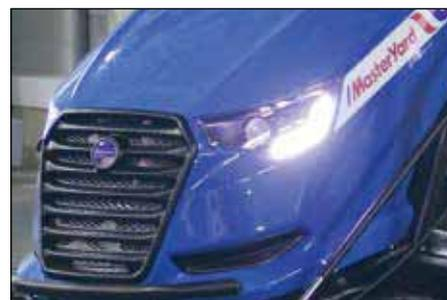
Светодиодная оптика, выполненная в стиле audi, придаёт трактору оригинальный вид, бампер защищает капот от возможных повреждений
