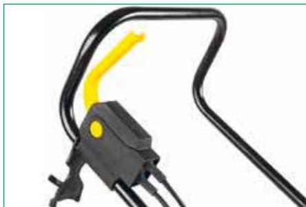
Мотор газонокосилки включается при прижатии рычага блока управления к рукоятке. Но предварительно, чтобы разблокировать рычаг, нужно нажать кнопку на блоке
