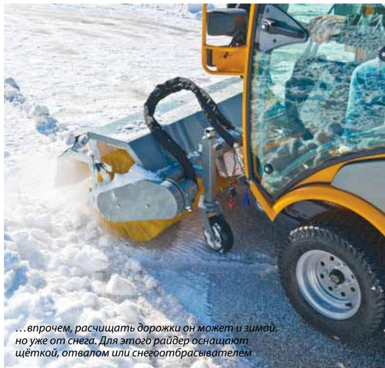
...впрочем, расчищать дорожки он может и зимой, но уже от снега. Для этого райдер оснащают щёткой, отвалом или снегоотбрасывателем
