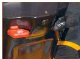
Два рычажка на рулевой колонке: слева — стояночного тормоза, справа — включения круиз-контроля. Принцип работы одинаков: при их нажатии педали тормоза и движения фиксируются
