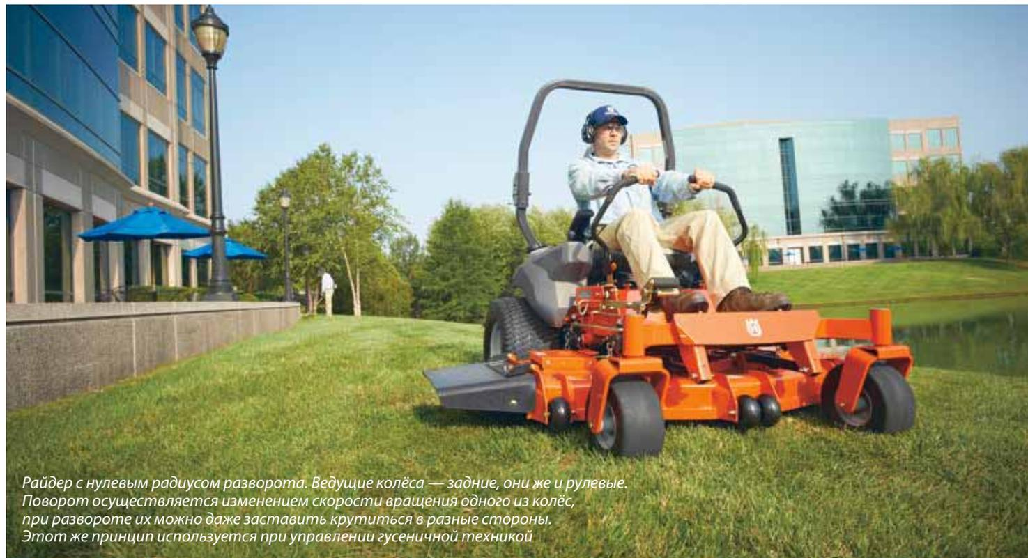
Райдер с нулевым радиусом разворота. Ведущие колёса — задние, они же и рулевые. Поворот осуществляется изменением скорости вращения одного из колёс, при развороте их можно даже заставить крутиться в разные стороны. Этот же принцип используется при управлении гусеничной техникой
