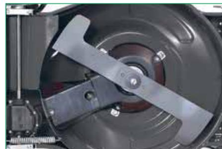
Нож газонокосилки — сложной формы, пригоден для мульчирования. Квадратный штамп на нём — признак оригинальной продукции Oleo-Mac. Ремённый привод ножа прикрыт защитными кожухами
