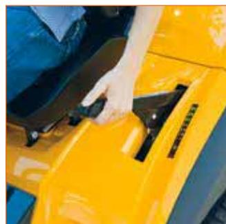
Для подъёма деки имеется рычаг с кнопкой-фиксатором на торце, по конструкции напоминающий автомобильный «ручник». На мини-тракторах такое решение применяется редко, хотя выглядит как минимум не хуже традиционной зубчатой «гребёнки»
