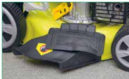
Косилка имеет возможность работы в четырёх режимах: сбора, мульчирования и выброса назад или вбок. На фото — установленный дефлектор бокового выброса, этот режим обычно используют для кошения высокой травы
