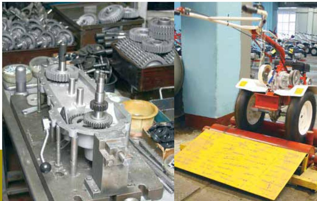
Завод им. Дегтярёва. Цех сборки редукторов (слева) и испытательный стенд для мотоблоков «Фаворит» (справа), где проверяется каждая выпущенная машина. Собственная съёмка редакции, 2009 год
