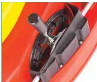
Механизм регулировки высоты выполнен отдельно от корпуса косилки, прикреплён к деке на винтах. Все элементы, работающие под нагрузкой, включая продольную тягу, — металлические
