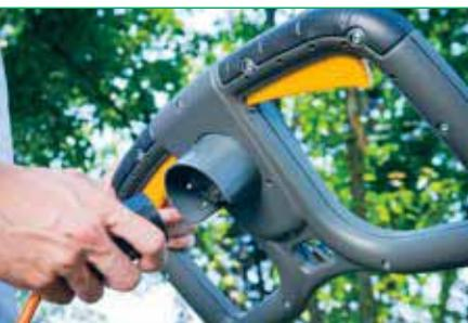
Вилка для подключения удлинителя находится на рукоятке, снизу, рядом с ней крючок для закрепления провода. Поперечная часть рукоятки полностью пластиковая, с дополнительными противоскользящими вставками рядом с клавишами пуска двигателя
