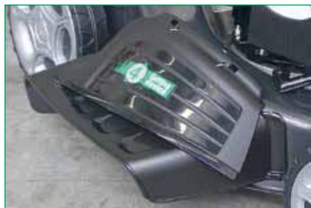
Для кошения высокой травы наиболее удобен режим бокового выброса: для этого поднимают расположенную сбоку на деке заглушку и устанавливают входящий в комплект дефлектор. Травосборник, разумеется, снимается
