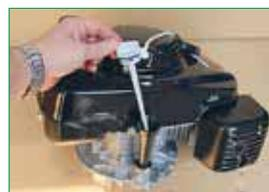
Проверка уровня масла — первое, что нужно проводить перед каждым запуском двигателя. Через эту же горловину масло сливают при замене: использовать болт на нижней части мотора мешает дека косилки
