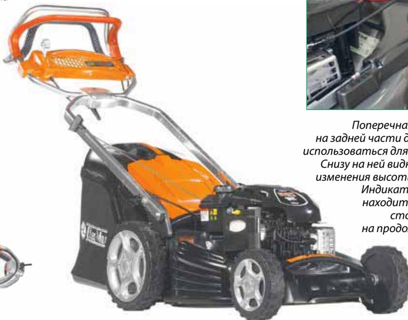
Переднюю часть газонокосилки защищает от ударов небольшой стальной бампер. Для переноски косилки в одиночку можно удерживать её за переднюю и заднюю поперечные рукоятки на деке. Передняя рукоятка пригодится и при переноске вдвоём
