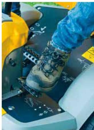
Педаль для управления движением райдера. С левой стороны — педаль тормоза с её фиксатором (на рулевой колонке). Справа — одна «качающаяся» педаль для выбора скорости и направления движения
