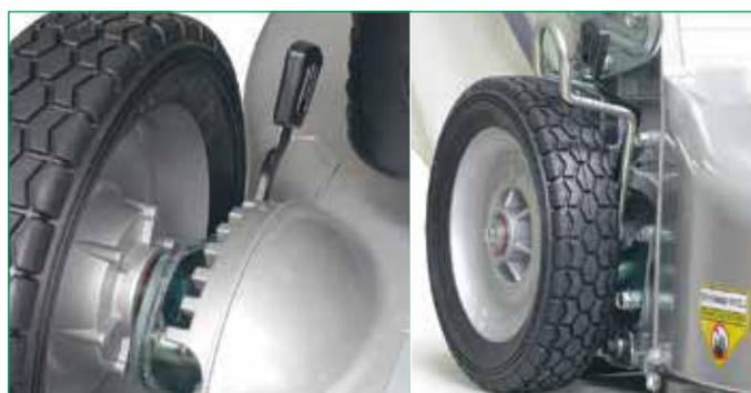
Каждое колесо — с двумя шарикоподшипниками и отдельным рычагом регулировки высоты. Диски колёс, как и дека, отлиты из алюминиевого сплава. Ограждение рычагов задней пары колёс — для удобства регулировки, также видна «растяжка», обеспечивающая жёсткость крепления рукоятки
