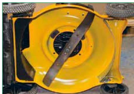
Стальная дека, к которой на болтах с гайками крепятся остальные элементы. Передняя перегородка, ограждающая зону вращения ножа, стальная. Задняя, с окном для выброса травы, пластиковая
