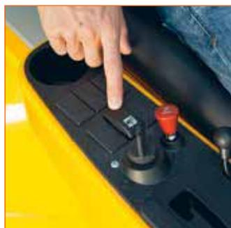
Четырёхпозиционный замок зажигания с ключом, вытяжная рукоятка воздушной заслонки и клавиша для плавного изменения высоты скашивания (управляет отдельным электродвигателем на деке). «Замыкает» панель ниша — «подстаканник»
