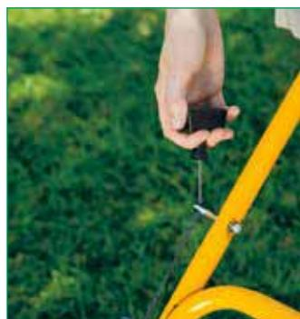
*Рукоятка ручного стартера, вынесенная к оператору: не только удобство, но и мера предосторожности. Рукоятку самой газонокосилки при хранении можно сложить пополам, ослабив «барашки», или вовсе снять, отсоединив тросы управления и запуска двигателя*
