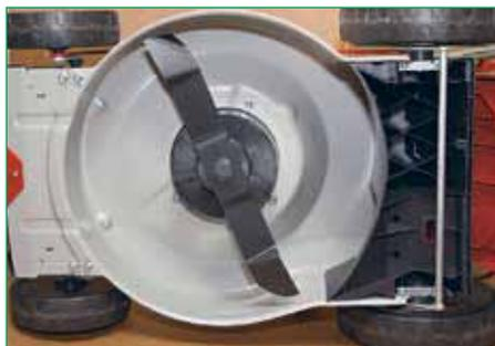
Передняя ось косилки прикрыта стальным листом, отштампованным вместе с декой, задняя ось «открыта», поперечная полукруглая задняя перегородка выполнена из пластмассы. Нож пригоден для мульчирования
