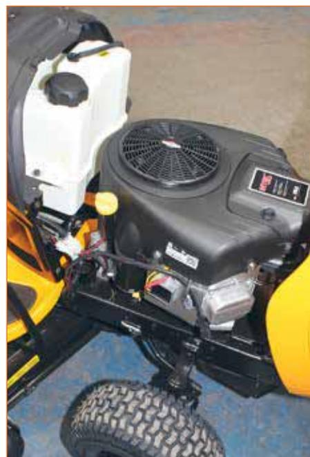
Под капотом установлен двигатель Briggs&Stratton (на соседних в линейке тракторах ставится почти такой же, но другой мощности) и прозрачный топливный бак
