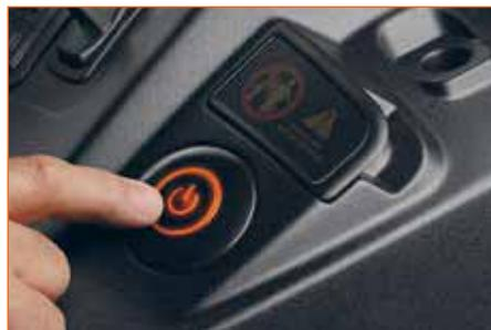
Вместо ключа установлена кнопка запуска двигателя. Для предотвращения несанкционированного пуска используется съёмный чип — небольшая пластинка, находящаяся выше кнопки запуска
