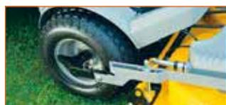
Косильная дека и многие другие виды дополнительного оборудования крепятся к райдеру на оси колёс (система быстрой установки RAC Connection)
