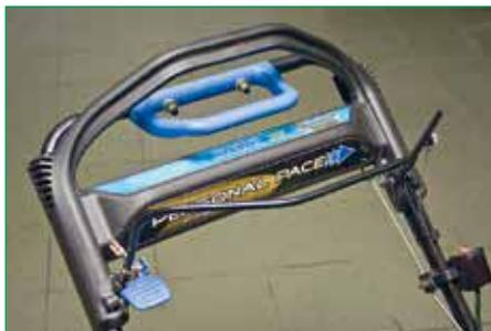
Подпружиненная рукоятка привода, при нажатии на которую косилка начинает двигаться вперёд. При маневрировании можно держаться за дополнительную, «стационарную» рукоятку. Штанга привода ножей снабжена фиксатором от случайного нажатия (синий рычажок). Выключатель двигателя вынесен к оператору
