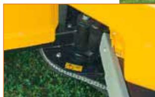
Шарнирный механизм с цепным приводом, соединяющий переднюю и заднюю части райдера
