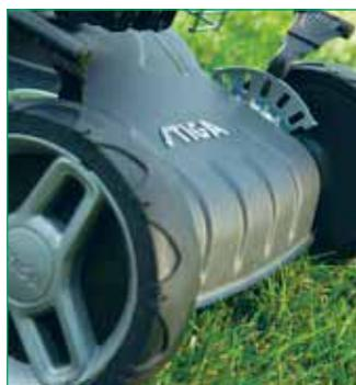
*Для изменения высоты скашивания применена упрощённая система: передние колёса имеют независимую друг от друга и от задней пары колёс регулировку. Колёса на всех осях установлены на шарикоподшипниках*
