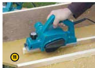
ные поверхности доски (10) и бруска (11) желательно строгануть рубанком для плотного прилегания без щели. Используя боковины, настраиваем дисковую пилу — задаём нужный угол наклона диска (12). Учтите, что при этом ориентировочные выступы на по-
