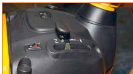
Слева на рулевой колонке находятся рычаг управления оборотами двигателя и кнопка включения фар. Справа — замок зажигания и кнопка включения привода деки. Посередине — счётчик моточасов
