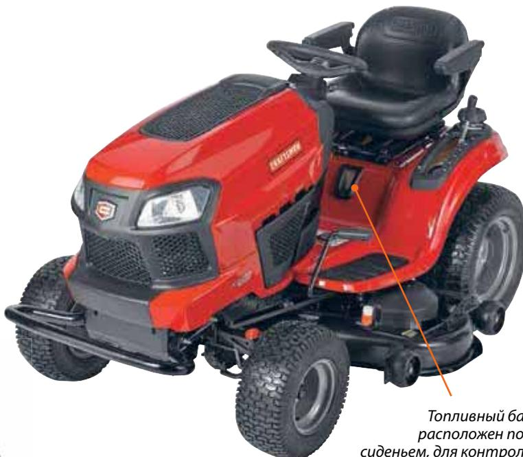
Топливный бак расположен под сиденьем, для контроля уровня имеется прозрачное окошко. Заливная горловина находится на правом заднем крыле
