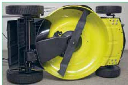
Особенности конструкции деки: стальной штампованный корпус с закрытой передней осью, сзади установлена полукруглая пластиковая вставка, отлитая заодно с кожухом ремня привода на задние колёса
