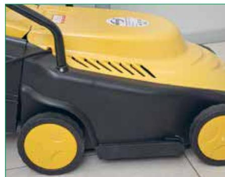
Небольшие «гребёнки» на наружной части деки, за передними колёсами, нужны для того, чтобы выравнивать и направлять траву к ножу. «Задние крылья» и «пороги» — не только дань дизайну, но ещё и элементы, обеспечивающие жёсткость корпуса
