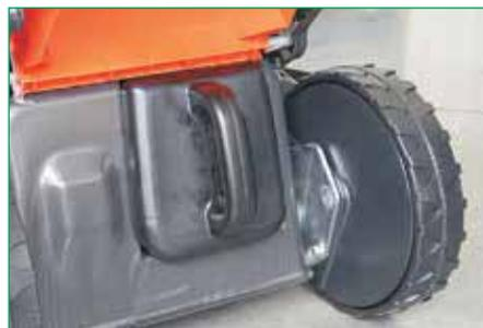
Для работы в режиме мульчирования канал для выброса травы перекрывают специальным вкладышем — заглушкой. Для удобства заглушка снабжена ручкой
