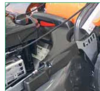
Поперечная рукоятка на задней части деки может использоваться для переноски. Снизу на ней видна клавиша изменения высоты срезания. Индикатор высоты находится с правой стороны деки, на продольной тяге
