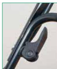
Один из двух эксцентриковых фиксаторов, позволяющих быстро сложить рукоятку для компактного хранения газонокосилки
