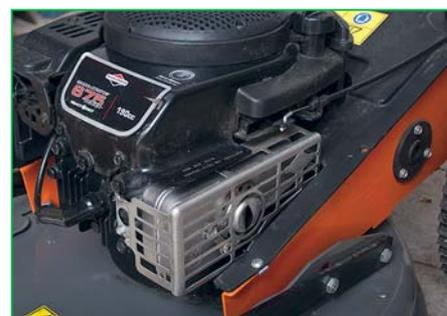
Двигатель Briggs&Stratton 675 Series с системой Ready Start. Такой двигатель не требует никаких манипуляций, связанных с подкачкой топлива и управлением воздушной заслонкой. Мало того, компания Briggs&Stratton гарантирует запуск подобных моторов не более чем со второго рывка стартера
