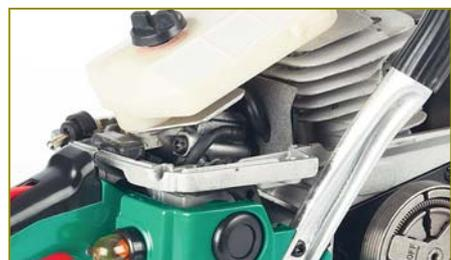
Пластиковый воздушный фильтр — коробочка с закреплённой на нём сеткой — устанавливается прямо на карбюратор и прижимается к нему барашковой гайкой, которая заодно крепит верхнюю крышку корпуса. Инструмент для доступа к фильтру не нужен
