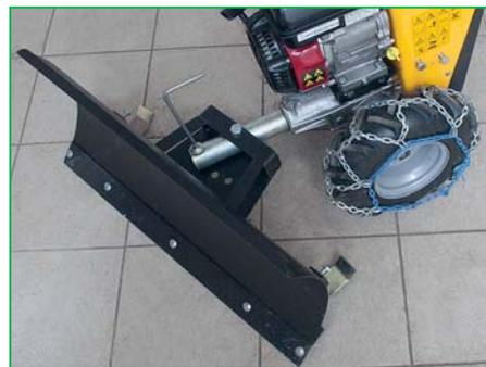
На сенокосилку вместо ножей можно поставить снежный отвал с простой регулировкой угла поворота. Для работы в этом режиме на колёса надо установить цепи противоскольжения
