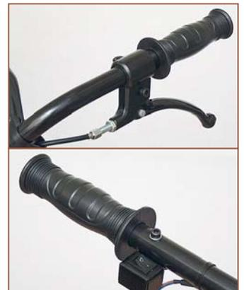
На левой рукоятке расположен рычаг привода сцепления, на правой — выключатель двигателя. Для компактного хранения рукоятку можно разобрать на отдельные элементы
