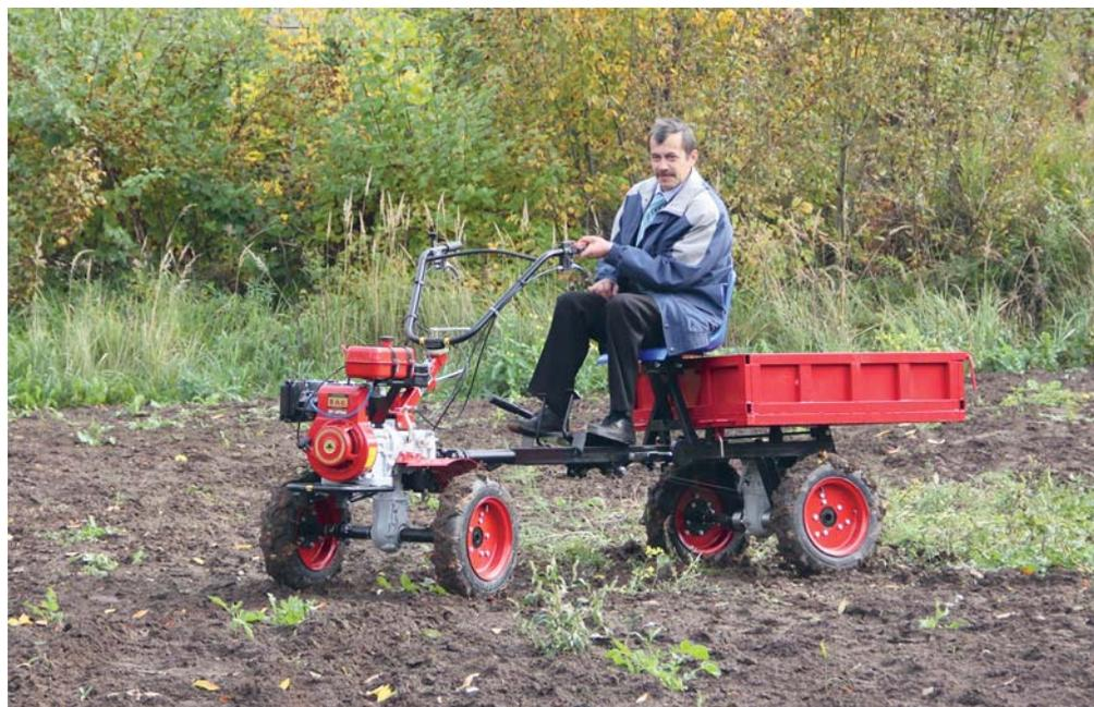
**МОТОКУЛЬТИВАТОРЫ с раздельными приводами на колёса и фрезы**
