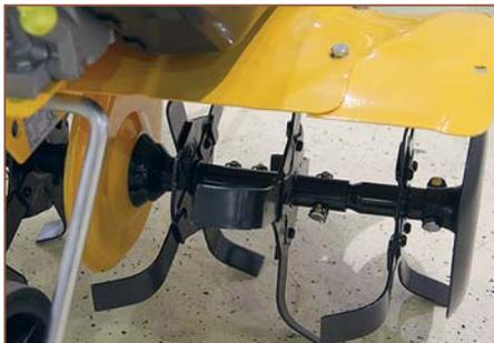
Культиватор с установленными почвофрезами, защитными дисками и щитками. Стальные пальцы для соединения фрез — легкосъёмные, с проволочными защёлками, наож соединяются с фланцами на заклёпках
