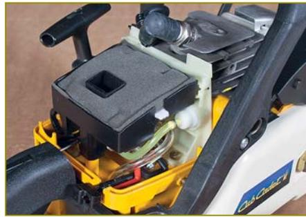
Воздух подаётся к карбюратору от крыльчатки маховика по специальному каналу (в центре корпуса фильтра). На собранной пиле воздушный фильтр прижимается по периметру выступами на верхней крышке
