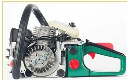
Пила со снятыми крышкой стартера и кожухом. Хорошо видны кулачки на маховике и канал на корпусе, по которому воздух подаётся от крыльчатки маховика к цилиндру двигателя и воздушному фильтру. Под чёрными круглыми «пробками» находятся крепления пружин антивибрационной системы
