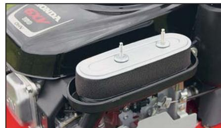
*Воздушный фильтр двухступенчатый: первый слой поролоновый, дальше идёт специальная гофрированная бумага. Для замены фильтра инструмент не нужен*
