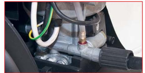
Поскольку мойка укомплектована барабаном, шлангов высокого давления два: первый подключается между выпускным штуцером и барабаном. К штуцеру также подходит прозрачный шланг для моющей жидкости
