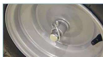
Правое (со стороны оператора) колесо крепится на оси с помощью съёмного штифта с кольцом. При транспортировке и лёгких условиях работы штифт переставляют на ось, отсоединяя колесо от привода. На левой стороне колесо крепится жёстко: вместо штифта там стоит болт с гайкой
