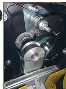
Привод культиватора. Крутящий момент от вала двигателя передаётся к червяку с помощью ременного сцепления. При включении переднего хода работает ремень, установленный на светлом алюминиевом шкиве, для движения назад задействуется шестерня заднего хода со шкивом меньшего диаметра (скорость заднего хода меньше)
