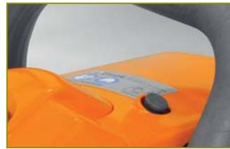
Крышка, закрывающая доступ к фильтру и свече зажигания, снимается без помощи инструмента
