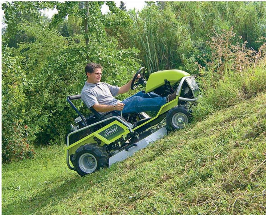
гут сильно различаться, но результат один: высота кошения изменяется в широких пределах, прямо с места оператора, дека и нож при этом остаются параллельно земле. Форма деки у таких моделей — либо круг, либо полукруг, двигатель крепится на самой деке.
