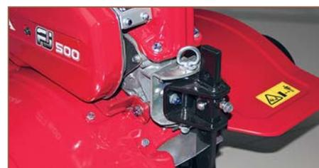
Задняя сцепка для крепления прицепа оборудования. Крепёжный палец — с пружинным фиксатором снизу. Сошник составной: толстая стальная пластина с пятью отверстиями для быстрой регулировки высоты, к которой крепится штырь самого сошника
