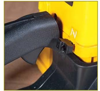
В середине рычага воздушной заслонки имеется штифт половинного закрытия. Вытягиваются они совместно, при убирании рычага штифт остаётся вытянут, в таком положении двигатель можно прогреть. Заслонка автоматически откроется полностью при нажатии на газ
