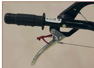
Рычаг сцепления на правой рукоятке снабжён блокировкой — дополнительным рычажком внутри основного. Оригинально исполнен верхний рычаг для переключения направления движения
