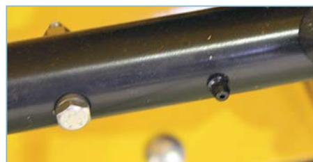
Предохранительный срезной болт и маслёнка для подачи смазки к оси шнека
