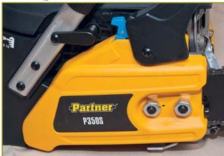
Фронтальный механизм натяжителя (винт) и щиток тормоза закреплены на боковой крышке
