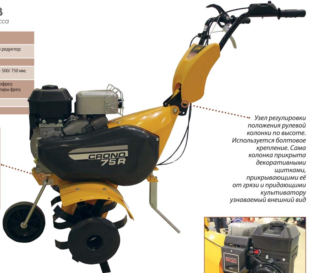
Узел регулировки положения рулевой колонки по высоте. Используется болтовое крепление. Сама колонка прикрыта декоративными щитками, прикрывающими её от грязи и придающими культиватору узнаваемый внешний вид
