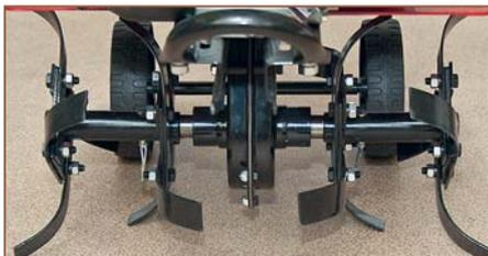
Ножи фрез закреплены на болтах. Редуктор в стальном корпусе, цепной необслуживаемый
