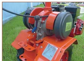
Мотоблок оборудован шестерёнчатым редуктором с двумя передними и одной задней передачами, переключаемыми с помощью рукоятки. Картер разборный, алюминиевый
