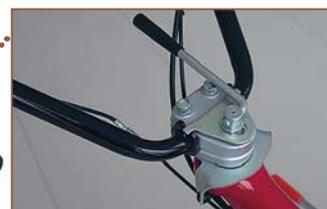
Узел крепления рукоятки управления к штанге культиватора. Отвернув фиксатор, рукоятку можно складывать, регулировать по высоте и поворачивать относительно продольной оси
