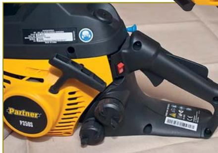
Крышки бачков для топлива и масла расположены рядом, у задней рукоятки. Для выключения двигателя используется клавиша
