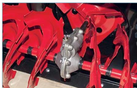
Первая ступень — три пары независимых «агрессивных» шнеков, закреплённых на общей оси срезными штифтами, вторая — крыльчатка с тремя лопастями, крепящаяся на оси червяка редуктора
