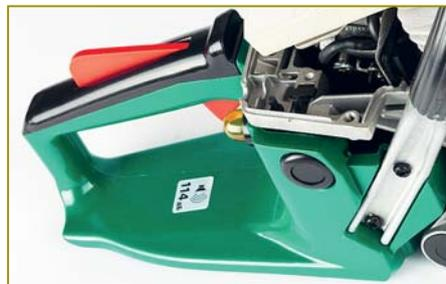
Помимо цепеуловителя и переднего тормозного щитка, цепные пилы имеют ещё одно «устройство безопасности». Форма нижней части задней ручки такова, что при соскакивании или разрыве цепи её касание с рукой исключается даже в теории
