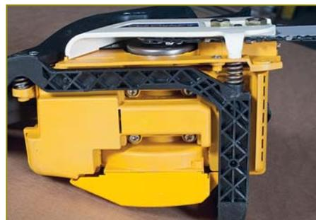
Вид снизу. Цепеуловитель отлит совместно с боковой крышкой, ведущая звёздочка — «наружного» типа. Передняя и задняя рукоятки составляют единый узел, корпус с двигателем крепится к ним через многоточечную antivибрационную систему
