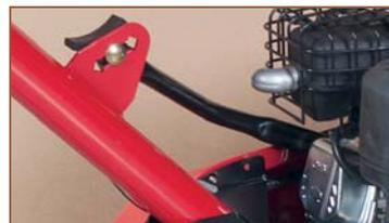
Узел изменения угла наклона (и одновременно высоты) рулевой колонки рассчитан на высокие нагрузки. Колонка может быть установлена в трёх положениях. Стальная растяжка исключает возможность «разбалтывания»
