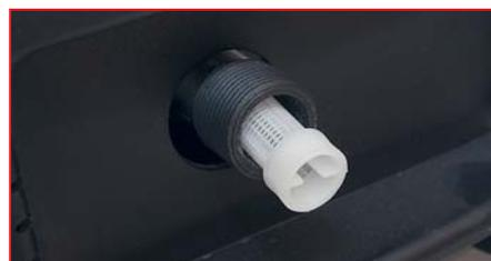
Шланг для подачи воды подключается в нижней части мойки, сзади. Между штуцером на мойке и переходником для подключения шланга (на фото снят) устанавливается заборный фильтр для очистки воды от механических примесей
