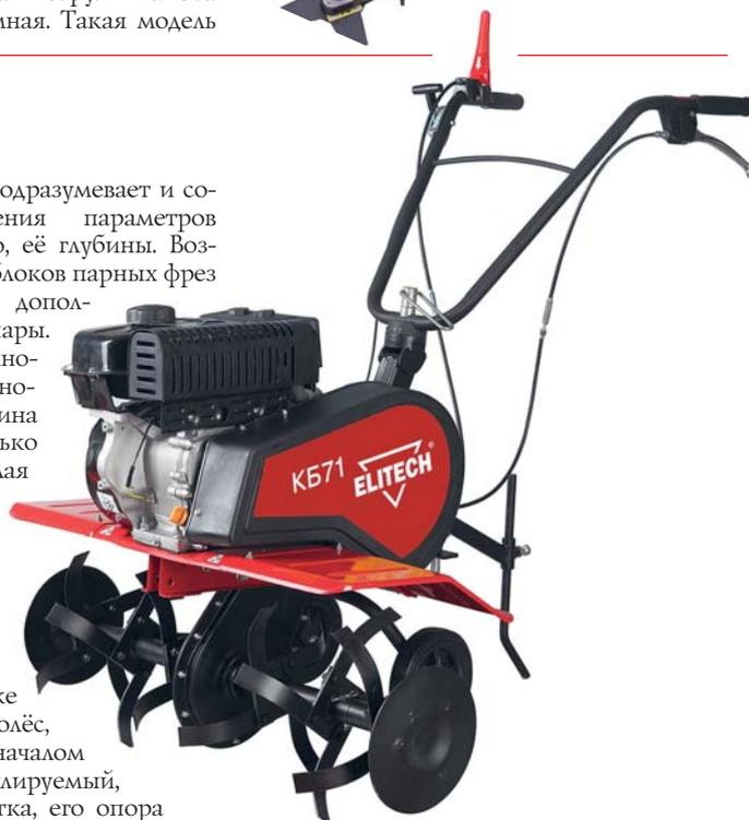
Elitech: плуг, окучник, картофелевыкапыватель. Для работы с ними используется универсальное сцепное устройство, а фрезы меняются на грунтозацепы.
