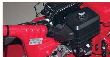
Забор воздуха в карбюратор производится через рукоятку культиватора, соединённую гофрированным рукавом с крышкой корпуса фильтра
