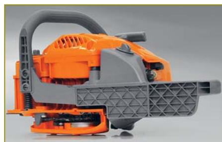
В принципе любая бензопила состоит из двух виброизолированных частей, а вот отличий в исполнении у разных производителей много. Здесь передняя и задняя рукоятки представляют собой единый узел, в который также входит топливный бак и система праймера. Виброизоляция комбинированная — пружины и резиновые амортизаторы
