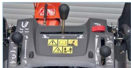
Панель управления снегоотбрасывателя с рычагами для поворота дефлектора (сверху), изменения наклона козырька дефлектора (слева), управления скоростью и направлением перемещения (справа). Красной клавишей включается подогрев рукояток
