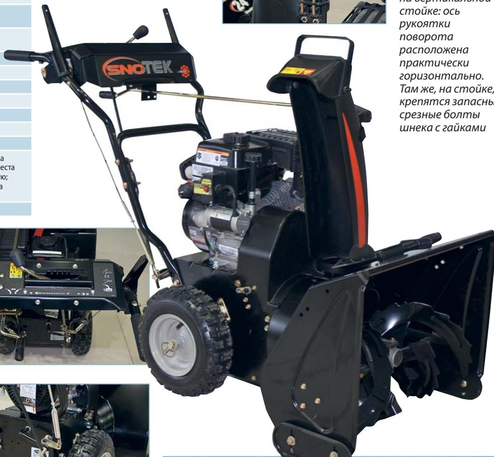
Панель управления. Посередине — рукоятка для выбора передач, под ней — вращающаяся ручка для поворота дефлектора. На осевой рукоятке — рычаг привода колёс, на правой — привод шнека
