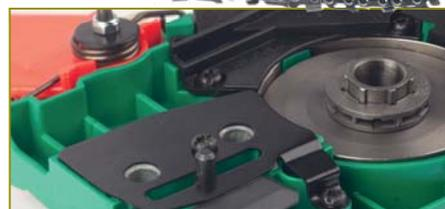
Натяжной механизм и механизм торможения устанавливаются в боковой крышке. Тормозная лента на собранной пиле охватывает наружную поверхность муфты сцепления и зажимает её при срабатывании тормозной системы или нажатии на рычаг. Ведущая звёздочка на этой модели — сменная, она, как и муфта сцепления, для наглядности снята с пилы
