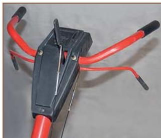
Модель легко узнать по особенностям конструкции рулевой колонки и органов управления культиватором. К оператору вынесены не только рычаги сцепления и заднего хода, но и узлы регулировки натяжения тросов
