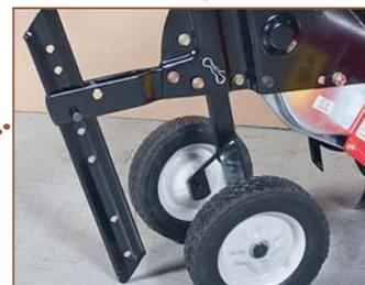
Конструкция заднего сцепного узла позволяет крепить различное оборудование. Например, если снять колёсный узел, на освободившееся место можно переставить сошник, поставить плуг или аналогичную «навеску», причём благодаря большой площади контакта нагрузка на соединение минимальна
