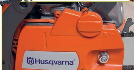
Боковая крышка фиксируется одной гайкой. Также виден винт натяжителя. Можно обратить внимание на форму верхней части крышки. Под ней — детали тормозного механизма «фирменной», не встречающейся на других марках конструкции
