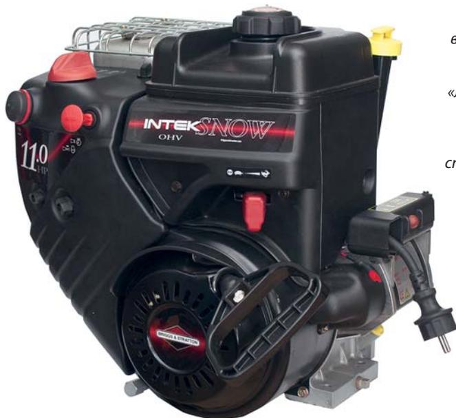
На этом моторе можно увидеть два варианта исполнения маслозаливных горловин и пробок (или крышек). Внизу — более характерный для «летних» моторов: небольшая пробка вставляется или вкручивается в алюминиевую крышку картера (пробок там две, но вторая, с другой стороны, почти не видна). Крышку для заливки масла на «зимних» моторах выводят выше и снабжают длинным цупом из металлической ленты для контроля уровня масла
