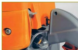
Управление зажиганием и положением воздушной заслонки двигателя — с помощью единственного рычажка. Для облегчения холодного запуска имеет праймер, кнопка которого расположена неподалёку от топливного бака, почти вплотную к задней рукоятке
