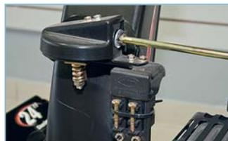
Механизм поворота дефлектора закреплён на вертикальной стойке: ось рукоятки поворота расположена практически горизонтально. Там же, на стойке, крепятся запасные срезные болты шнека с гайками
