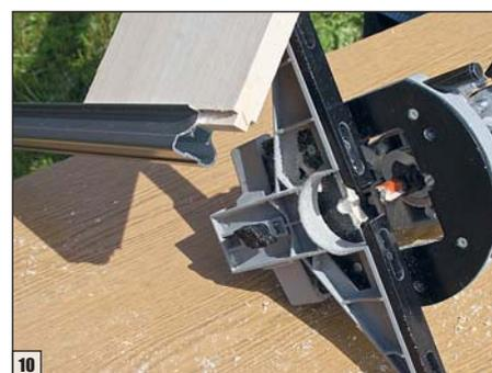
Точный выбор «четвертей» выполнен фрезером «Интерскол». Но сначала фрезер с параллельным упором и цилиндрической фрезой надо настроить (9). Поперечина должна плотно входить в паз ручки 10x8 мм (10).
