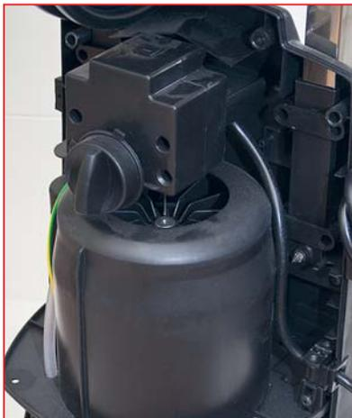
Выключатель поворотного типа
