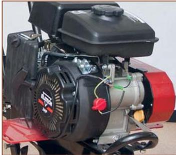
Четырёхтактный двигатель Elitech. Материал воздушного фильтра — поролон, для доступа к нему инструмент не нужен. Пусковой механизм с катушкой большого диаметра уменьшает усилие, требуемое для запуска
