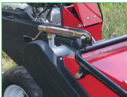
Механизм плавной регулировки высоты скашивания
