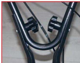
Трубчатые элементы нижней части рулевой колонки у Texas Lilli согнуты после термообработки. Обеспечено лучшее сопряжение с верхней частью руля, жёсткость конструкции выше, вероятность разбалтывания ниже
