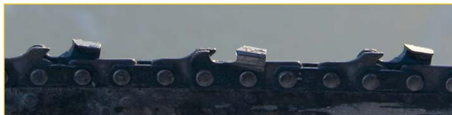
Бензопила — хорошо известная Stihl MS 180, лёгкая модель бытового класса. Цепь тоже обычная, вся её доводка «под лёд» заключается в уменьшении высоты ограничителей глубины пропила (выкидных зубьев). Их стачивают плоским напильником
