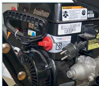
Рукоятка вытяжного ручного стартера, топливный кран, вилка для подключения к электросети и кнопка запуска стартера
