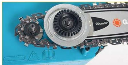
Часть натяжного устройства закреплена прямо на шине. Предварительно цепь натягивается без установки крышки
