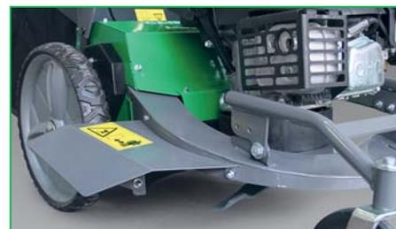
Для окашивания высокой травы есть кардинальное решение — кожух деки снимают и устанавливают дефлектор бокового выброса
