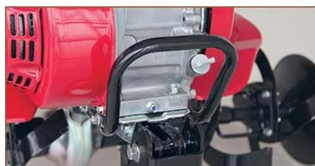
Для переноски модели вдвоём спереди предусмотрена рукоятка. Пробки для слива и контроля уровня масла находятся на передней части культиватора. Проверить масло в механизме переключения передач тоже просто: доступ к пробке не доставит затруднений
