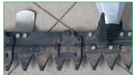
На середине подвижного ножа деки крепится разделитель скошенной травы, обеспечивающий равномерность её укладки. Высота кошения зависит от положения опорных башмаков относительно планки контрножа. При креплении башмаков с нижней стороны, как на фото, высота больше, если их снять и переставить на верхнюю сторону, высота кошения уменьшится
