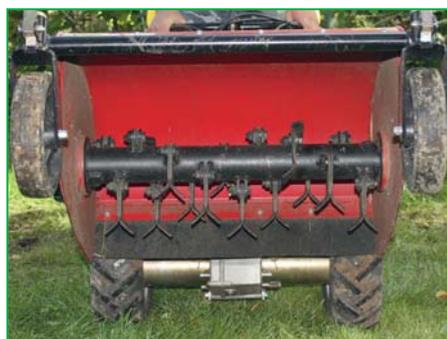
Ротор косилки — вал с 16 парами «плавающих» стальных ножей
