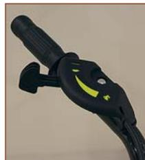
На левой рукоятке находится рычаг регулировки оборотов двигателя
