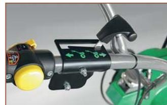
Важнейшее отличие культиватора от большинства представленных на рынке моделей — пневматическое управление сцеплением: клавиша вместо традиционного рычага на правой рукоятке. Рычажок сверху — блокировка от случайного нажатия, для остановки двигателя используется поворотный рычажок
