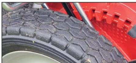
*Колёса достаточно широкие и гладкие, чтобы не мять траву даже при полной загрузке. Рисунок протектора обеспечивает движение без пробуксовок*
