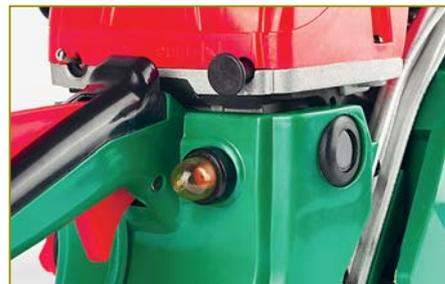
Органы управления: рычаг с клавишей блокировки от случайного нажатия, справа от него — топливоподкачивающий насос (праймер) и вытяжной рычажок воздушной заслонки, слева виден тумблер выключателя зажигания
