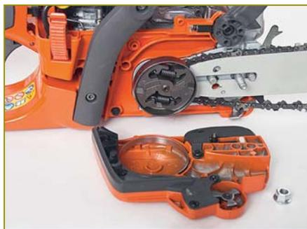
Механизмы натяжителя и тормоза (за исключением щитка тормоза) крепятся на боковой крышке. Узел соединения щитка тормоза и прочих элементов механизма тормоза — три выступа на оси щитка и стальная «звёздочка» на крышке. Шина удерживается от поворота с помощью двух штифтов, сцепление двухкулачковое, с двумя пружинами
