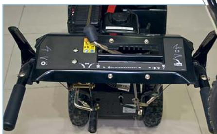
Тросы и тяги приводов между панелью управления и соответствующими механизмами снегоотбрасывателя. На правом колесе виден штифт разблокировки
