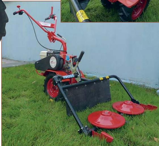
Мотоблок в сборе с одним из множества видов навесного оборудования — роторной косилкой
