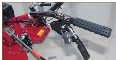
Рычаг включения привода сцепления с устройством безопасности, предотвращающим случайное нажатие рычага. На перемычке между рукоятками находится рычажок включения зажигания. Примечательно, что положений для выключения два — для того чтобы заглушить двигатель, можно повернуть рычажок в любую сторону
