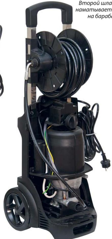
Мойка со снятым кожухом. Основные элементы под ним — индукционный электродвигатель и водяной насос, подающий воду к моющему пистолету
