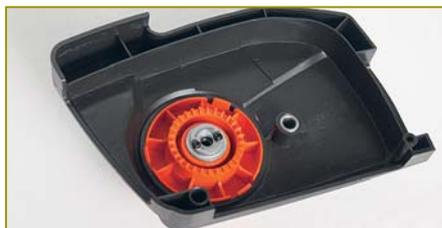
Вид на натяжной элемент с внутренней стороны крышки
