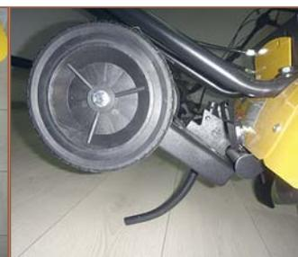
Подножка транспортировочных колёс закреплена на оси, поднять и опустить колёса в процессе работы удобнее всего ногой. Собственно, именно на ножное управление фиксирующим рычагом этот узел и рассчитан. Сошник, закреплённый перпендикулярно подножке, опускается при её поднимании
