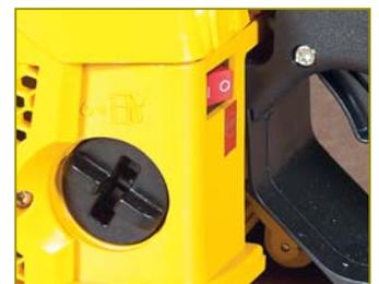
Для включения зажигания используется клавиша. Крышки бачков выполнены заподлицо с корпусом, отвернуть их можно не только руками, но и отвёрткой, пользуясь ей как рычагом
