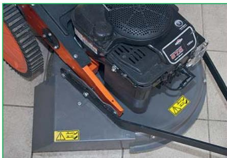
На этом фото видна конструкция подвески режущей деки, а также установленные на неё боковой и передний дефлекторы. Козырёк на стальном боковом дефлекторе направляет остатки срезанной растительности вниз (у традиционных газонокосилок, предназначенных для кошения мягкой травы, подобный козырёк не предусмотрен)
