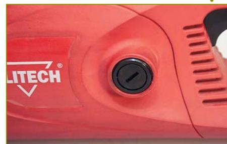
На пиле установлен щёточный электродвигатель. Процесс ревизии и смены щёток достаточно прост
