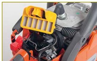
Воздух подаётся крыльчаткой маховика по специальному каналу и затем проходит через нетканый элемент фильтра
