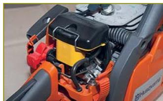
Снять воздушный фильтр в чёрно-жёлтом корпусе несложно, он крепится одной проволоочной защёлкой. А вот его конструкция довольно интересна
