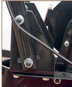
Рукоятка управления имеет возможность регулировки угла наклона, а следовательно, высоты ручек
