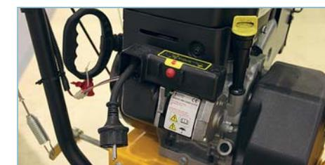
Двигатель оборудован встроенным электрическим стартёром с запуском от сети. Обычно такой стартёр задействуют в начале работы, а для пуска прогретого двигателя используют ручной стартёр
