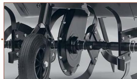
Узкий цепной разборный обслуживаемый редуктор создаёт минимальное сопротивление при работе. Фрезы из закалённой стали собраны на заклёпках и крепятся с помощью пальцев с «нетеряющимися» защёлками
