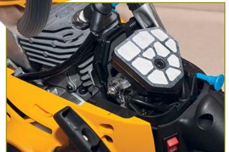
Воздушный фильтр с нетканым фильтрующим элементом. Перегородка, отделяющая двигатель от карбюратора, отлита совместно с верхней крышкой
