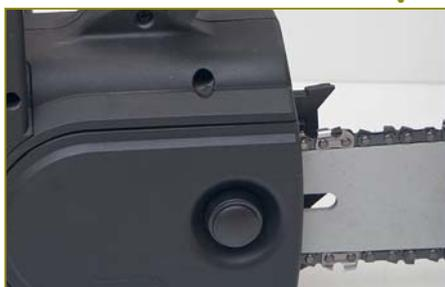
Заглушка на гайке крепления боковой крышки защищает грани гайки от опилок. При отворачивании гайки ключ «сядет» на грани ровно, без перекосов
