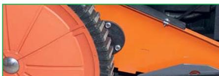
Большие колёса облегчают передвижение по пересечённой местности. На раме виден чёрный фланец подшипника вала редуктора
