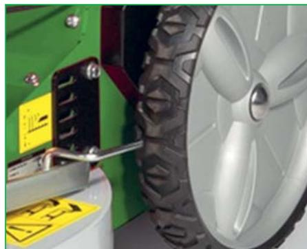
Большие задние колёса облегчают перемещение по пересечённой местности. Рядом с задним правым колесом находится рукоятка регулятора высоты кошения и её фиксатор — стальная пластина с шестью отверстиями
