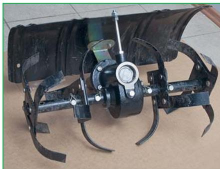
Весной и осенью сенокосилку можно использовать в качестве культиватора, установив соответствующий навесной аксессуар. Такая компоновка характерна для некоторых мотоблоков: фрезы приводятся в движение от вала отбора мощности, колёса при этом не снимают
