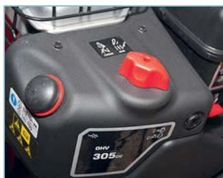
Органы управления, расположенные на двигателе с левой стороны снегоотбрасывателя: праймер и поворотный рычаг воздушной заслонки. Ниже видно отверстие для установки ключа безопасности
