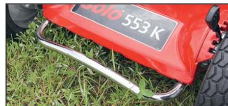
*Передний бампер, который может использоваться как дополнительная рукоятка — очень удобен при погрузке косилки в автомобиль*
