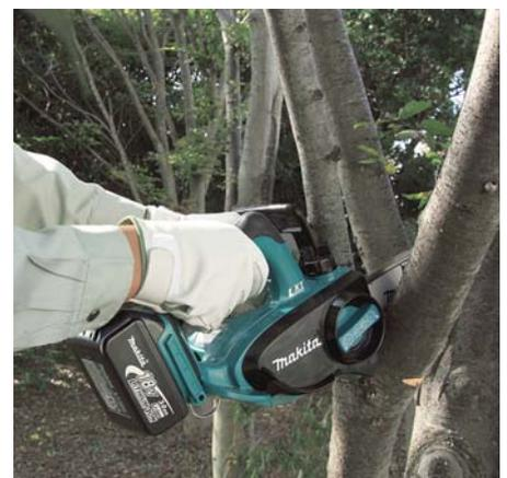
**АККУМУЛЯТОР:** съёмный Li-Ion; напряжение — 18 В; ёмкость — 3,0 А\*ч; время зарядки — 22 мин
