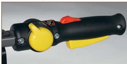
На левой рукоятке находится рычаг управления топливной заслонкой двигателя
