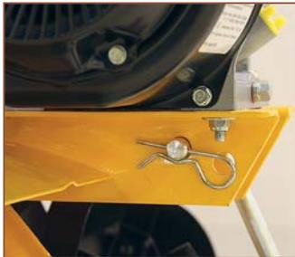
Стойка переднего транспортировочного колеса крепится на раме с помощью проволочного фиксатора. С другой стороны относительно рамы к стойке приварен металлический упор (он виден на центральной фотографии)
