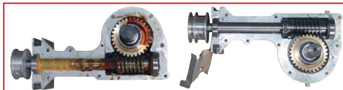
Редуктор культиватора Texas Hobby (слева) заранее смазан и не требует предпродажной подготовки. Зато на «аналоге» можно увидеть небольшой дополнительный подшипник на валу. Спорное решение: в данном случае подшипник лишь снижает нагрузки из-за увеличенного люфта в зацеплении и менее качественной обработки шестерни. Такая конструкция использовалась ранее на Texas и впоследствии была усовершенствована
