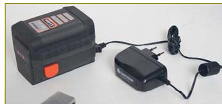
Если же двигатель остановился, а светодиод не горит — требуется зарядка. Портативное зарядное устройство подключается прямо к аккумулятору. Время полной зарядки разряженной «в ноль» батареи — не более трёх часов
