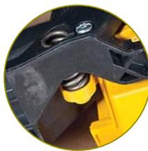
Винты крепления пружин легкодоступны (один виден снаружи, головка второго находится внутри пружины). Оценить и проверить их натяжку, а также при необходимости подтянуть, можно и не разбирая пилы
