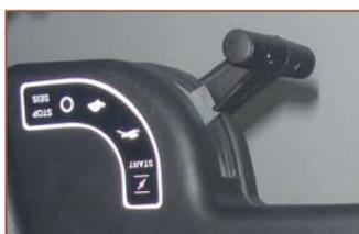
Механизм T-образного рычага управления дроссельной заслонкой двигателя смонтирован на поперечной панели, между рукоятками культиватора
