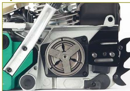
Трёхкулачковое сцепление «наружного» типа, ведущая звёздочка расположена за ним. Зубчатый упор крепится к корпусу на винтах, цепеуловитель сменный, пластиковый
