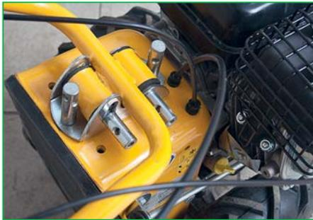
Рычаг включения привода ножей установлен с правой стороны и присоединён к редуктору. Для включения привода рычаг сдвигается «от себя»
