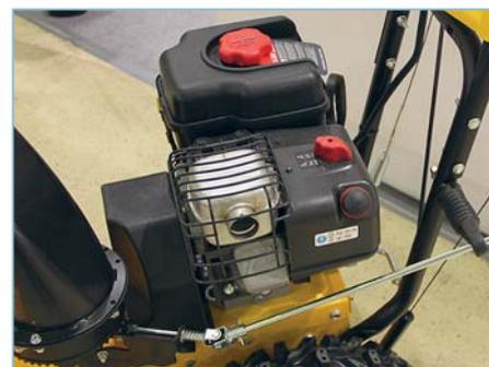
Двигатели Briggs&Stratton «зимних» серий отличаются увеличенным размером органов управления для удобства работы в перчатках. Рукоятка регулировки угла поворота дефлектора — с карданной передачей
