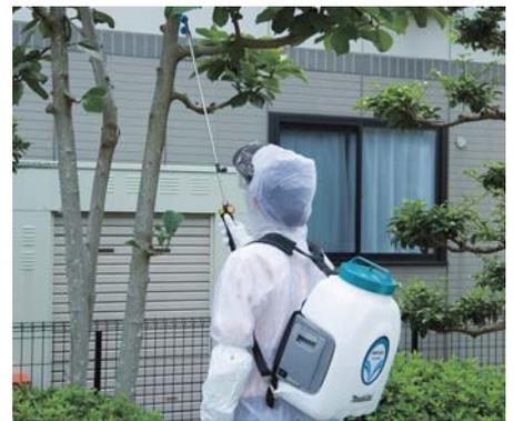
**АККУМУЛЯТОР:** съёмный Li-Ion; напряжение — 18 В; ёмкость — 3,0 А\*ч; время зарядки — 22 мин
