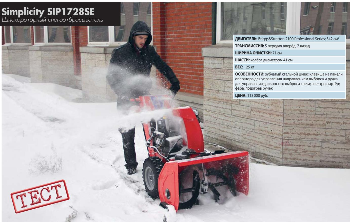
**ДВИГАТЕЛЬ:** Briggs&Stratton 2100 Professional Series; 342 см<sup>3</sup>**ТРАНСМИССИЯ:** 5 передач вперёд, 2 назад**ШИРИНА ОЧИСТКИ:** 71 см**ШАССИ:** колёса диаметром 41 см**ВЕС:** 125 кг**ОСОБЕННОСТИ:** зубчатый стальной шнек; клавиша на панели оператора для управления направлением выброса и ручка для управления дальностью выброса снега; электростартер; фара; подогрев ручек**ЦЕНА:** 113 000 руб.
