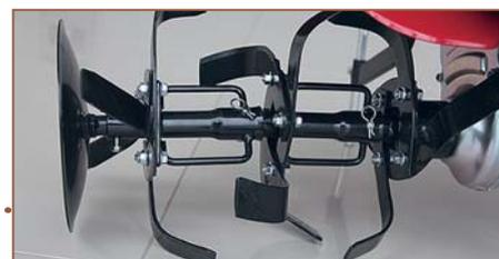
На культиваторе установлено три пары фрез. Ножи фрез крепятся на болтах, фрезы друг к другу — на пальцах с пружинными шплинтами
