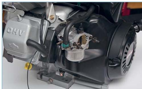
Основное отличие «зимних» двигателей: воздушного фильтра нет. Воздух забирается из-под кожуха, туда же выведена трубка сапуна. Кожух удерживается, в частности, с помощью «дистанционных» шпилек, ввёрнутых в карбюратор
