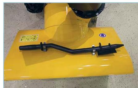
Снегоотбрасыватель укомплектован лопаткой для очистки шнека и его кожуха, закреплённой на кожухе сверху
