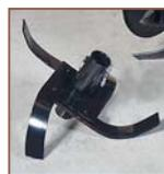
Культиватор комплектуется тремя отдельными парами фрез и защитными дисками, соединяющимися с помощью стальных пальцев с легкосъёмными шпильками. Сами фрезы неразборные, собраны на заклёпках
