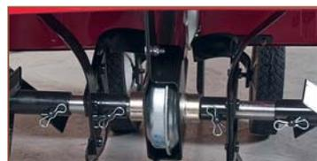
Ещё одна растяжка удерживает от ненужных перемещений и гасит вибрационное воздействие на стальной корпус редуктора
