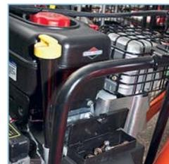
Небольшой ящичек «бардачок» между двигателем и дефлектором для хранения инструмента, запасных срезных болтов шнека и других мелочей
