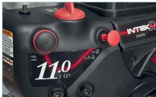
Карбюратор находится в левом верхнем углу двигателя, под кожухом. На кожух выведен праймер (подкачивающий насос) с кнопкой большого диаметра, рычаг воздушной заслонки и съёмный ключ безопасности (или зажигания)
