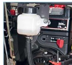
Прозрачный расширительный бачок рабочей жидкости гидростатической трансмиссии (масла) выведен наверх, для удобства контроля его уровня. У кожуха ручного стартера закреплена пара красных ключей безопасности. Перед запуском такой ключ вставляется в гнездо на кожухе двигателя
