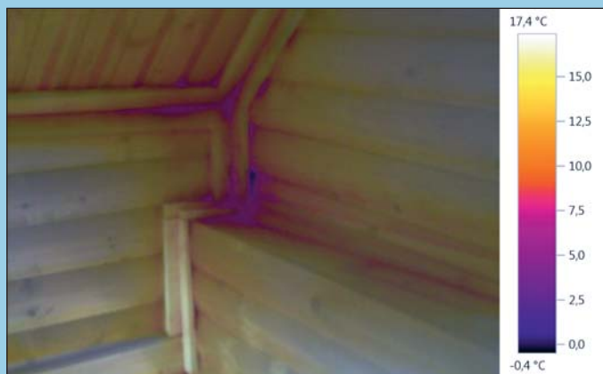
Лестничный проём. Казалось бы, не должно быть ничего криминального, однако точный прибор не так просто обмануть. Слева — снимок, сделанный тепловизором в видимом диапазоне. По сути — обычная фотография. Справа — наложение двух фотографий: обычной и снятой в ИК-диапазоне. Все огрехи как на ладони, и надо сказать, огрехи серьёзные, температура в самой холодной точке падает до -0,4\text{ }^{\circ}\text{C}
