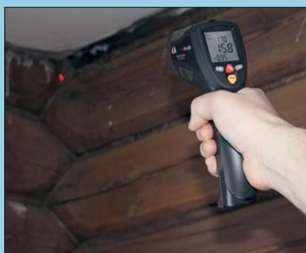
В этом углу, на стыке стен и потолка, явная проблема, хотя и не очень масштабная — заметен перепад температуры по сравнению с участком стены чуть ниже. Скорее всего, плохо проконопачена щель между двумя брёвнами
