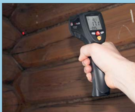
В этом углу, на стыке стен и потолка, явная проблема, хотя и не очень масштабная — заметен перепад температуры по сравнению с участком стены чуть ниже. Скорее всего, плохо проконопачена щель между двумя брёвнами
