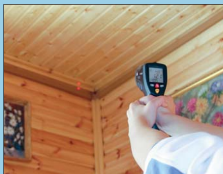
Это уже другой дом. И тут преимущество пирометра с высоким оптическим разрешением наглядно. Дыра во внутренней обшивке, через которую с улицы поступает холодный воздух, относительно мала, и прибор с меньшим разрешением показал бы менее заметный перепад температуры, измерив не только самую холодную часть обшивки, но ещё и нагретую область вокруг неё. То есть заметить проблему было бы сложнее
