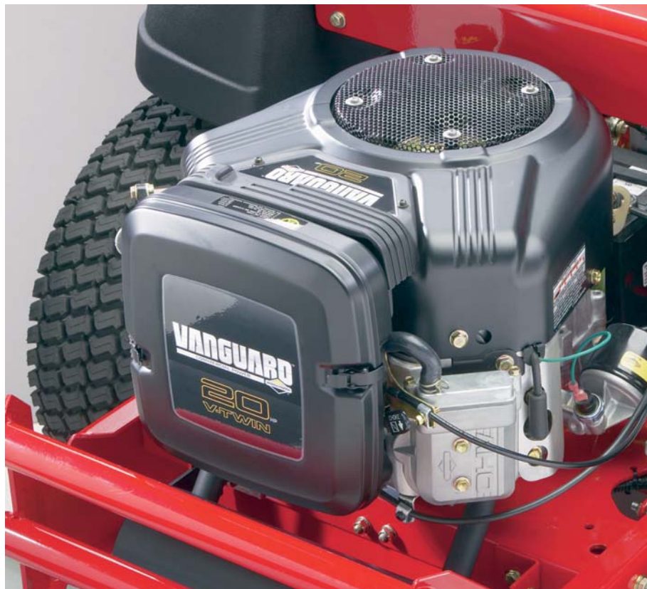
Двухцилиндровый Briggs&Stratton Vanguard, установленный на профессиональный садовый райдер
