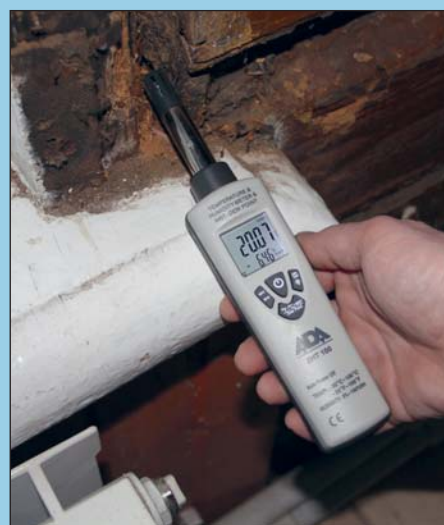
Помимо температуры, мы измеряли и относительную влажность воздуха, а также точку росы. Эта информация тоже имеет огромную практическую ценность — по этим показателям можно определить, в каком месте конденсируется влага. В день съёмки погода была сухой и морозной, поэтому температура точки росы довольно низка... но, судя по тому, что в этом месте древесина сруба основательно прогнила, именно тут скрыта одна из самых больших проблем. В более сырую погоду здесь всегда влажно за счёт конденсата, отсюда такая масштабная гниль на одном из брусьев внешней стены
