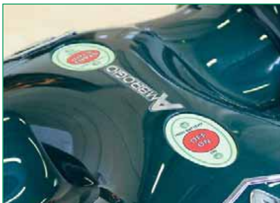
Панель управления роботом включает в себя всего две кнопки — On/Off и Start/Stop. Пожалуй, более интуитивно понятный интерфейс не придумать
