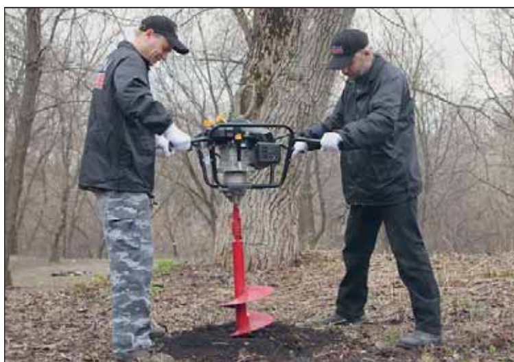
Двигатель только вращает бур. Поднимать и опускать весь агрегат вместе с налипшим на реборды грунтом, а также противостоять постоянному стремлению накрутить тебя на бур — тяжёлая физическая работа. Даже когда работают два оператора — никто не обещает, что будет легко
