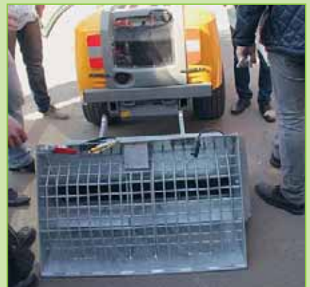
Самозагружаемый ковш с механизмом рассыпания сыпучих материалов. Устанавливается сзади, так что его можно использовать вместе с бульдозерным отвалом, одновременно и расчищая дорожки, и посыпая их песком
