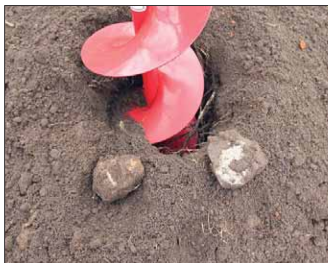
Отдельная песня — когда под бур попадает мирно хранившийся в толще грунта камень. Даже несмотря на наличие защиты в виде мощной пружины, попадание на камень может быть чревато сильным рывком рукояток
