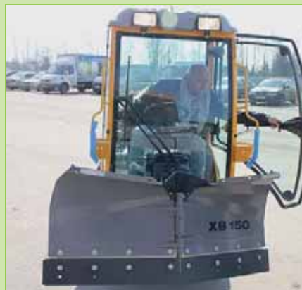
Регулируемый V-образный нож-отвал. Для России эта разновидность навески очень актуальна. Нож можно использовать и для очистки площадок, вымощенных керамической плиткой — если снять с него металлические накладки
