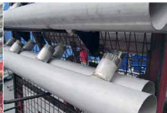
У Grundfos свой метод обработки коллекторов: на трубах, нарезанных на отрезном станке, делают отверстия, которые «растягивают» до овала, после чего металл «вытягивают», перпендикулярно трубе, создавая тем самым вокруг отверстия невысокий патрубок, к которому в дальнейшем и приваривают отвод
