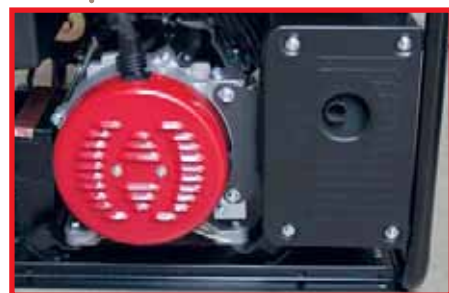
Провода, идущие от альтернатора к панели управления, убраны внутрь гофрированного изолирующего кожуха. Глушитель также размещается в стальном кожухе — для защиты от случайного касания
