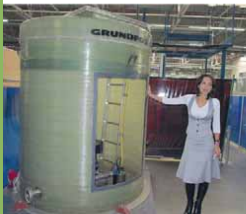
Установка повышения давления Hydro в специальном стекловолоконном корпусе
