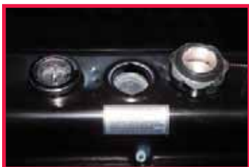
Топливный бак с предварительным сетчатым фильтром и указателем уровня топлива, градуированным, в том числе, в часах оставшейся работы
