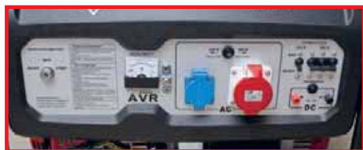
Панель управления с замком зажигания, вольтметром, клеммой для подключения заземления и силовые выходы: розетки 380 и 220 В, клеммы для подключения аккумулятора 12 В. Каждая цепь защищена отдельными предохранителями
