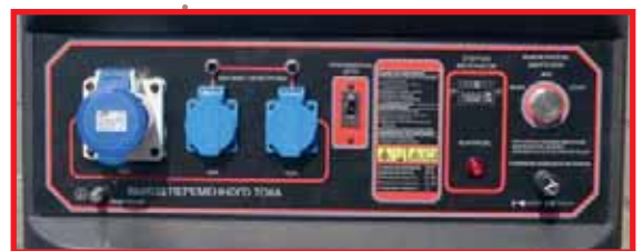
Панель управления с одним силовым выходом 220 В, 32 А — для подключения мощных потребителей, двумя выходами 16 А, счётчиком моточасов и вытяжным рычагом воздушной заслонки
