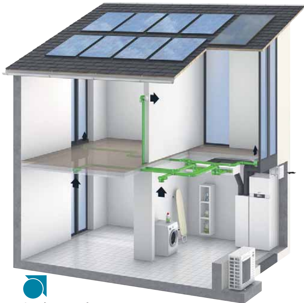
Схема движения воздушных потоков при использовании приточно-вытяжной вентиляционной установки. Фото: Viessmann
