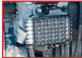
На мощных станциях устанавливаются более сложные двигатели, чем на небольших. Основное отличие — система смазки под давлением, включающая сменный масляный фильтр и радиатор для охлаждения масла
