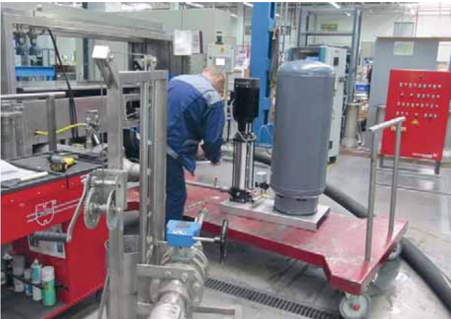
Собранная готовая продукция полностью проверяется на специальных установках, которые имитируют работу насосов в реальных условиях (подаётся вода, замеряется давление и т. д.)
