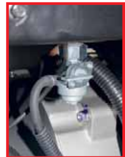
Топливный кран с отстойником. Кстати, все топливные трубки и электропроводка на станции дополнительно защищены гофрированными пластиковыми трубками
