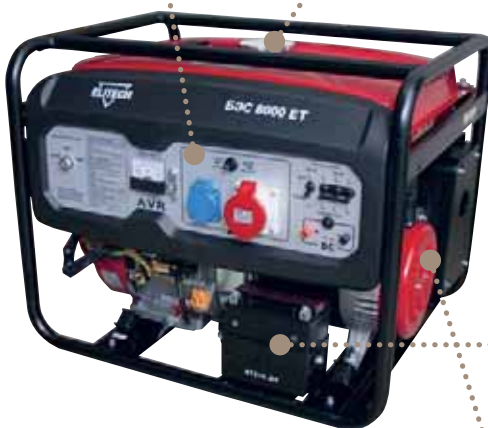
Панель управления с замком зажигания, вольтметром, клеммой для подключения заземления и силовые выходы: розетки 380 и 220 В, клеммы для подключения аккумулятора 12 В. Каждая цепь защищена отдельными предохранителями
