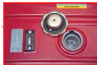
Большой топливный бак, «накрывающий» генератор сверху, снабжён пластиковым фильтром предварительной очистки топлива и имеет указатель уровня топлива
