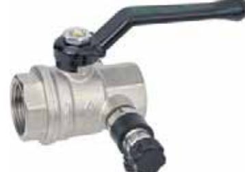
Кран шаровый латунный полнопроходной, со сливным клапаном, резьбы внутренняя — внутренняя по ISO 228/1. Серия Oregon Pro, артикул 330 Pro
