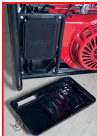
Воздух, поступающий в двигатель, сначала проходит через лабиринтный воздушный канал в корпусе воздушного фильтра, а затем — через сам поролоновый фильтр
