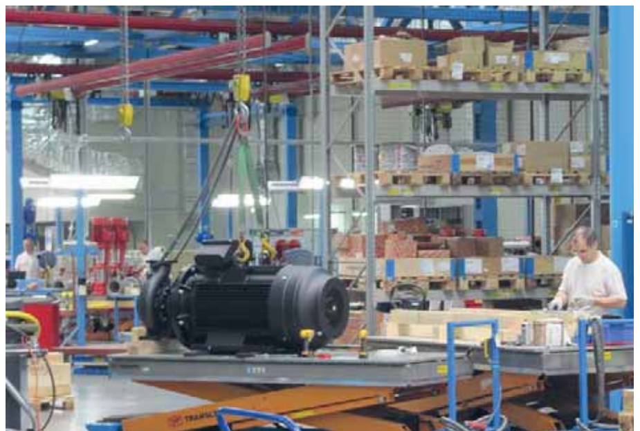
Участок сборки вертикальных одноступенчатых центробежных насосов TP мощностью до 350 кВт
