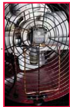
Топливный насос установлен на валу двигателя вентилятора. Снизу к нему подходят трубки подачи топлива (с фильтром) и «обратки», по третьей трубке топливо направляется к форсунке горелки
