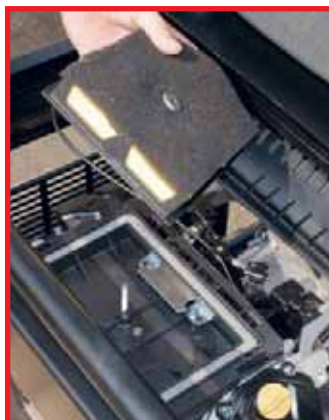
Двухступенчатый воздушный фильтр: поролон для предварительной очистки и гофрированная бумага. По некоторым особенностям двигатель напоминает автомобильный: крышка для заливки масла находится на клапанной крышке, имеется расположенный отдельно щуп для контроля масла
