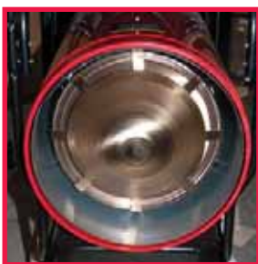
Горелка, камера сгорания и другие элементы, соприкасающиеся с горячим воздухом, изготовлены из нержавеющей стали. Нагнетаемый вентилятором воздух выходит из корпуса с большой скоростью спереди, через кольцевую щель
