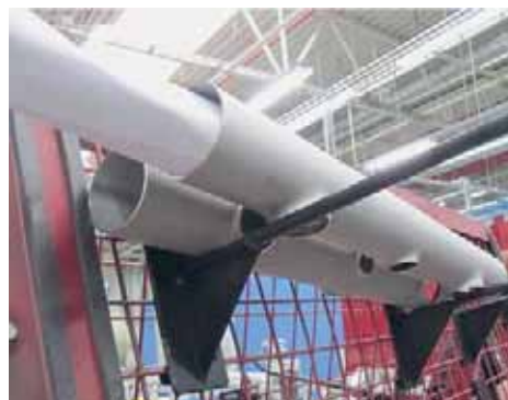
У Grundfos свой метод обработки коллекторов: на трубах, нарезанных на отрезном станке, делают отверстия, которые «растягивают» до овала, после чего металл «вытягивают», перпендикулярно трубе, создавая тем самым вокруг отверстия невысокий патрубок, к которому в дальнейшем и приваривают отвод
