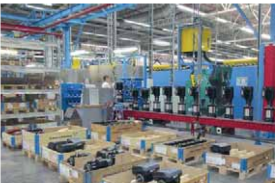
Самое первое помещение, которое было открыто на заводе в 2005 году, — участок по сборке малых, средних и больших вертикальных многоступенчатых насосов CR
