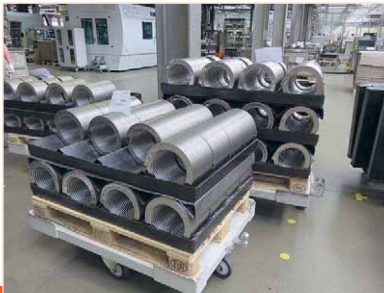
Только Viessmann имеет право делать теплообменники из стальной трубы прямоугольного сечения
