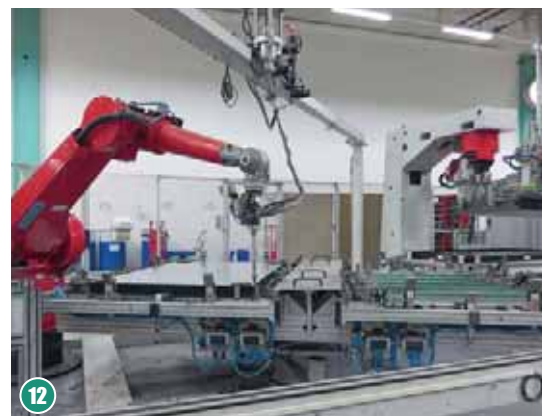
Пространство между стеклом и рамой заполняется герметиком. А на соседнем месте уже появляется новая рама с абсорбером, для которого другой робот готовит новое стекло
