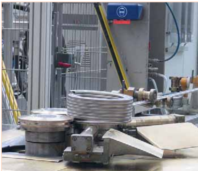
Только Viessmann имеет право делать теплообменники из стальной трубы прямоугольного сечения
