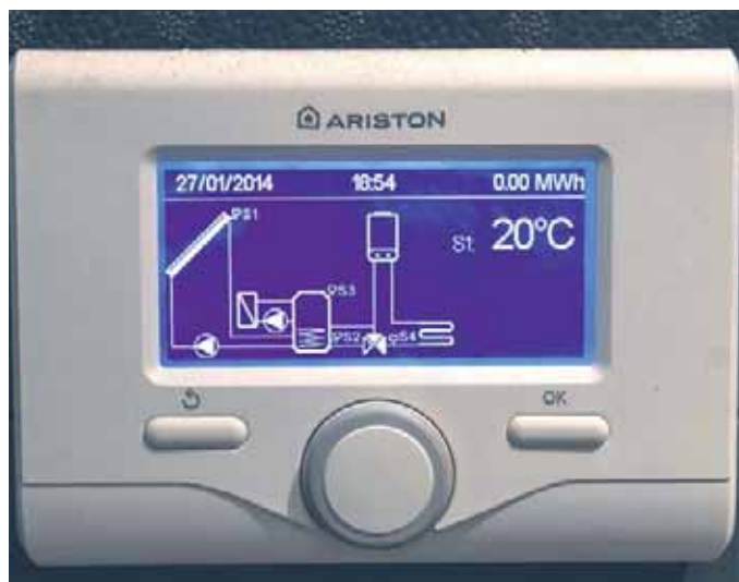
Пульт управления системой Ariston Sensys: минимум кнопок и регуляторов и большой дисплей, на котором отображаются выбранные параметры и прочие данные, например эффективность гелиоконтуров (система оборудована счётчиком «солнечного» тепла)
