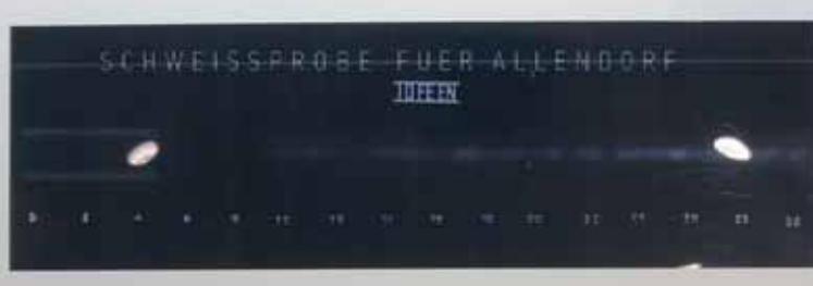
Образец листа со сварочным швом котла Vitomax. На рентгеновской плёнке видно — есть брак или нет
