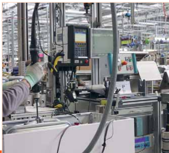
Монтажная станция для сборки котлов Vitodens100
