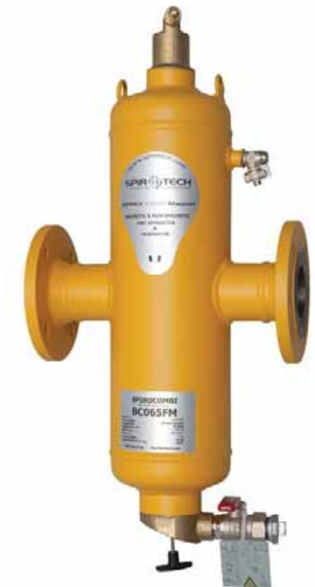
SpiroCombi Magnet со встроенным магнитом предназначен для удаления шлама и воздуха в крупных системах. Подвижный механизм с рукояткой внизу колбы позволяет быстро опустить собранный магнитом шлам на дно, а сливной кран — удалить загрязнения
