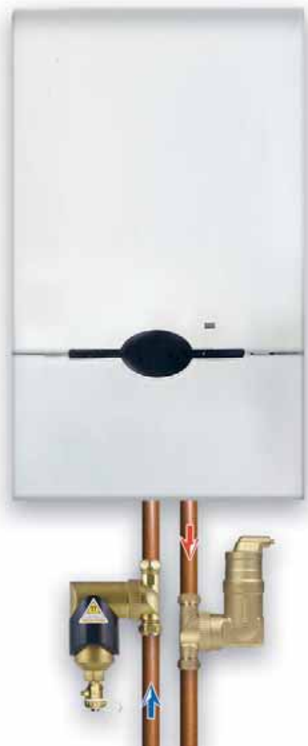
Деаэраторы SpiroVent устанавливают на выходе из котла, в наиболее горячей точке контура, где удаление пузырьков самое эффективное. Сепараторы SpiroTrap монтируют в конце контура, чтобы защитить котёл от шлама
