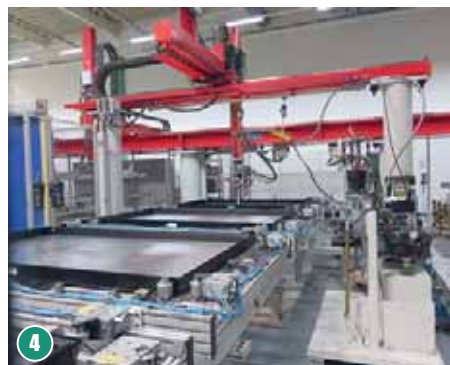
В раму с герметиком помещается алюминиевая пластина — задняя стенка коллектора. Время застывания герметика — 5 минут, после чего конструкция становится монолитной
