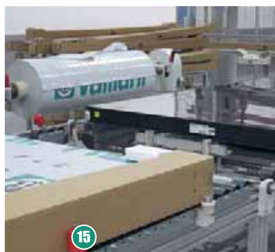
С поверхности рамы рабочие удаляют остатки герметика, на стекло накладывают специальную плёнку. Её снимет монтажная бригада уже после установки солнечного коллектора на крыше дома покупателя
