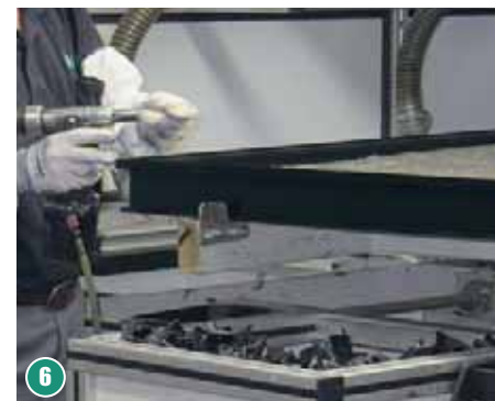
В нижний настил коллектора укладывается слой минеральной ваты, затем приворачиваются зажимные профили для дальнейшего монтажа панели на крышу (здесь используется ручной труд)
