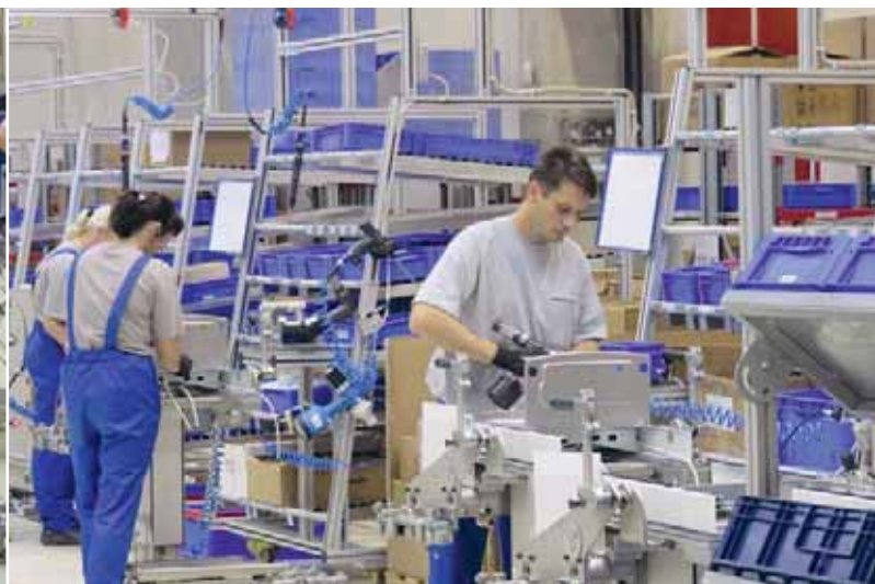
Сборка конвейерного типа — тележка с основанием будущего котла от одной монтажной станции передаётся к другой, и на каждом этапе происходит присоединение того или иного узла
