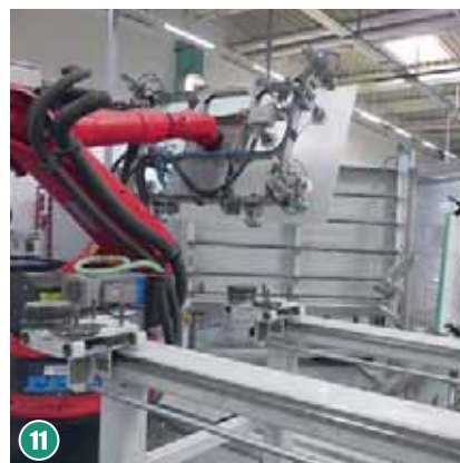
Движения робота отточены — он берёт стекло, помещает его над абсорбером и сверху прижимает специальными весами. Панель со стеклом передвигается на станцию с роботом-герметизатором. Тщательная герметизация исключает попадание влаги и возможное запотевание коллектора во время эксплуатации
