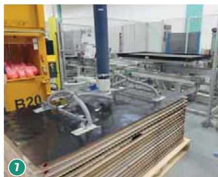
И наконец, монтаж самой главной составляющей — фирменного абсорбера с высокоселективным покрытием. Тепло от абсорбера передаётся системе медных трубок, а от них — теплоносителю. Слой качественной теплоизоляции минимизирует утечки тепла через корпус
