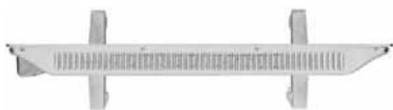
Модель работает по принципу естественной конвекции: холодный воздух затягивается в корпус снизу, проходит через ТЭН и, уже нагретый, покидает конвектор через верхнюю воздухораспределительную решётку
