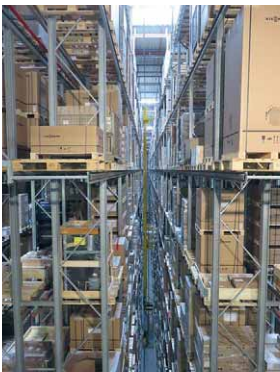
В автоматизированном логистическом центре работают только машины. Робот-погрузчик движется во все четыре стороны. За день он совершает примерно 10 000 операций
