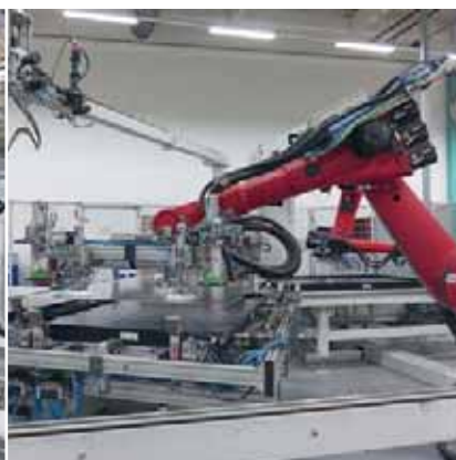
Движения робота отточены — он берёт стекло, помещает его над абсорбером и сверху прижимает специальными весами. Панель со стеклом передвигается на станцию с роботом-герметизатором. Тщательная герметизация исключает попадание влаги и возможное запотевание коллектора во время эксплуатации
