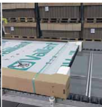
С поверхности рамы рабочие удаляют остатки герметика, на стекло накладывают специальную плёнку. Её снимет монтажная бригада уже после установки солнечного коллектора на крыше дома покупателя
