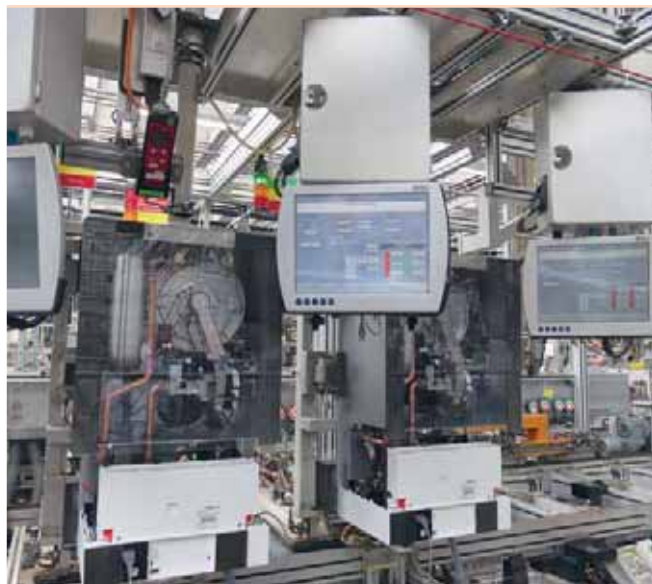
на испытательном стенде. Вся готовая продукция на заводе проходит тепловые тесты перед отгрузкой на склад
