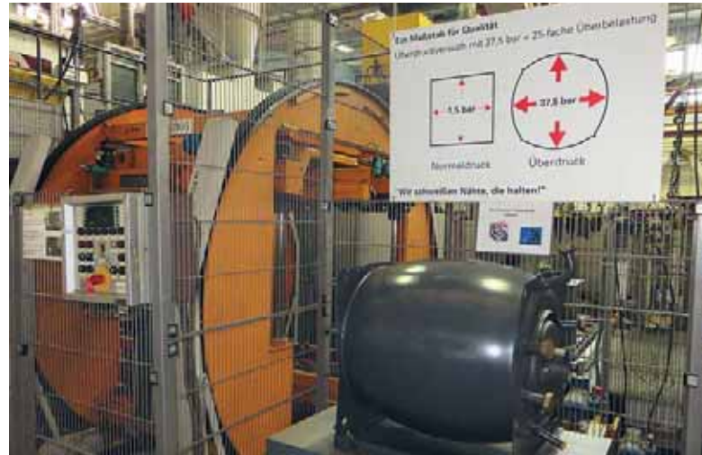
Чтобы доказать надёжность сварных швов, в ходе испытаний к котлу Viessmann подали давление не 1,5 бара (как положено), а 37,5 бара (с превышением в 25 раз). Швы выдержали, а котёл приобрел форму «пивного бочонка»
