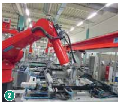
Первый робот собирает раму коллектора. Конструкция сваривается и герметизируется. Рама с застывающим герметиком уезжает по конвейеру, а робот уже приступает к сбору новой рамки
