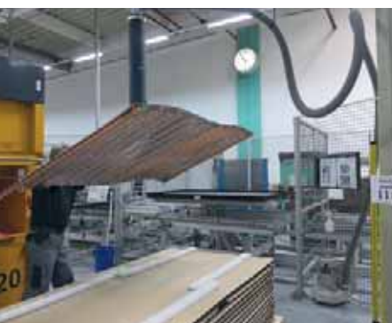
И наконец, монтаж самой главной составляющей — фирменного абсорбера с высокоселективным покрытием. Тепло от абсорбера передаётся системе медных трубок, а от них — теплоносителю. Слой качественной теплоизоляции минимизирует утечки тепла через корпус
