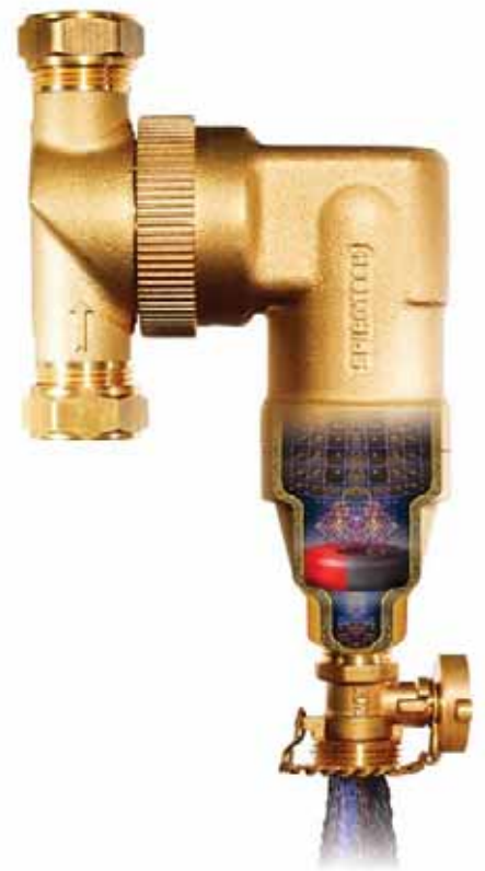
Для повышения эффективности сепарации шлама в моделях SpiroTrap MB2 и MB3 применяют магниты, которые воздействуют на частицы магнитной природы
