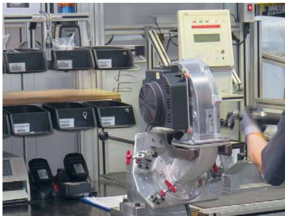
Монтажная станция по сборке напольных конденсационных котлов Vaillant большой мощности (80–280 кВт)
