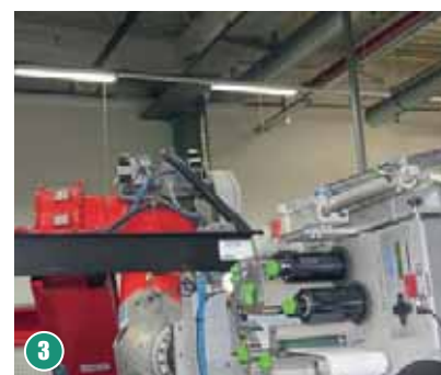
Одновременно другой робот подготавливает сварные элементы и наклеивает на них шильд Vaillant. Сварная рама придаёт конструкции жёсткость
