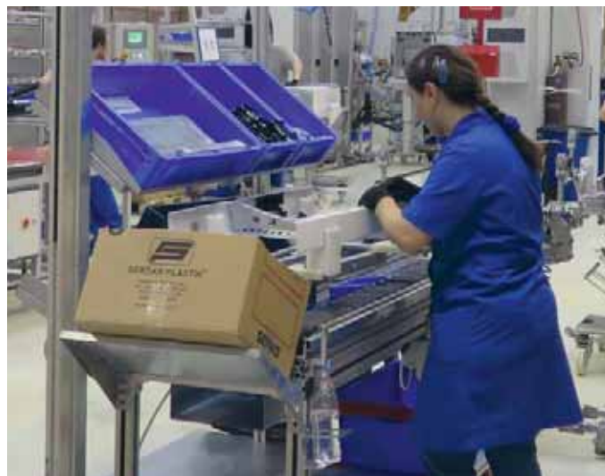
Сборка конвейерного типа — тележка с основанием будущего котла от одной монтажной станции передаётся к другой, и на каждом этапе происходит присоединение того или иного узла
